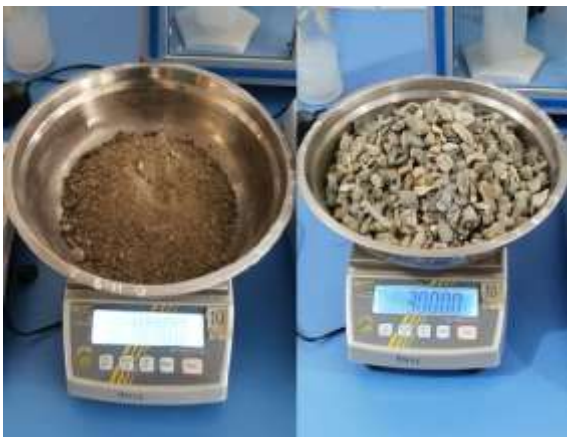
Foto 5. Determinación de la masa de los agregados antes de secar
