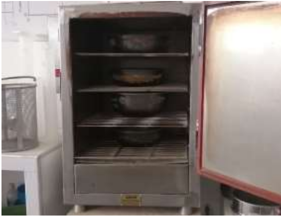
Foto 17. Secado de la muestra en el horno
