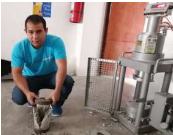
Foto 59. Testigo cilíndrico ensayado
