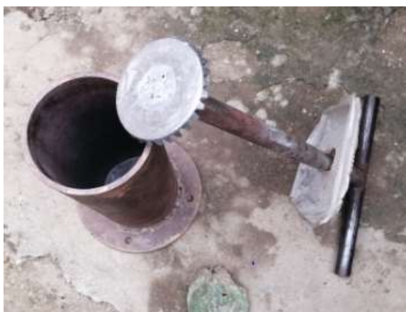
Foto 1. Equipo artesanal para reducir el tamaño de las partículas de vidrio
