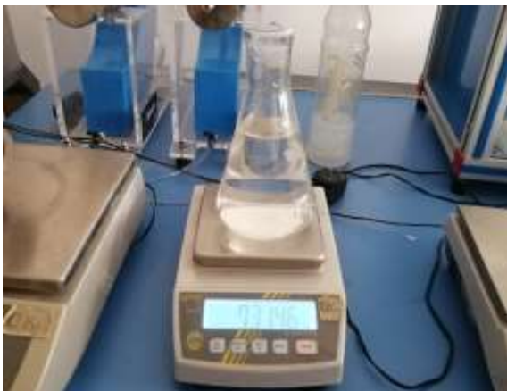
Foto 15. Peso del picnómetro con 500 ml de agua
