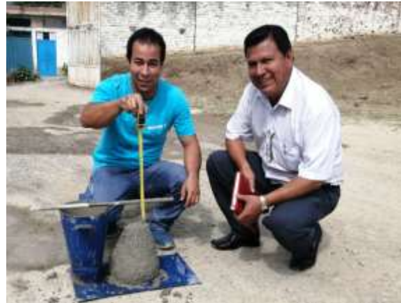
Foto 40. Medida del asentamiento
