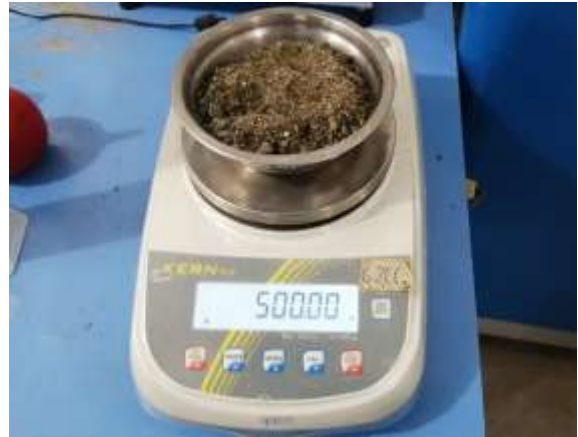
Foto 14. Pesado de la muestra saturada con superficie seca (SSS)
