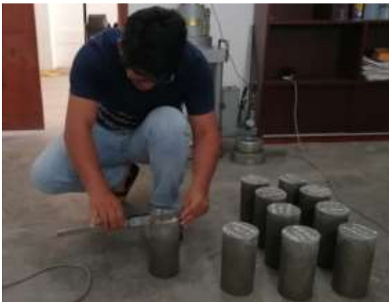
Foto 55. Medida de los radios de las probetas
