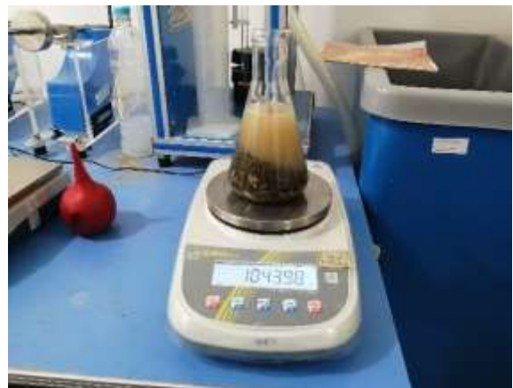
Foto 16. Peso del picnómetro más muestra saturada con superficie seca
