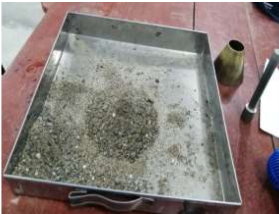
Foto 13. Prueba para determinar la humedad superficial
