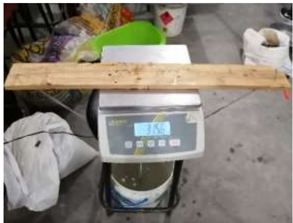
Foto 22. Determinación del peso de la muestra sumergido en agua
