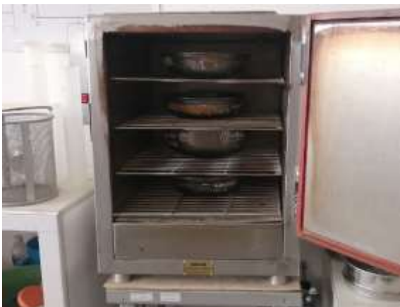
Foto 23. Secado de la muestra en el horno
