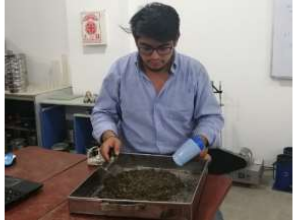
Foto 12. Secado del agregado fino por medio de secadora
