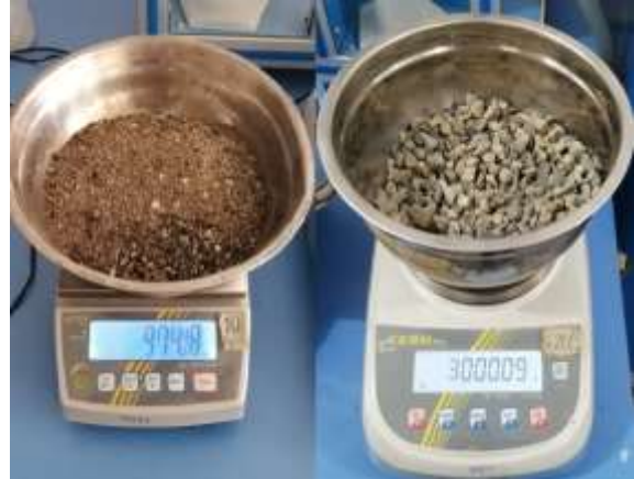
Foto 8. Peso seco de las muestras para análisis granulométrico
