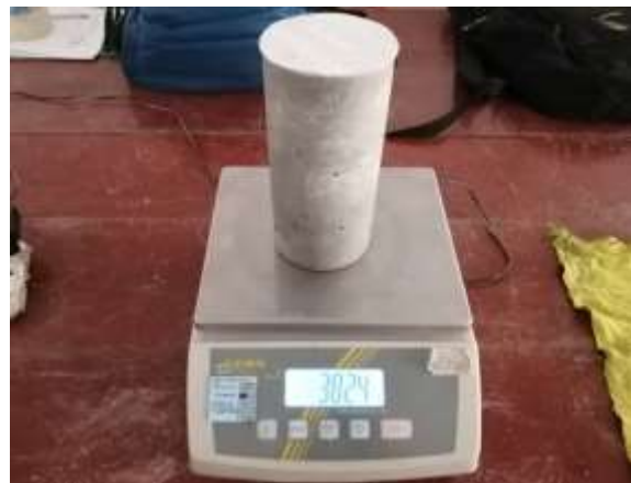
Foto 56. Peso del concreto en estado endurecido
