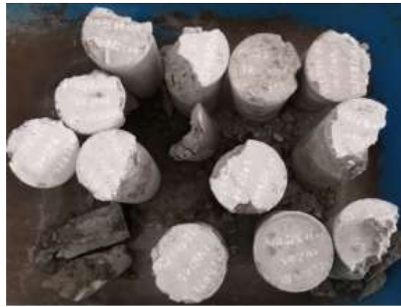
Foto 60. Testigos cilíndricos después de ser ensayados
