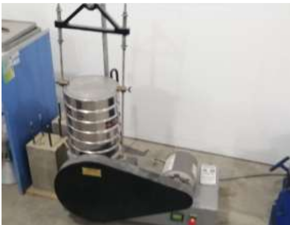
Foto 9. Tamizado mecánico de los agregados
