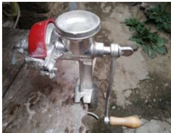
Foto 2. Molino mecánico para el pulverizado de vidrio
