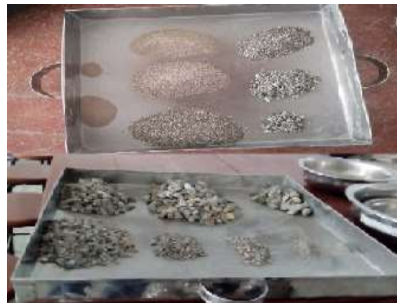
Foto 10. Agregados después de ser tamizados y pesados
