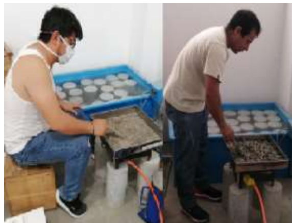
Foto 6. Secado de la muestra de agregados en cocina
