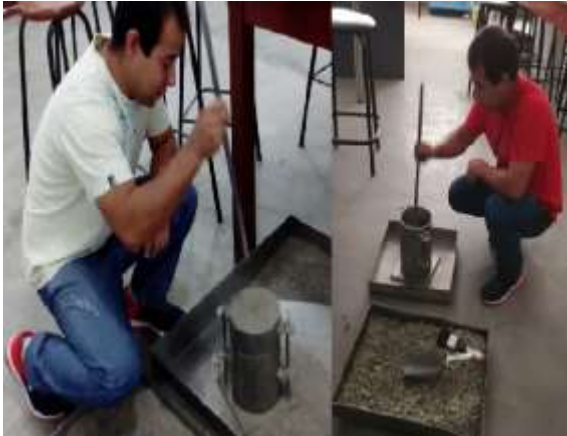
Foto 29. Compactado del agregado por capas
