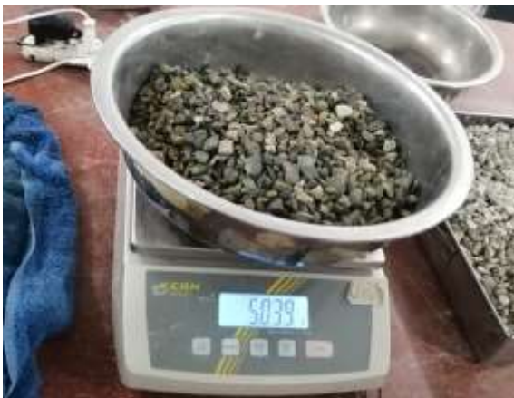
Foto 21. Pesado de la muestra saturada con superficie seca (SSS)
