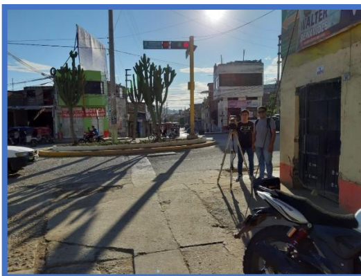
Figura N° 29: Levantamiento topográfico de la avenida Mesones Muro, haciendo uso de Estación total.
