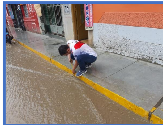
Figura N° 35: Calibración en campo y aforo de caudal de la escorrentía superficial en la calle Junín cuadra N°1 y la avenida Mesones Muro
