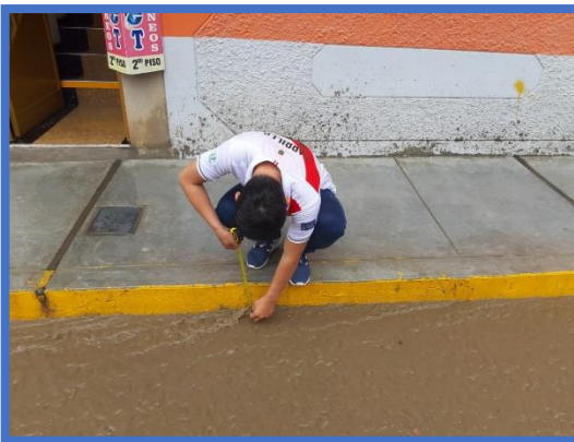
Figura N° 35: Calibración en campo y aforo de caudal de la escorrentía superficial en la calle Junín cuadra N°1 y la avenida Mesones Muro
