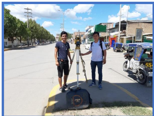
Figura N° 29: Levantamiento topográfico de la avenida Mesones Muro, haciendo uso de Estación total.
