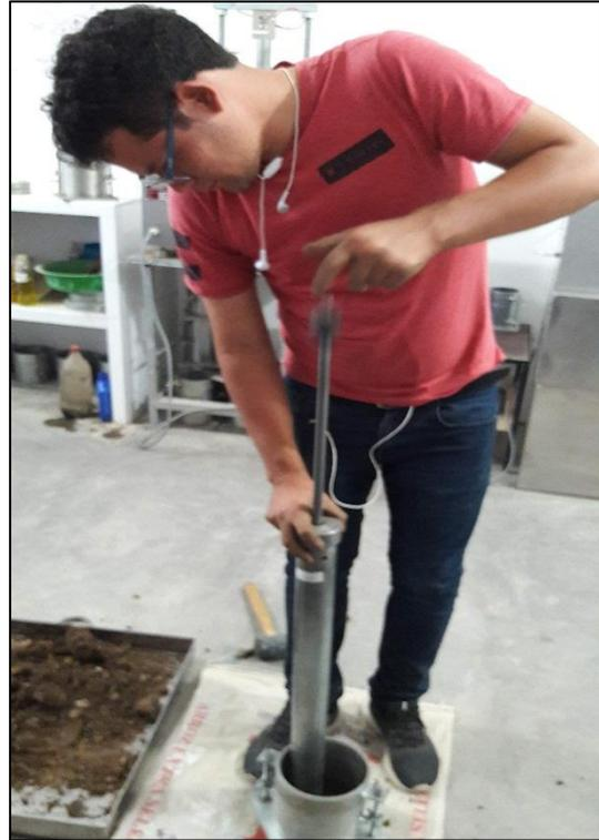
*Imagen 46 e Imagen 47: Ensayos para clasificación del suelo y obtención del CBR.*
