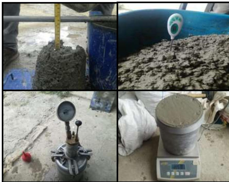
Figura 15. Ensayos al concreto fresco
