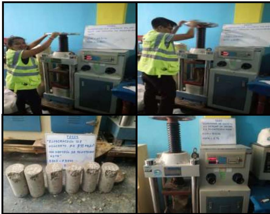
Figura 17. Ensayo a compresión de testigos cilíndricos
