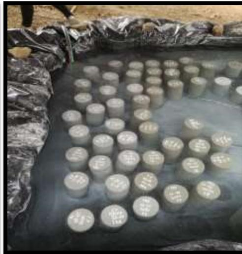
**ELABORACIÓN Y CURADO DE LOS TESTIGOS DE CONCRETO**
