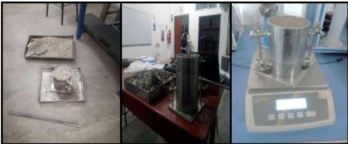
Figura 13. Ensayo de Peso unitario suelto y compactado de AG Y AF
