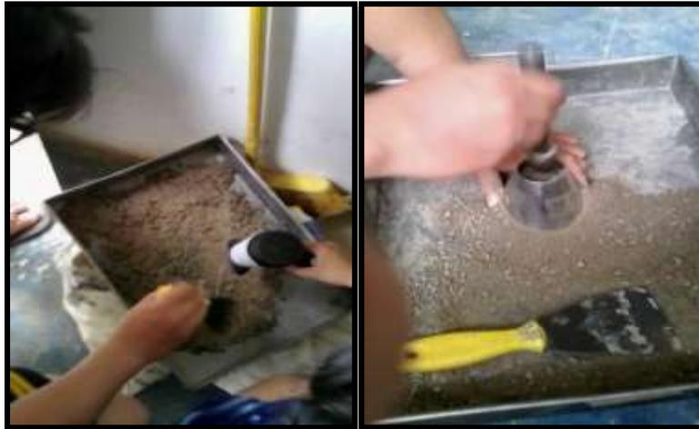
Figura 12. Ensayo de peso específico y porcentaje de absorción de los agregados
