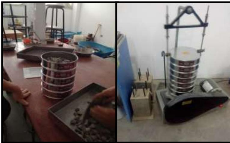
Figura 11. Ensayo de análisis granulométrico
