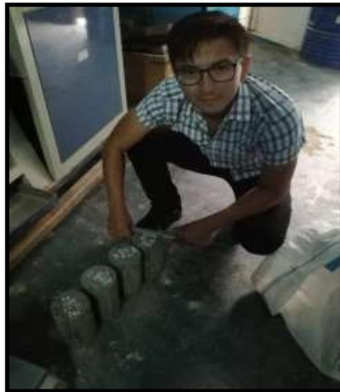
**TOMA DE DIMENSIONES DEL DIAMETRO DE LOS TESTIGOS DE CONCRETO**
