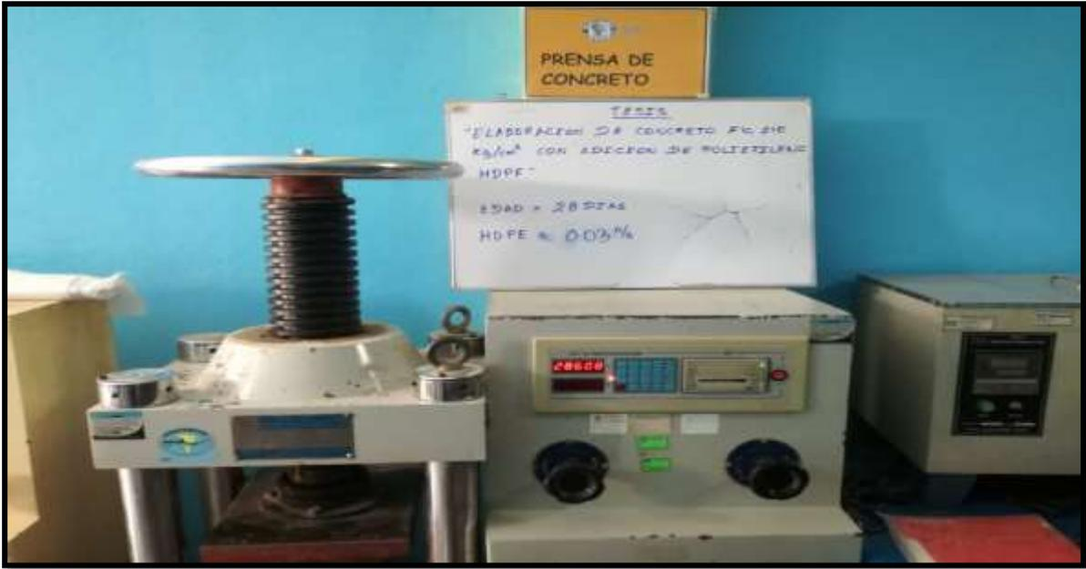
**ENSAYO DE RESISTENCIA A COMPRESIÓN DEL CONCRETO**
