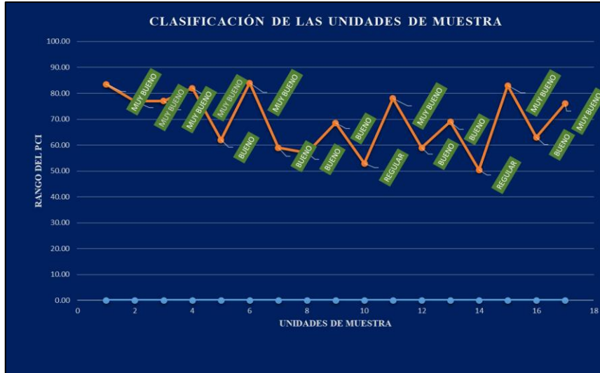
Figura 33. Variación del PCI en las unidades de muestra en el pavimento rígido.
