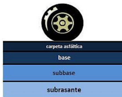
Figura 1. Estructura del pavimento flexible.
