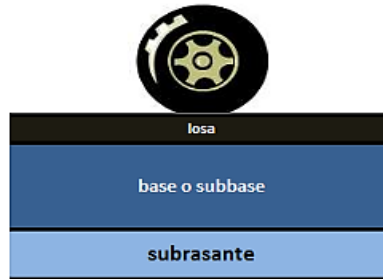
Figura 2. Estructura del pavimento rígido.
