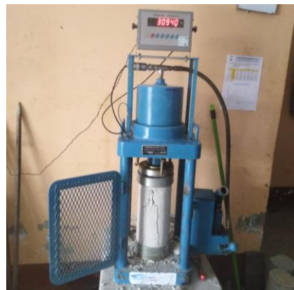
Figura 75. Rotura de testigos de concreto obra 04.
