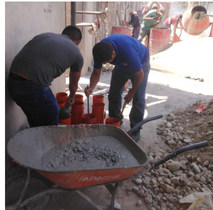
Figura 73. Testigos de concreto con aditivo obra 04
