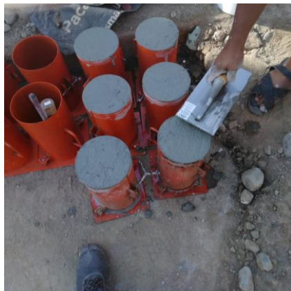
Figura 54. Testigos de concreto sin aditivo obra 01
