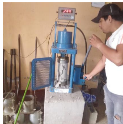
Figura 57. 01Rotura de testigos de concreto obra 01
