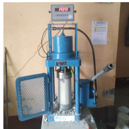
Figura 69. Rotura de testigos de concreto obra 03.
