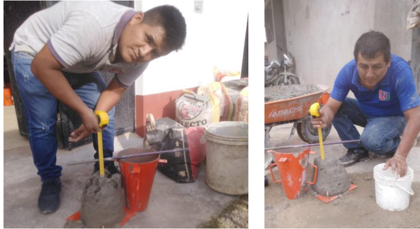
Figura 13. Figura 14. Ensayo de asentamiento del concreto elaborado sin aditivo.
