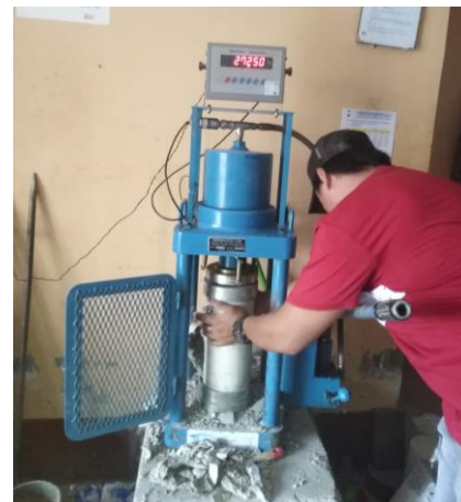
Figura 27. Figura 28. Rotura de testigos de concreto elaborado con aditivo Sikacem plastificante en polvo (edad = 7 días)
