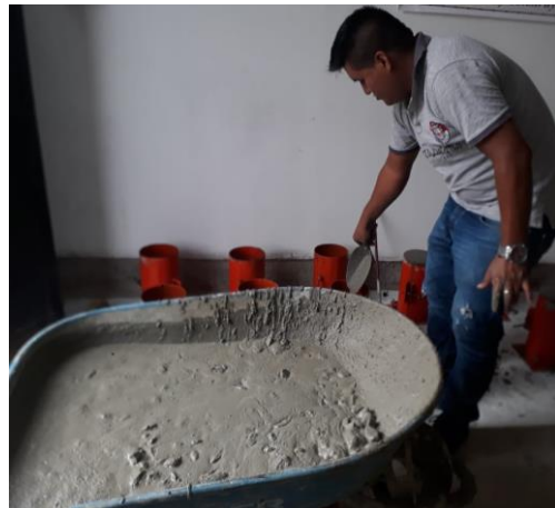
Figura 11. Figura 12. Extracción de muestras de concreto elaborado con aditivo SikaCem plastificante en polvo.
