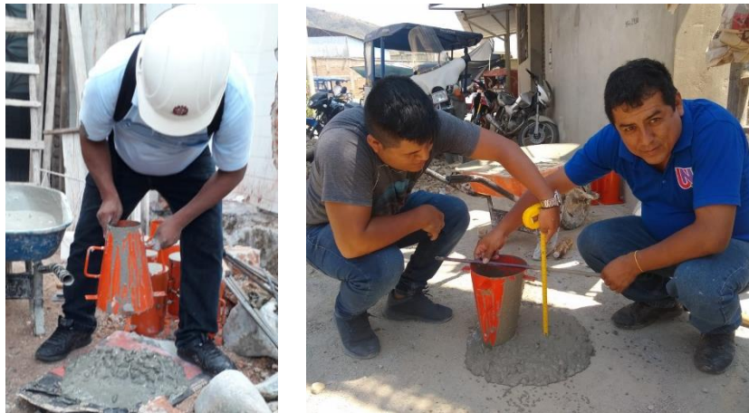
Figura 15. Figura 16. Ensayo de asentamiento del concreto elaborado con aditivo SikaCem plastificante en polvo.
