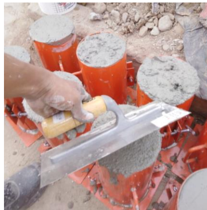
Figura 55. Testigos de concreto con aditivo obra 01
