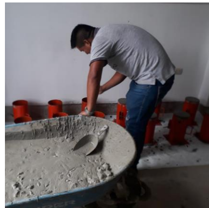
Figura 78. Testigos de concreto con aditivo obra 05
