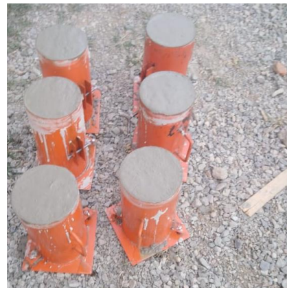
Figura 61. Testigos de concreto con aditivo obra 02
