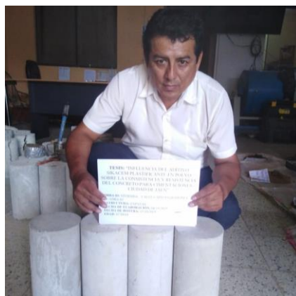
Figura 81. Testigos de concreto en laboratorio obra 05.
