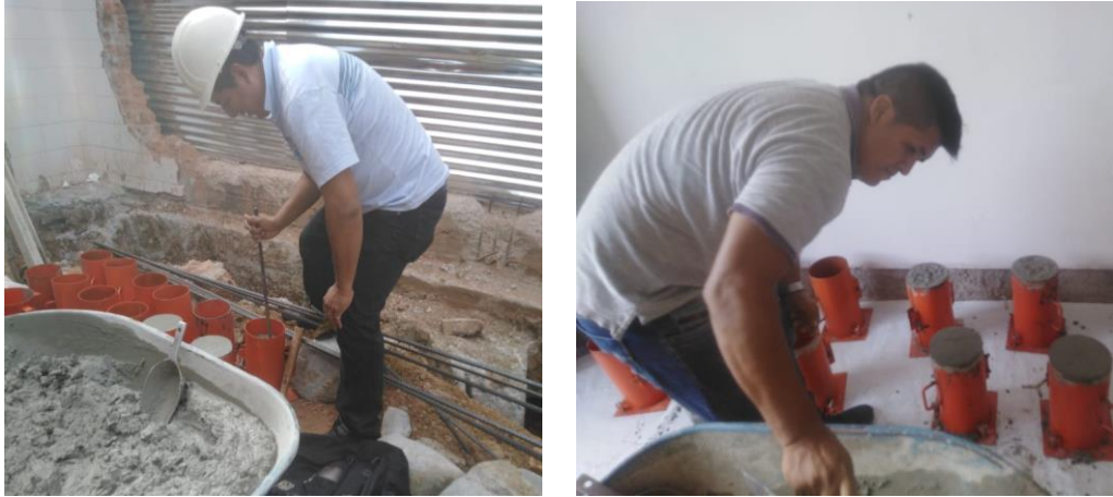
Figura 17. Figura 18. Elaboración de testigos de concreto sin aditivo.
