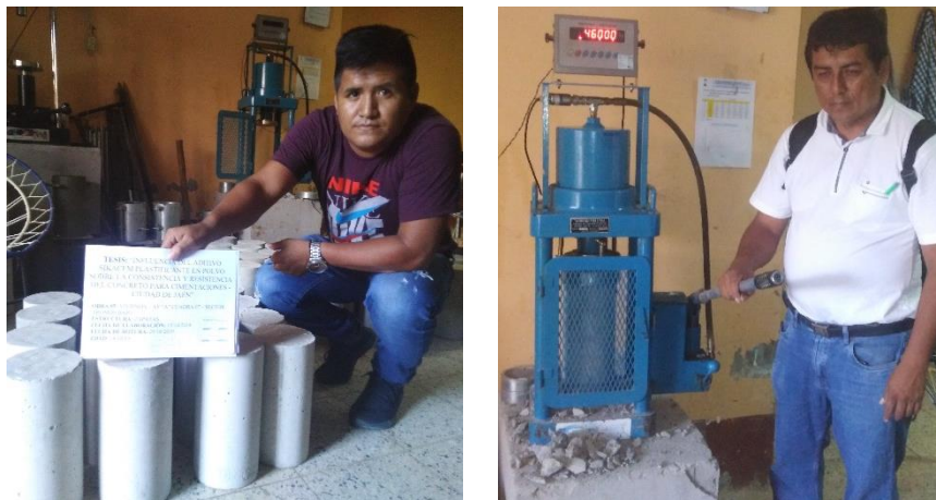
Figura 31. Figura 32. Rotura de testigos de concreto elaborado con aditivo Sikacem plastificante en polvo (edad = 14 días)
