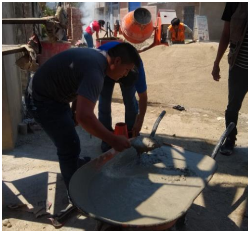
Figura 11. Figura 12. Extracción de muestras de concreto elaborado con aditivo SikaCem plastificante en polvo.
