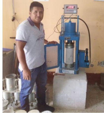
Figura 25. Figura 26. Rotura de testigos de concreto elaborado sin aditivo (edad = 7 días)
