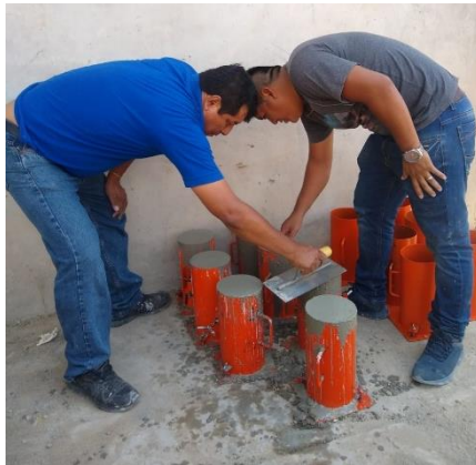
Figura 72. Testigos de concreto sin aditivo obra 04
