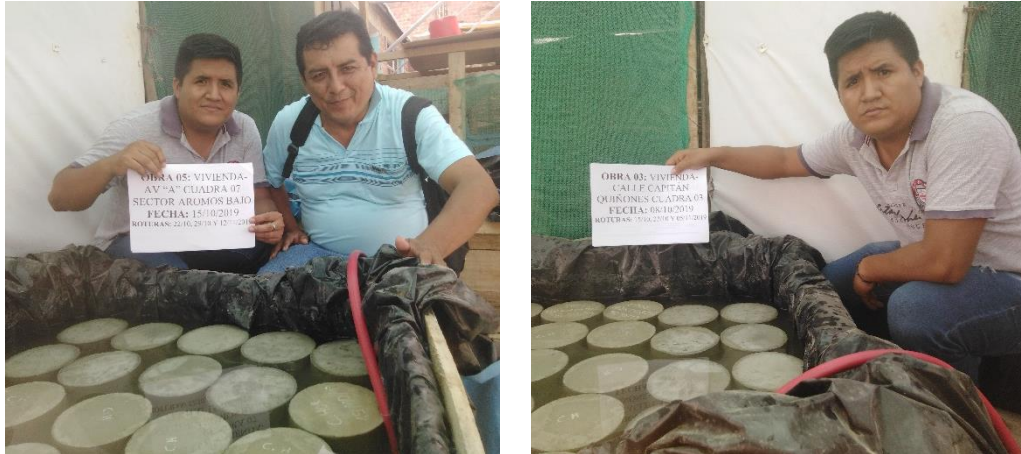
Figura 21. Figura 22. Curado de testigos de concreto elaborado sin aditivo
