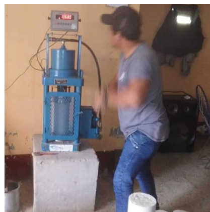
Figura 63. Rotura de testigos de concreto obra 02.
