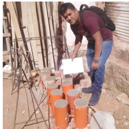
Figura 67. Testigos de concreto con aditivo obra 03
