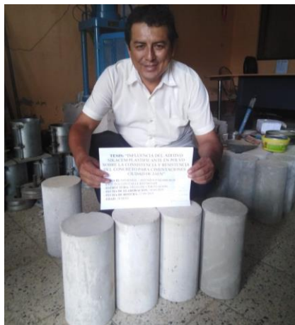
Figura 35. Figura 36. Rotura de testigos de concreto elaborado con aditivo Sikacem plastificante en polvo (edad = 28 días)
