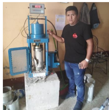
Figura 80. Rotura de testigos de concreto obra 05.
