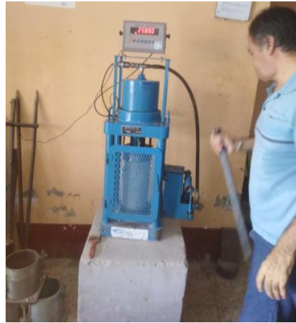
Figura 33. Figura 34. Rotura de testigos de concreto elaborado sin aditivo (edad = 28 días)
