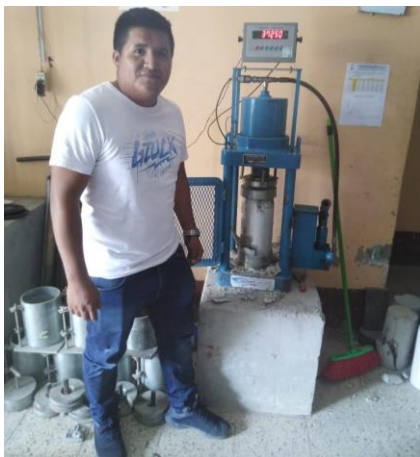
Figura 27. Figura 28. Rotura de testigos de concreto elaborado con aditivo Sikacem plastificante en polvo (edad = 7 días)
