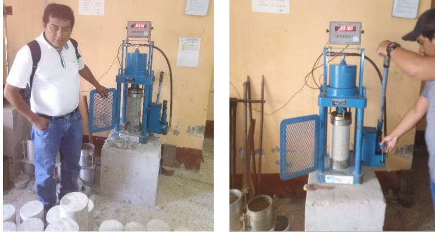
Figura 29. Figura 30. Rotura de testigos de concreto elaborado sin aditivo (edad = 14 días)
