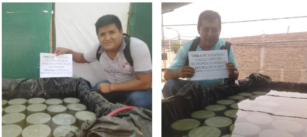
Figura 23. Figura 24. Curado de testigos de concreto elaborado con aditivo.
