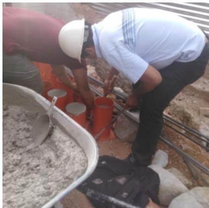
Figura 66. Testigos de concreto sin aditivo obra 03
