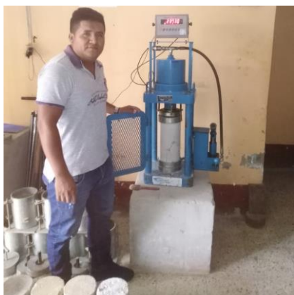
Figura 62. Testigos de concreto en laboratorio obra 02
