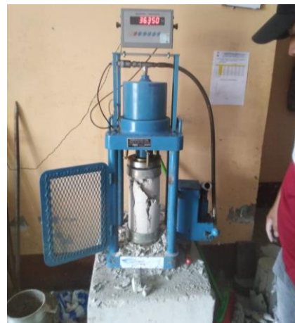
Figura 35. Figura 36. Rotura de testigos de concreto elaborado con aditivo Sikacem plastificante en polvo (edad = 28 días)
