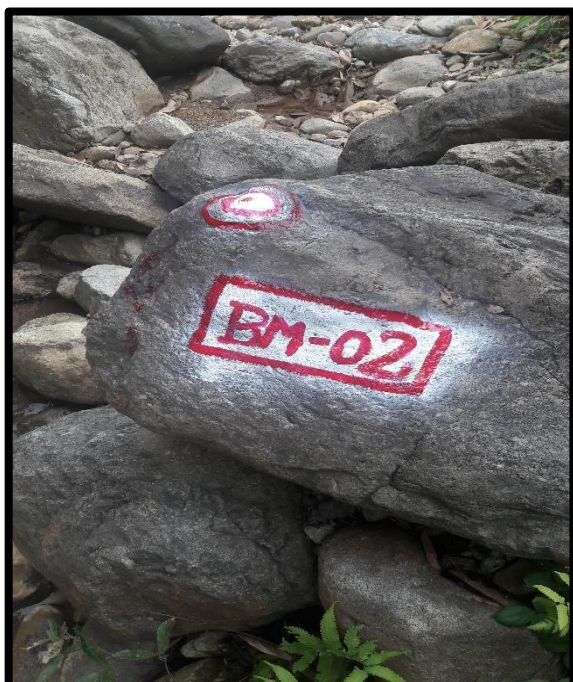
FOTO 2: SE MUESTRA EL LEVANTAMIENTO TOPOGRÁFICO DE LA QUEBRADA BOMBOCA Y EL PUNTO DE REFERENCIACIÓN (BM- 2).
