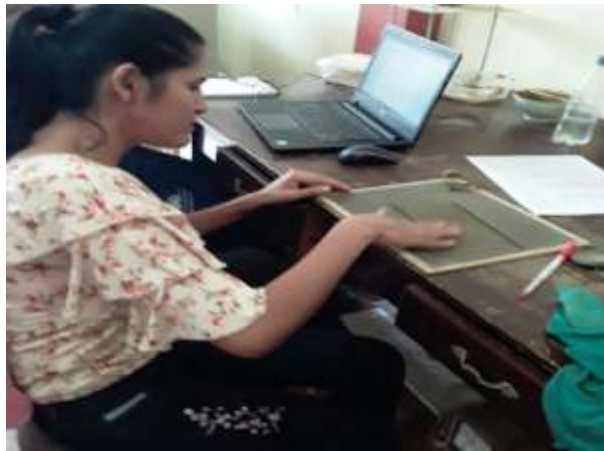
Figura 17: Enrolado de muestra para Límite plástico.
