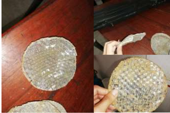
Figura 33: Efecto del ensayo de penetración en geosintético.
