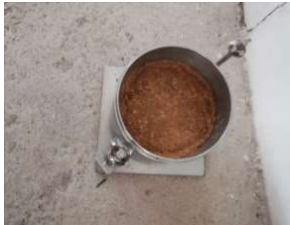
Figura 31: Molde de CBR de suelo natural.
