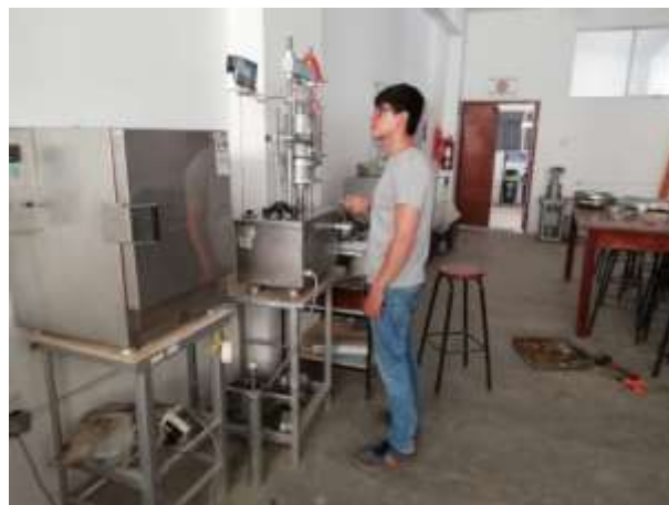
Figura 29: Toma de lectura de penetración.
