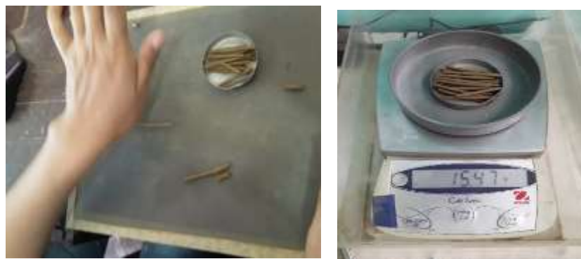
Figura 18: Rollos para límite plástico.
