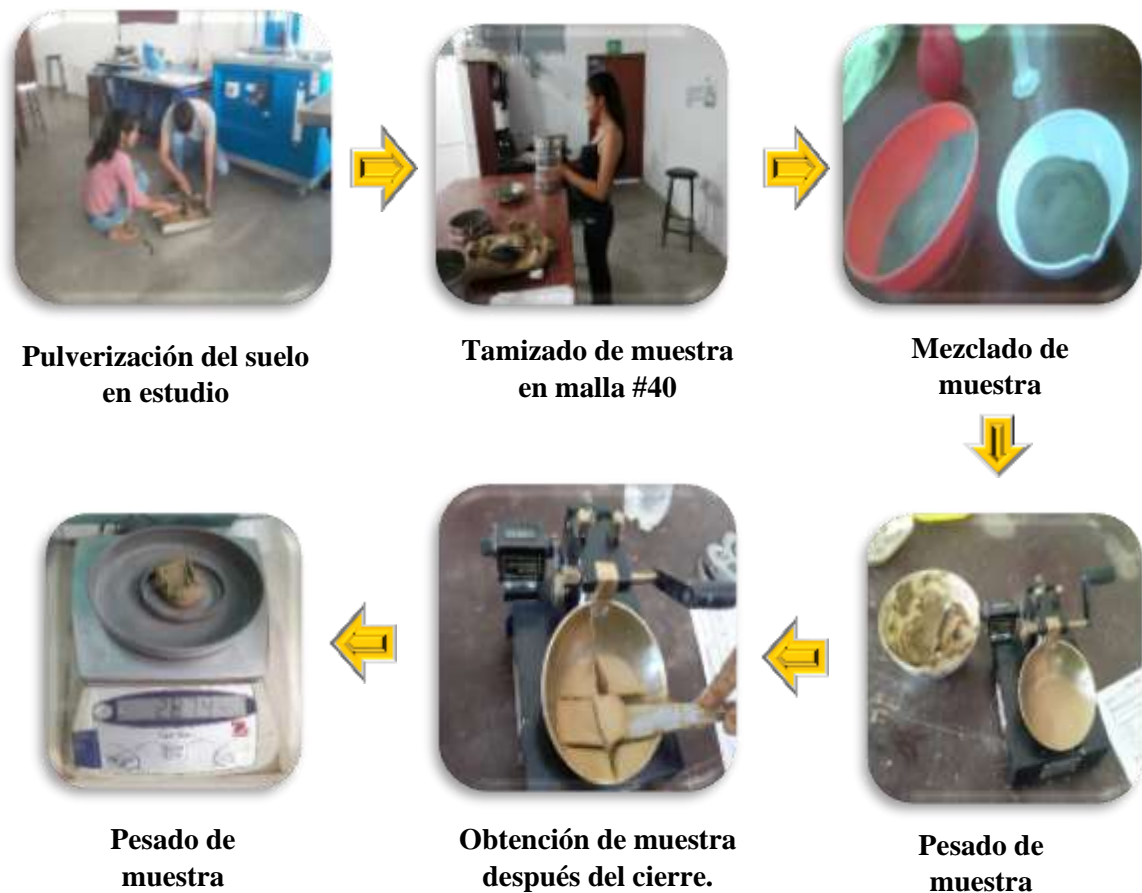
Figura 16: Procedimiento de límite líquido.
