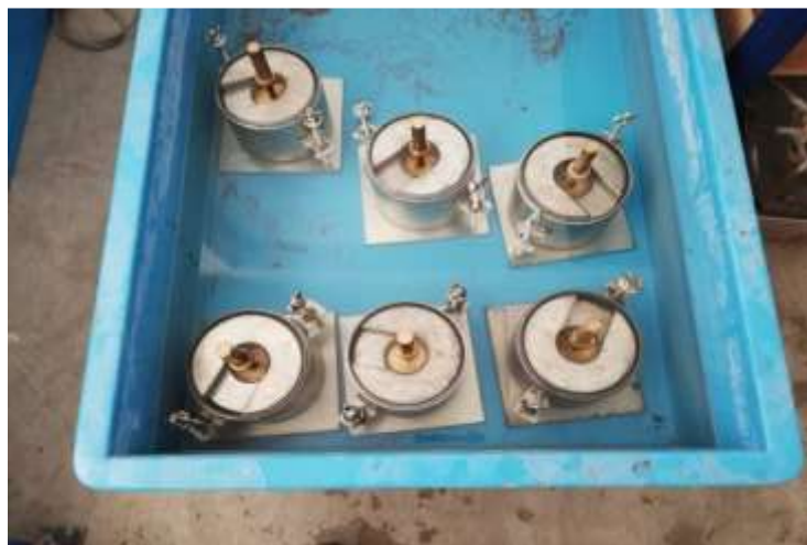
Figura 27: Inmersión de moldes de CBR en agua.
