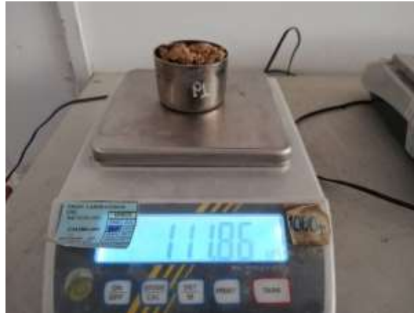
Figura 30: Muestra de humedad saturada de CBR.
