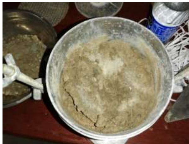
Figura 32: Molde de CBR de suelo natural más geosintético.
