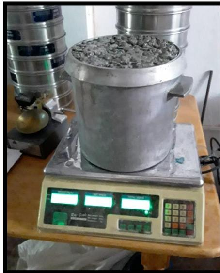
*Figura N° 21.* Peso unitario del concreto fresco
