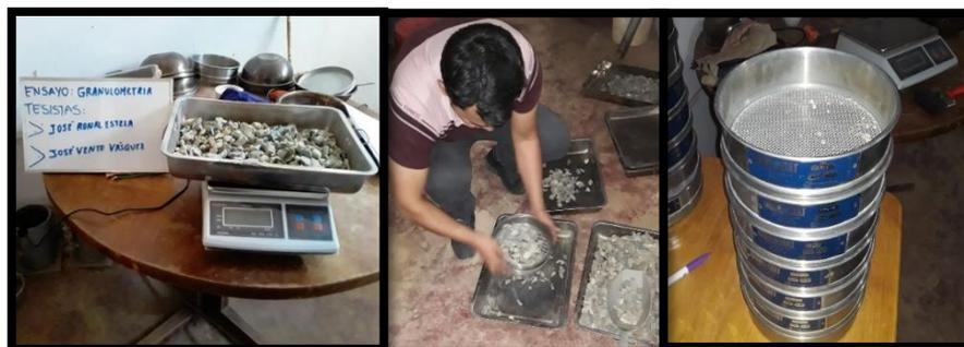
*Figura N° 15. Análisis granulométrico del agregado grueso*
