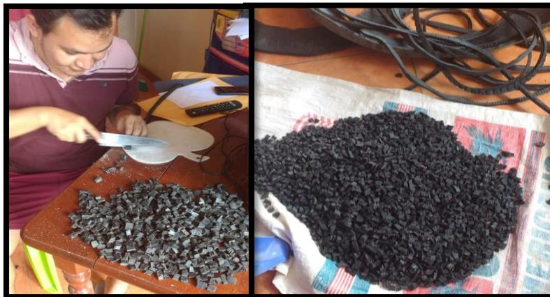
Figura N° 10. Partículas de Caucho Reciclado
