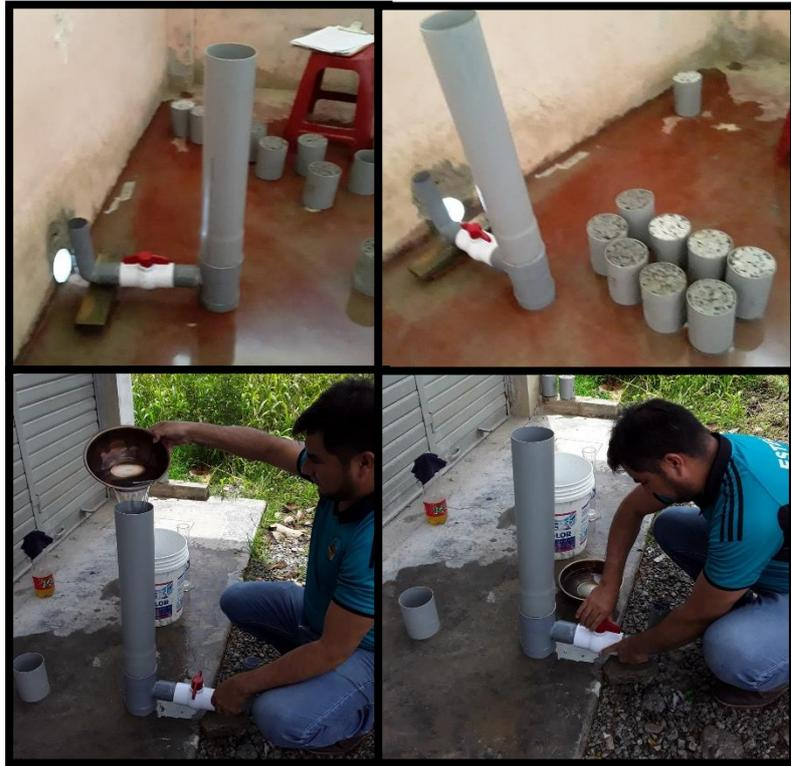
*Figura N° 24.* Ensayo de permeabilidad con permeámetro de carga variable
