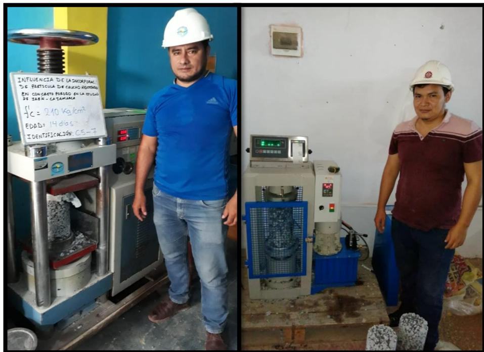
Figura N° 23. Ensayo a compresión de testigos cilíndricos
