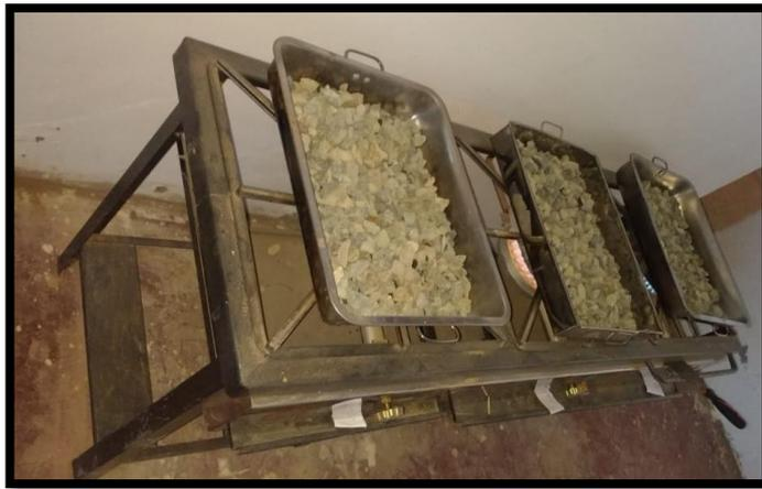
*Figura N° 17. Secado a estufa del agregado grueso*
