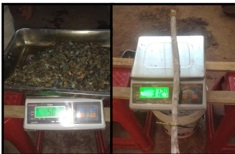
*Figura N° 16.* Gravedad específica y absorción del agregado grueso
