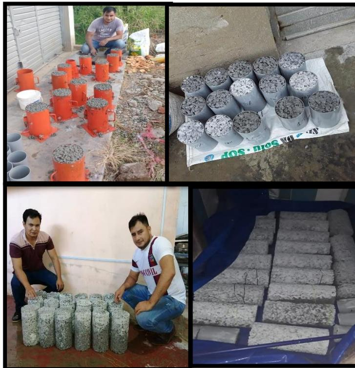
*Figura N° 22. Elaboración y curado de testigos de concreto poroso*
