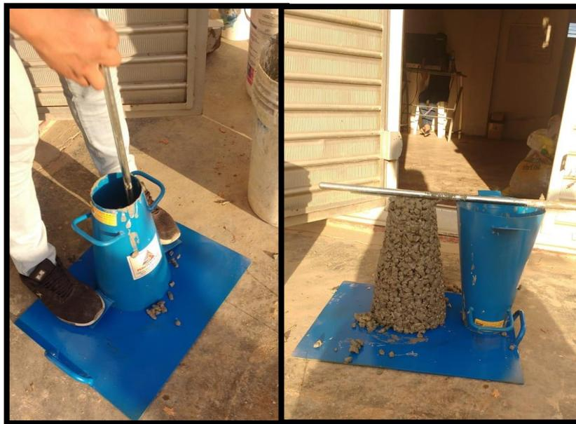
*Figura N° 20.* Ensayo de trabajabilidad del concreto poroso fresco – Slump
