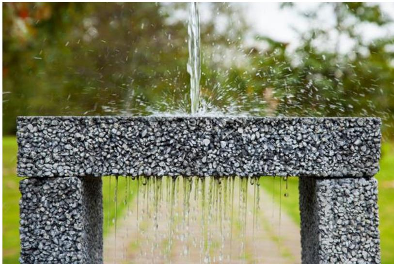
*Figura N° 1. Concreto Permeable*
