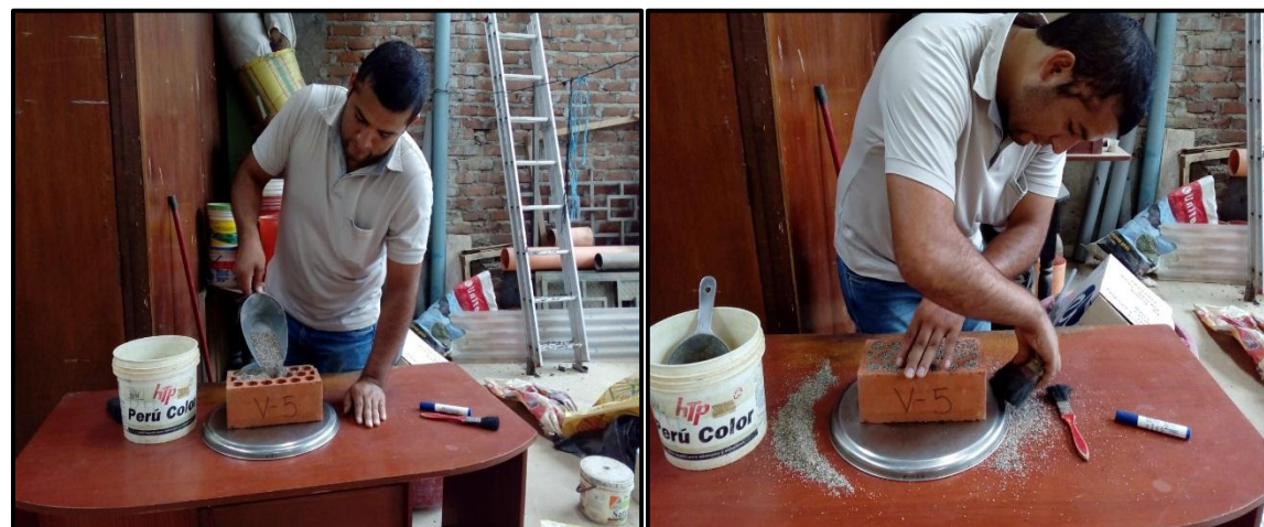
Foto 17 y 18: Procedimiento para calcular el porcentaje de vacíos en 10 unidades.
