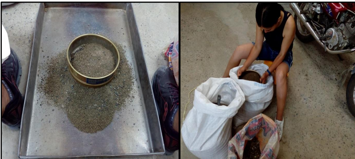
Figura 17 y Figura 18: Tamizado de arena a través de la malla #4.
