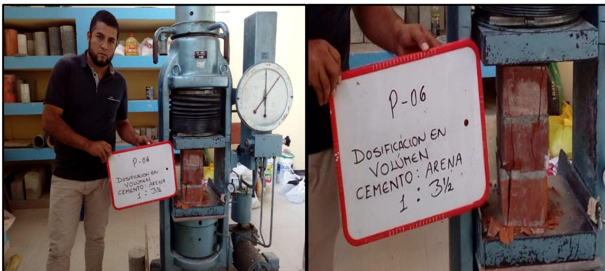
Figura 45 y Figura 46: Forma de falla P – 06 (Se aprecia grietas verticales en la cara de menor dimensión).
