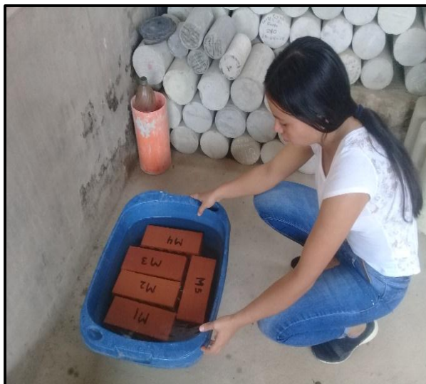
Figura 29: Ladrillos de arcilla sumergidos en agua limpia.
