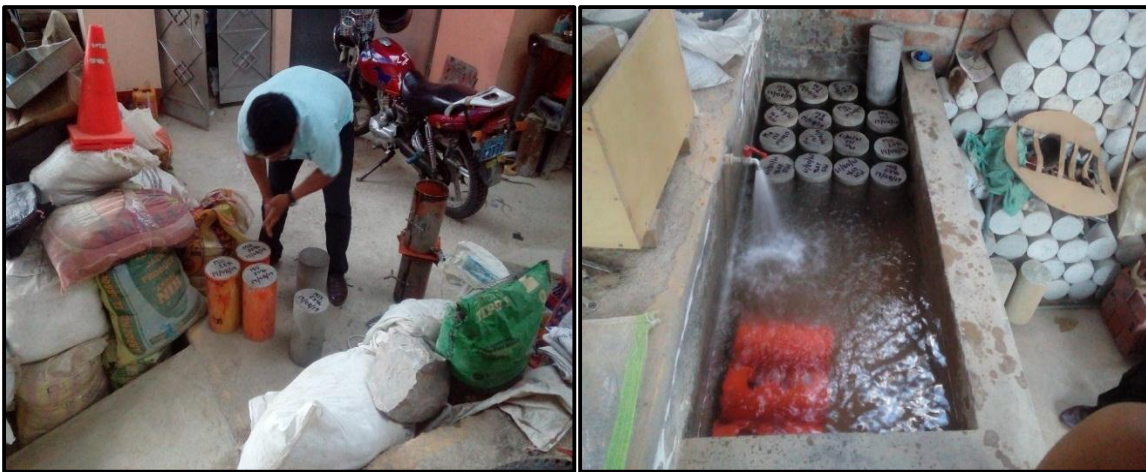
Foto 05 y 06: Prueba de resistencia de testigos de mortero con 10% de cal adicionada.
