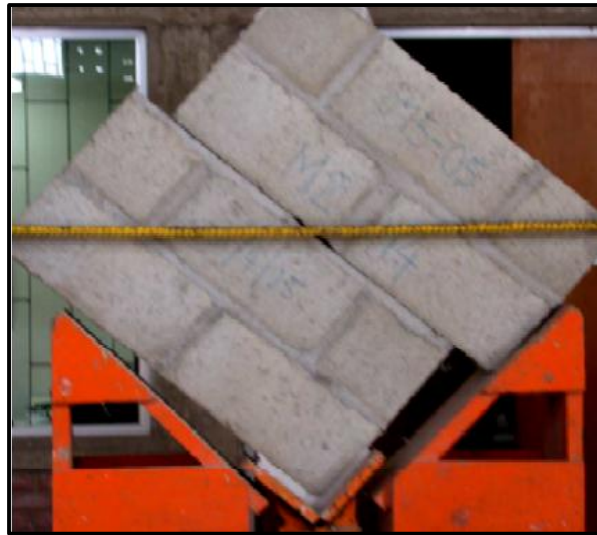
Figura 14: Falla por deslizamiento en muretes.
