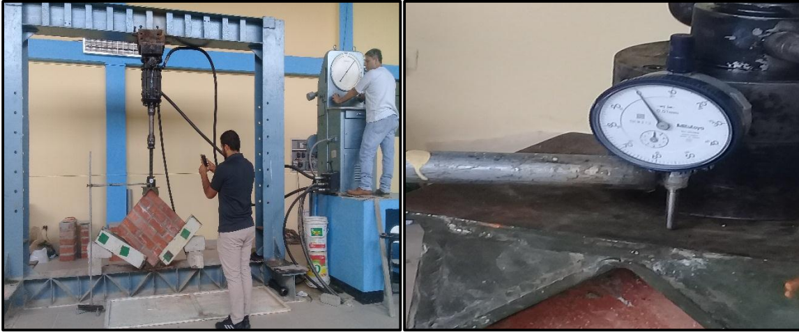
Foto 45 y 46: Prueba de Resistencia a la compresión diagonal en muretes sin adición de cal.
