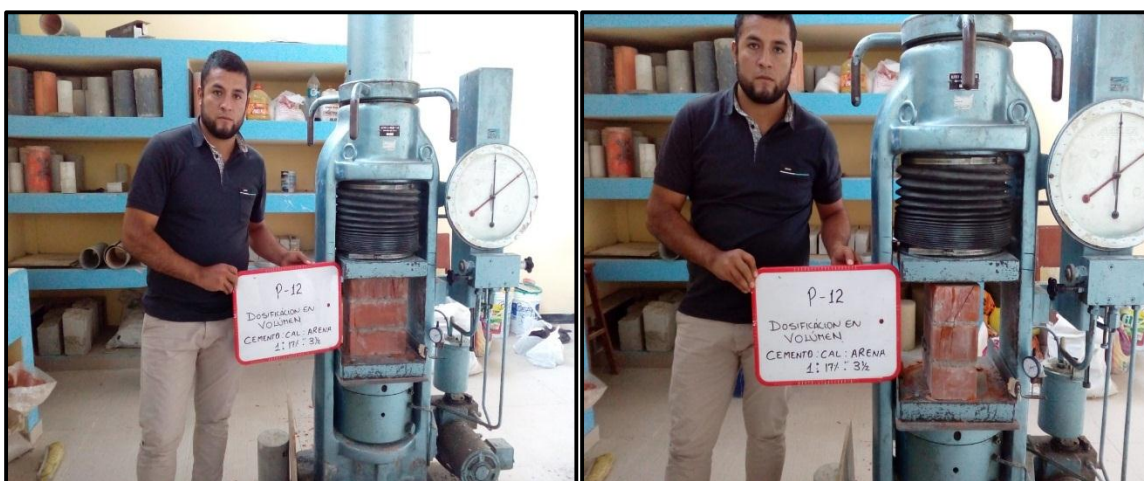
Foto 35 y 36: Resistencia a la compresión de la pila N°14 con 17% de adición de cal.
