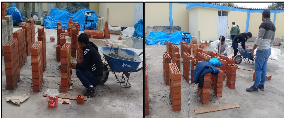
Foto 41 y 42: Control de altura de junta y verticalidad de muretes con y sin adición de cal.
