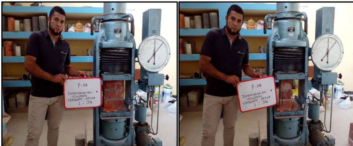
Foto 29 y 30: Resistencia a la compresión de la pila N°6 sin adición de cal.
