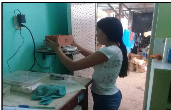
Figura 30: Toma de peso saturado de la unidad de albañilería.
