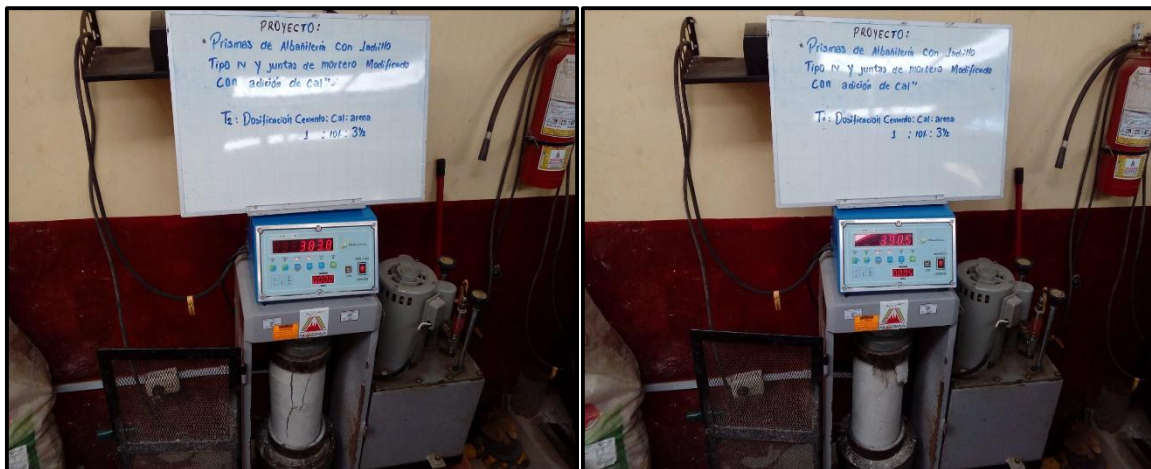
Foto 05 y 06: Prueba de resistencia de testigos de mortero con 10% de cal adicionada.
