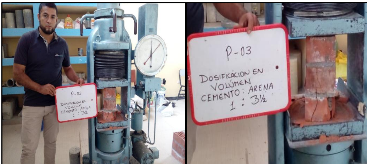
Figura 43 y Figura 44: Forma de falla P – 03 (Se aprecia grietas verticales en la cara de menor dimensión).
