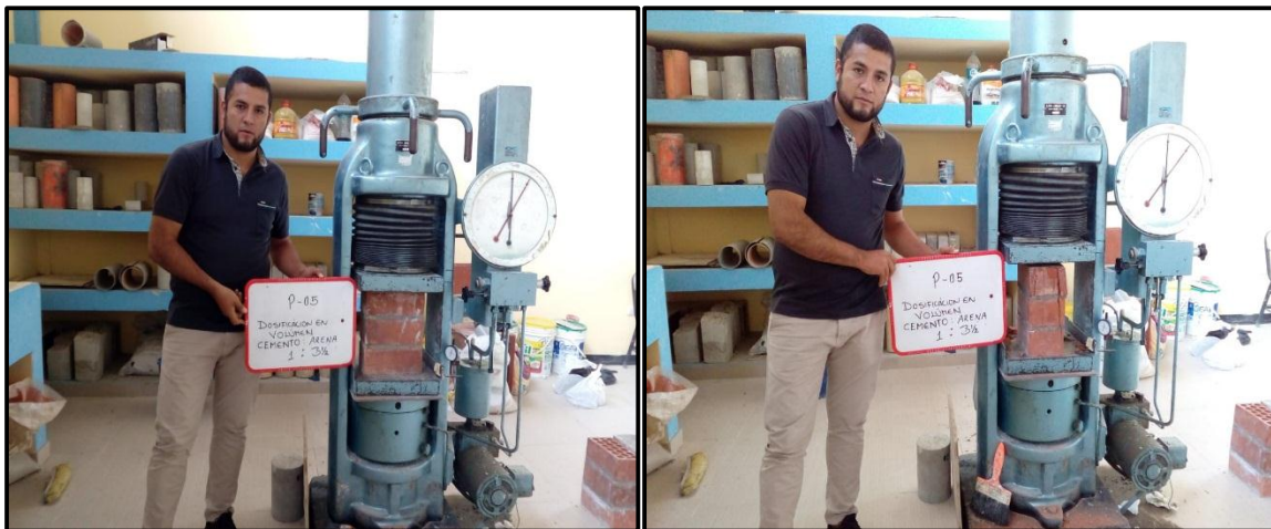
Foto 29 y 30: Resistencia a la compresión de la pila N°6 sin adición de cal.
