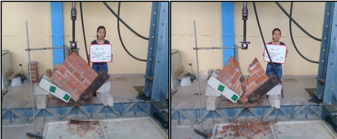
Foto 47 y 48: Compresión diagonal en muretes con 17% de adición de cal.
