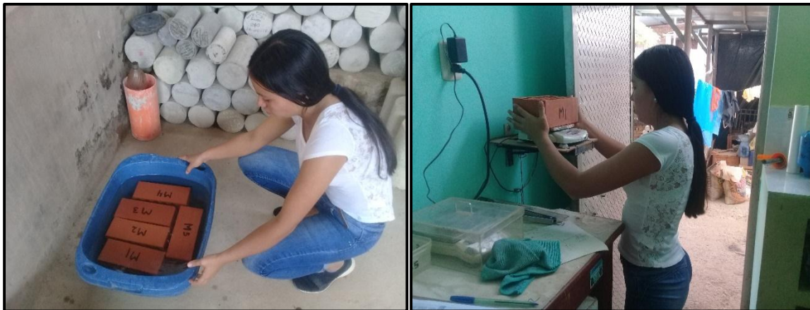
Foto 15 y 16: Secado y prueba de succión en 5 unidades patrón de albañilería.
