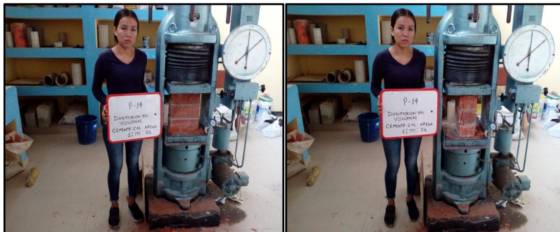
Foto 35 y 36: Resistencia a la compresión de la pila N°14 con 17% de adición de cal.
