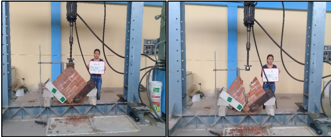
Foto 51 y 52: Deformación de muretes con 17% de adición de cal.
