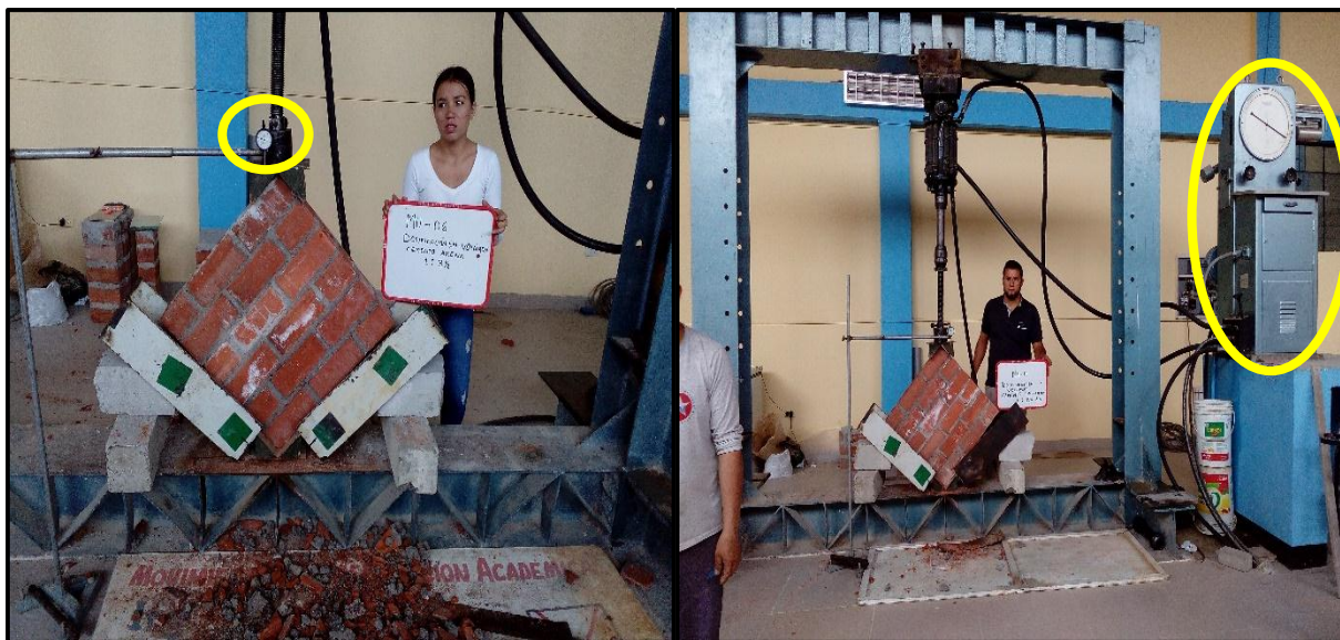
Figura 52 y Figura 53: Instrumentación de una pila. Se observa un deformímetro en la parte superior de la máquina de compresión diagonal.
