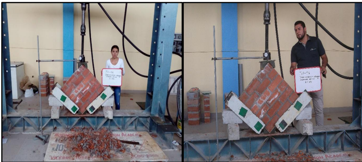
Figura 56 y Figura 57: Muretes instrumentados y colocados en la máquina de ensayo.
