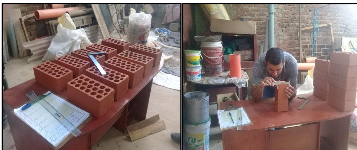
Foto 11 y 12: Alabeo y variación dimensional en las unidades de albañilería utilizadas.
