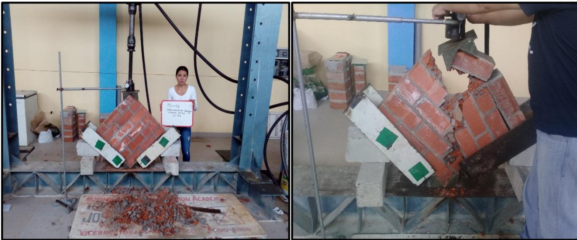
Foto 47 y 48: Compresión diagonal en muretes con 17% de adición de cal.
