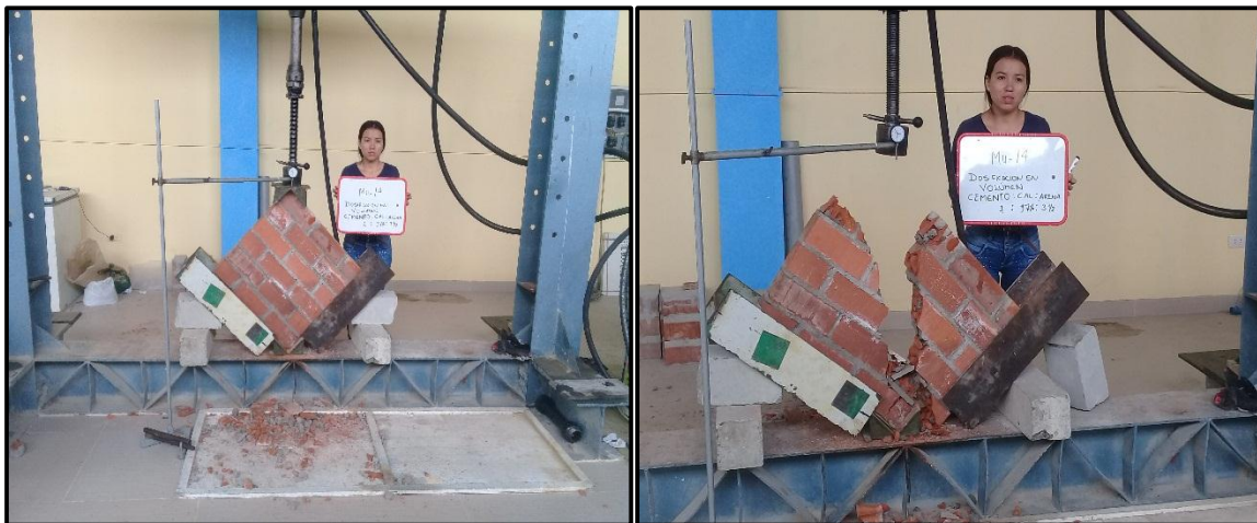
Foto 51 y 52: Deformación de muretes con 17% de adición de cal.
