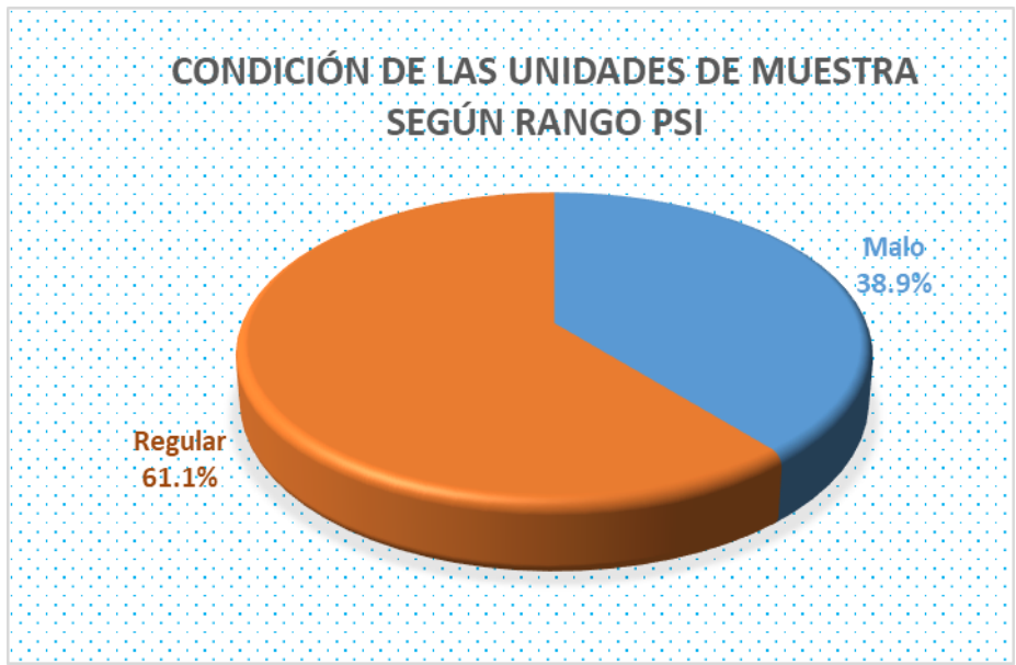
Figure 29. Estado actual del Pavimento
