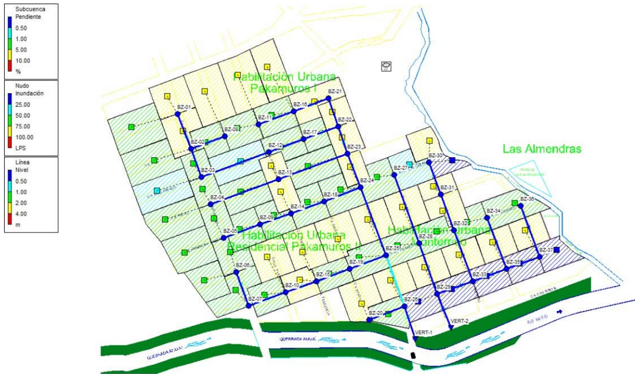
Imagen 18: La red pluvial corregida en SWMM
