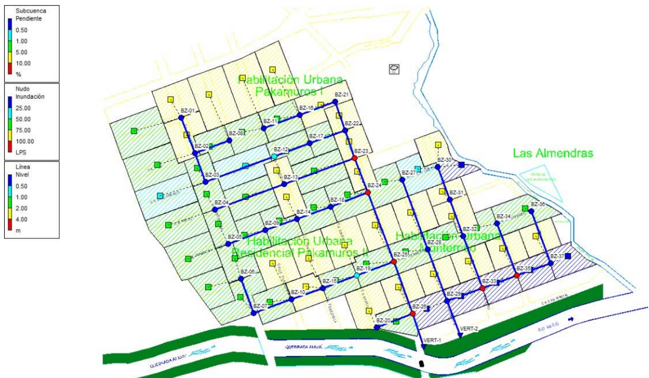
Imagen 16: La red pluvial colapsado en SWMM
