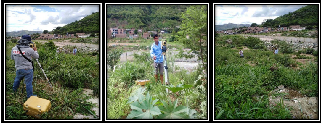
Imagen 22: Levantamiento topográfico (Estación total y jalones)
