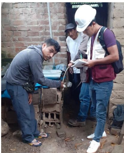
Figura 20: Medida de presión de agua en vivienda ubicada en la calle Francisco Aranda.
