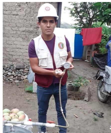
Figura 21: Medida de presión de agua en vivienda ubicada en la calle Cristo Rey
