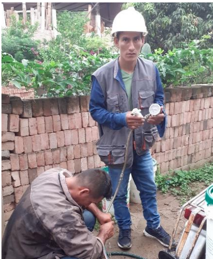
Figura 22: Medida de presión de agua en vivienda ubicada en la calle Huamantanga.
