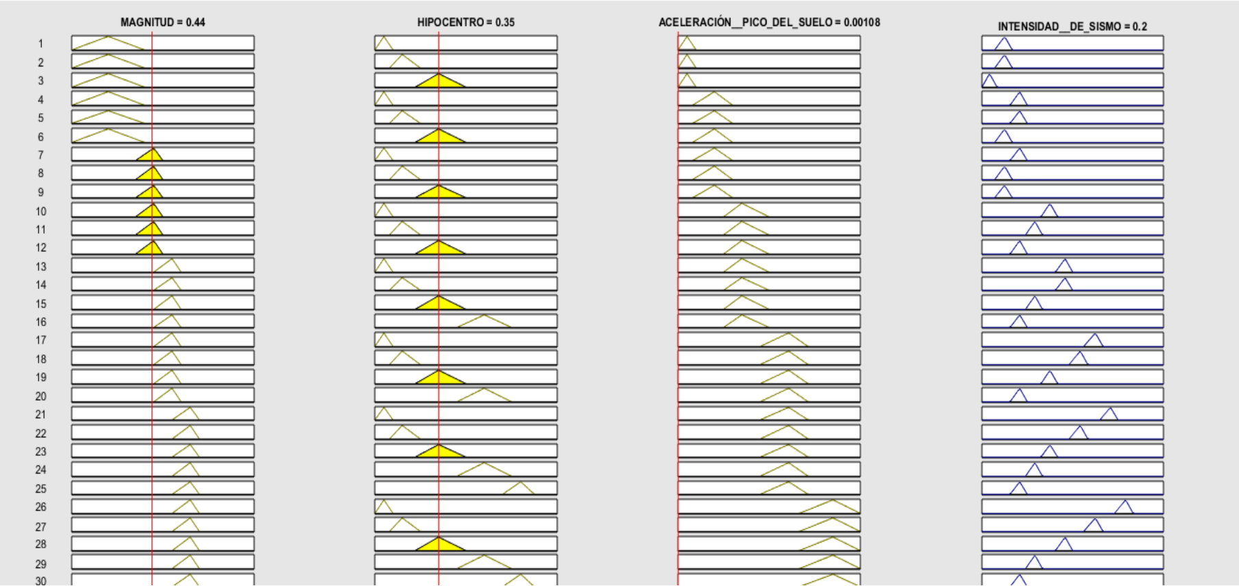
Figura 16: Sismo del 29/05/2019 con Magnitud: 5.0 ML, Hipocentro: 140 km, Aceleración pico del suelo: 0.54 cm / s 2 ; en valores normalizados, Magnitud :0.444, Hipocentro: 0.350, Aceleración pico del suelo: 0.00108.
