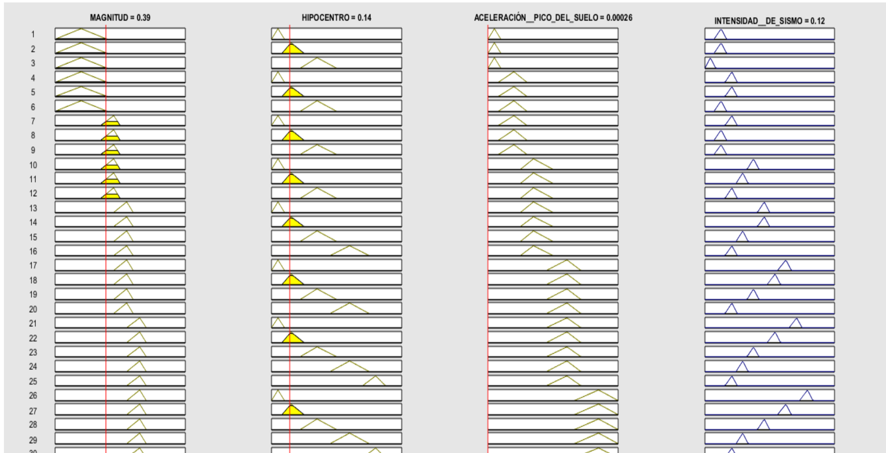
Figura 14: Sismo del 19/01/2019 con Magnitud: 4.50 ML, Hipocentro: 56 km, Aceleración pico del suelo: 0.13 cm / s 2 ; en valores normalizados, Magnitud 0.389, Hipocentro: 0.140, Aceleración pico del suelo: 0.00026.
