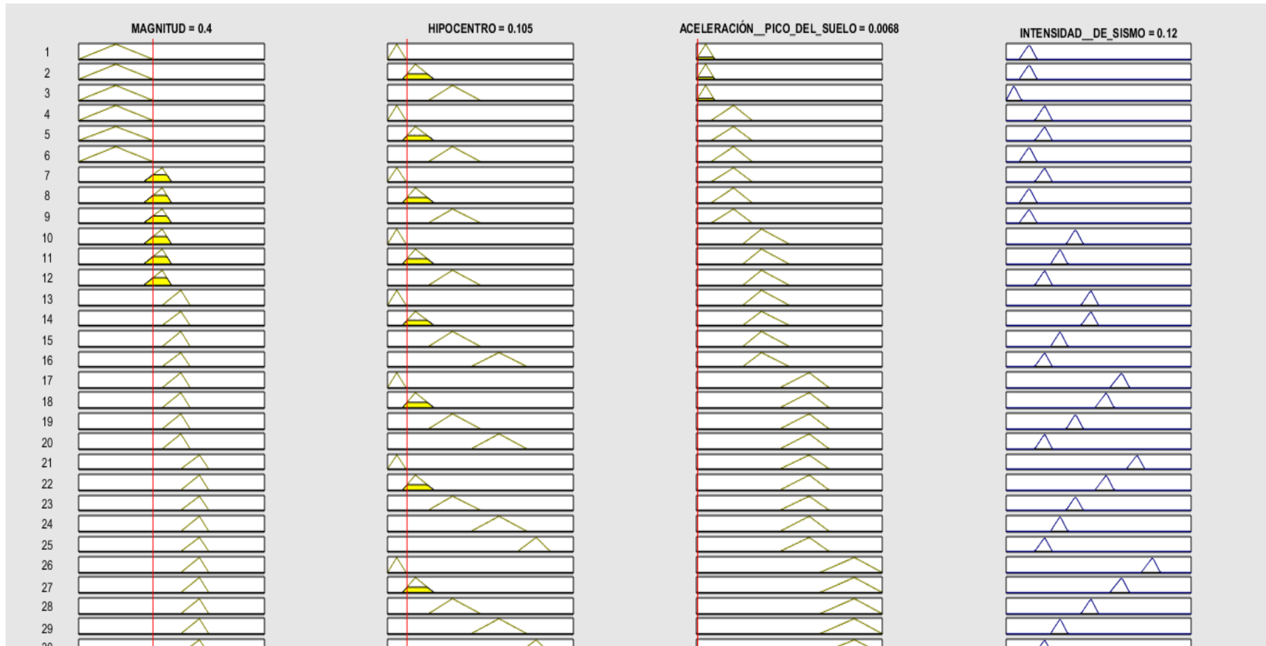
Figura 22: Sismo del 02/04/2020 con Magnitud: 4.6 ML, Hipocentro: 42 km, Aceleración pico del suelo: 0.34 cm / s 2 ; en valores normalizados, Magnitud :0.400, Hipocentro: 0.105, Aceleración pico del suelo: 0.00068.
