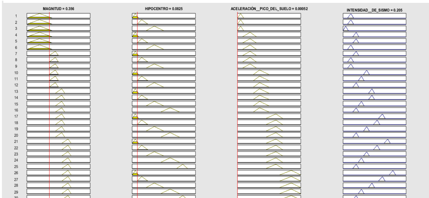
Figura 38: Sismo del 11/08/2017 con Magnitud: 4.2 ML, Hipocentro: 33 km, Aceleración pico del suelo: 0.26 cm/s 2 ; en valores normalizados, Magnitud :0.3556, Hipocentro: 0.0825, Aceleración pico del suelo: 0.00052.
