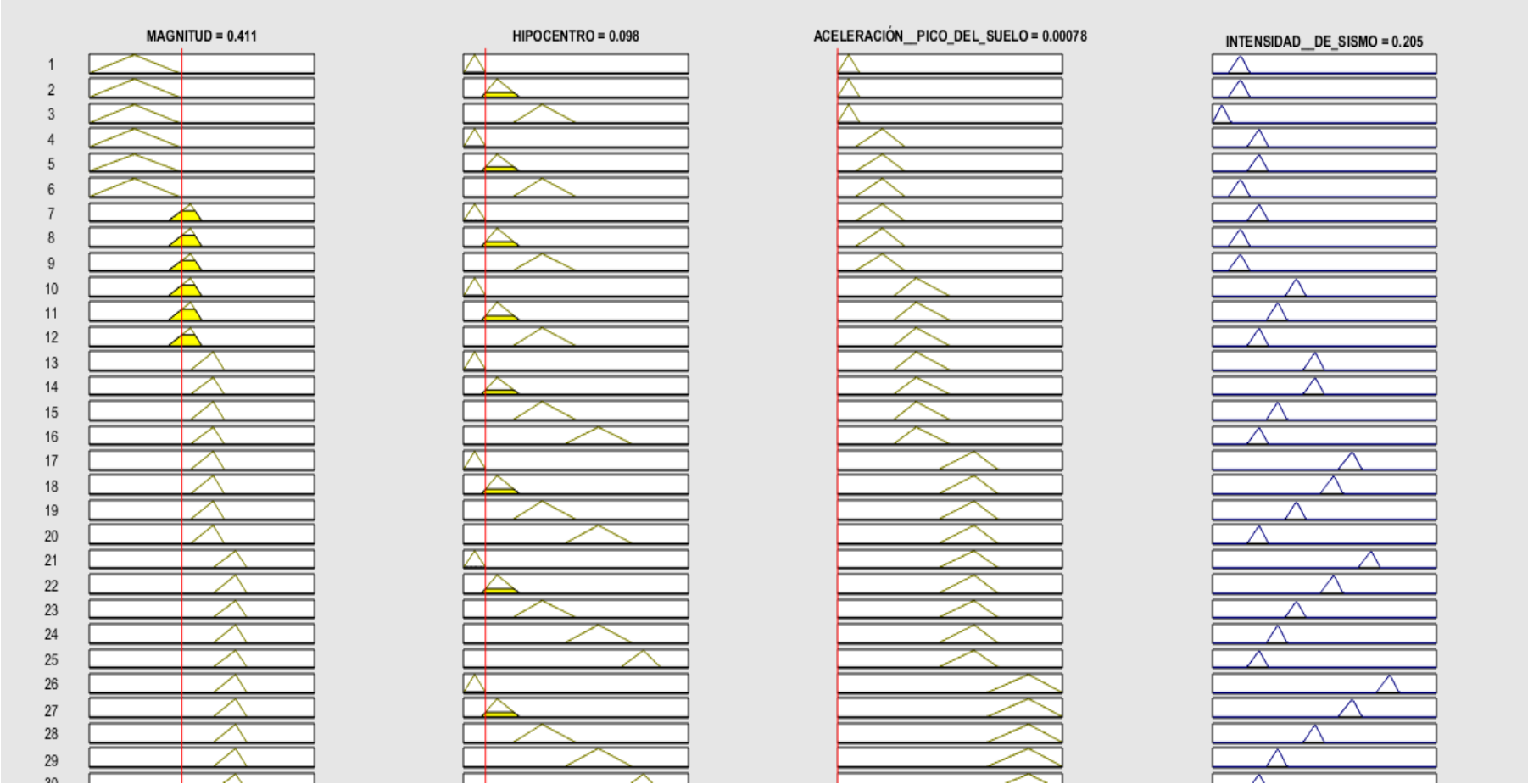
Figura 20: Sismo del 08/05/2020 con Magnitud: 4.7 ML, Hipocentro: 39 km, Aceleración pico del suelo: 0.39 cm / s 2 ; en valores normalizados, Magnitud :0.411, Hipocentro: 0.098, Aceleración pico del suelo: 0.00078.
