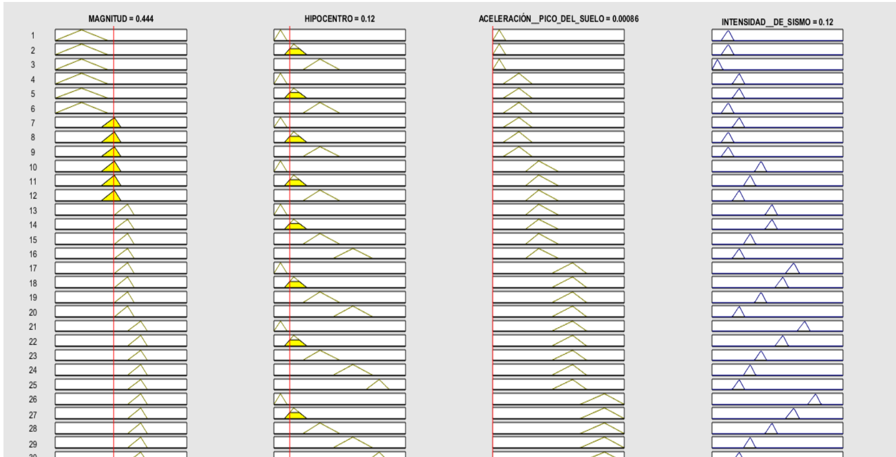
Figura 24: Sismo del 03/01/2020 con Magnitud: 5.0 ML, Hipocentro: 48 km, Aceleración pico del suelo: 0.43 cm / s 2 ; en valores normalizados, Magnitud :0.444, Hipocentro: 0.120, Aceleración pico del suelo: 0.00086.
