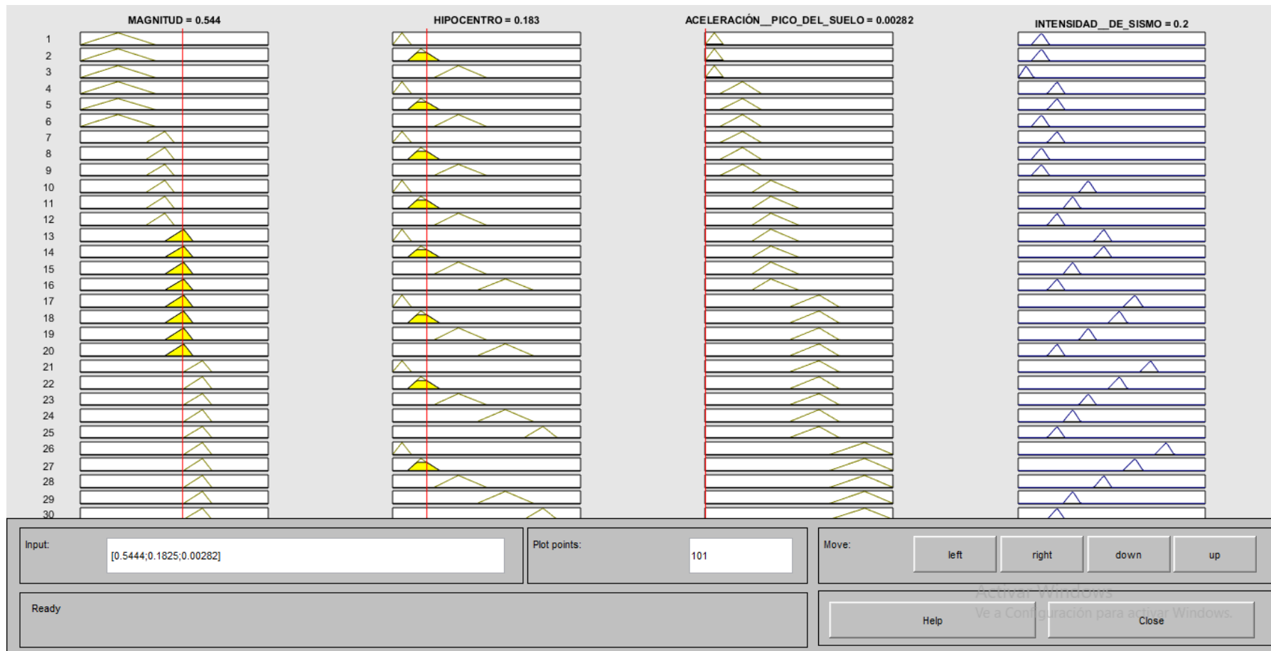
Figura 43: Sismo del 04/02/2019 con Magnitud: 5.9 ML, Hipocentro: 73 km, Aceleración pico del suelo: 1.41 cm / s 2 ; en valores normalizados, Magnitud :0.5444, Hipocentro: 0.1825, Aceleración pico del suelo: 0.00282.
