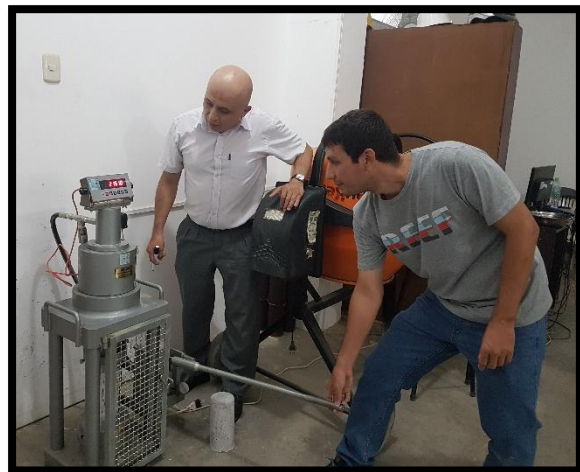
ROTURA DE ESPECÍMENES
