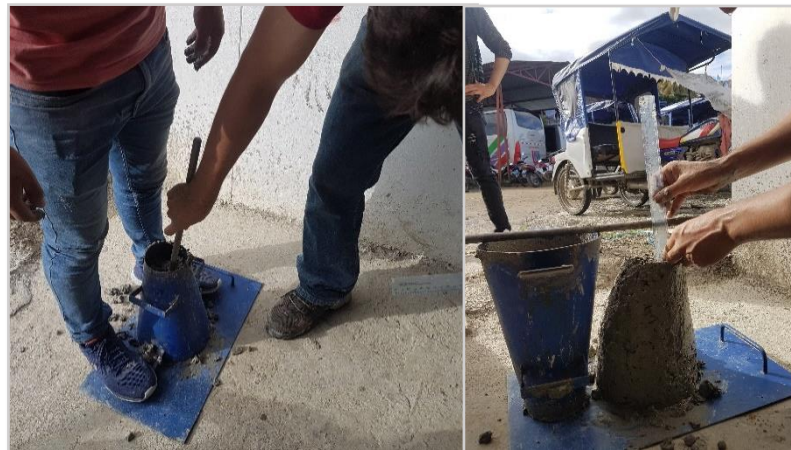
Figura 42. Asentamiento del concreto (slump)
