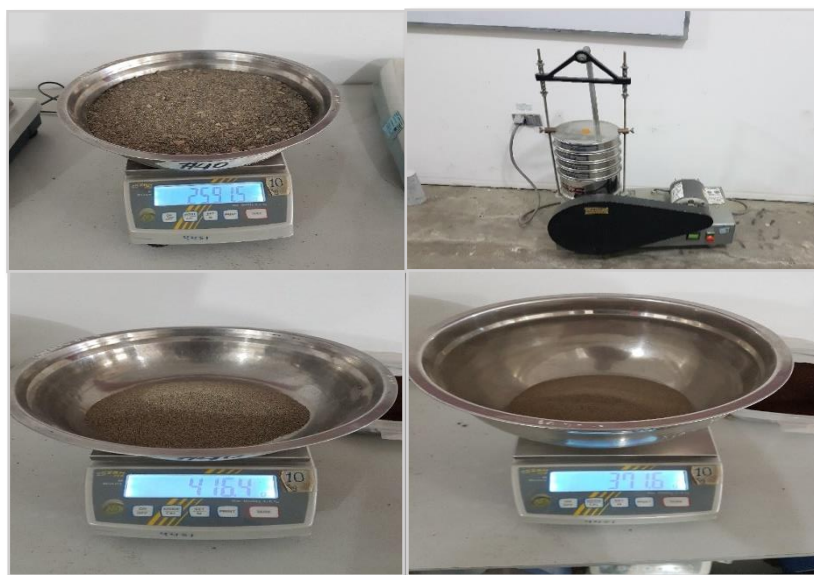
Figura 26. Análisis granulométrico del agregado fino.
