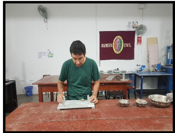
CALIBRADOR PROPORCIONAL DE PARTÍCULAS CHATAS Y ALARGADAS
