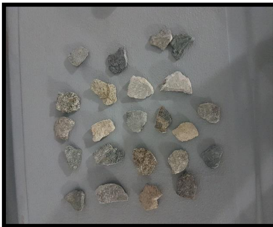
PARTÍCULAS CHATAS Y ALARGADAS DEL AGREGADO GRUESO
