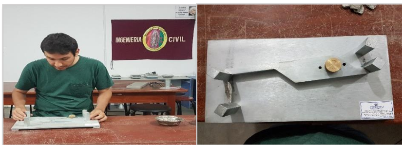
Figura 15. Calibrador proporcional y selección de partículas chatas y alargadas A.G.
