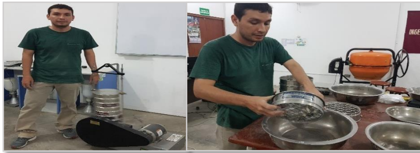
Figura 13. Procedimiento para análisis granulométrico
