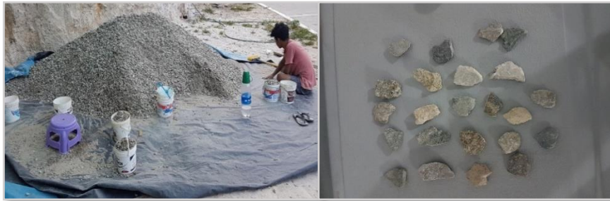
Figura 16. Selección de partículas chatas y alargadas del A. Grueso.
