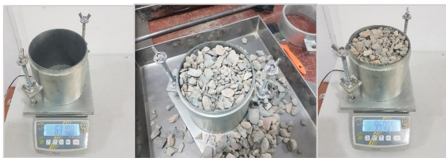
Figura 35. Peso unitario suelto del agregado grueso.
