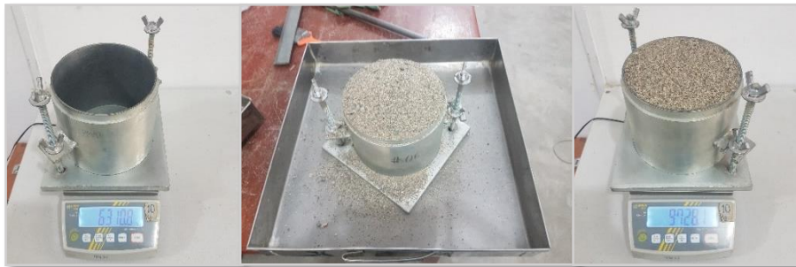
Figura 34. Peso unitario suelto del agregado fino.
