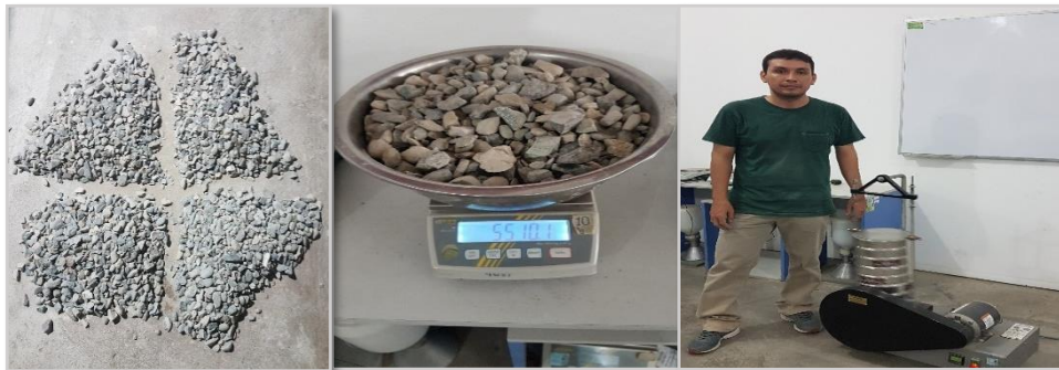
Figura 28. Análisis granulométrico del agregado grueso.
