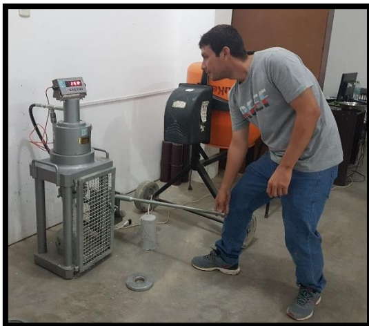
ROTURA DE ESPECÍMENES
