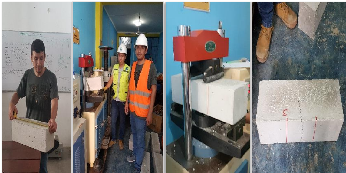
Figura 52. Resistencia a la flexión del concreto.
