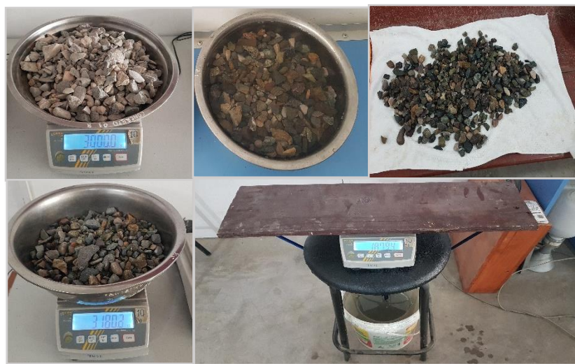
Figura 32. Peso específico y absorción del agregado grueso.
