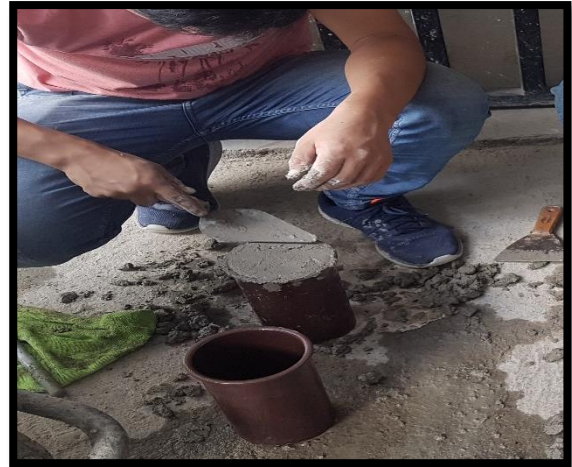
ELABORACIÓN DE ESPECÍMENES CILÍNDRICOS (PROBETAS)
