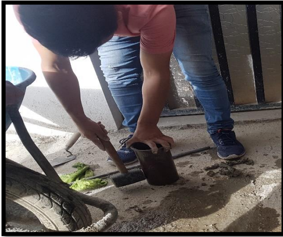
ELABORACIÓN DE ESPECÍMENES CILÍNDRICOS (PROBETAS)
