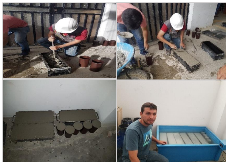
Figura 48. Elaboración y curado de especímenes.
