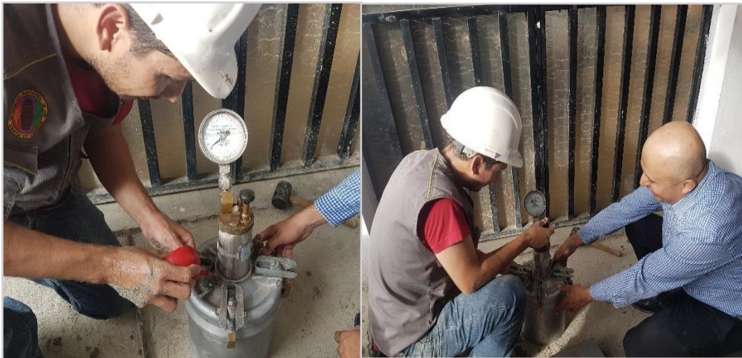
Figura 46. Contenido de aire del concreto.
