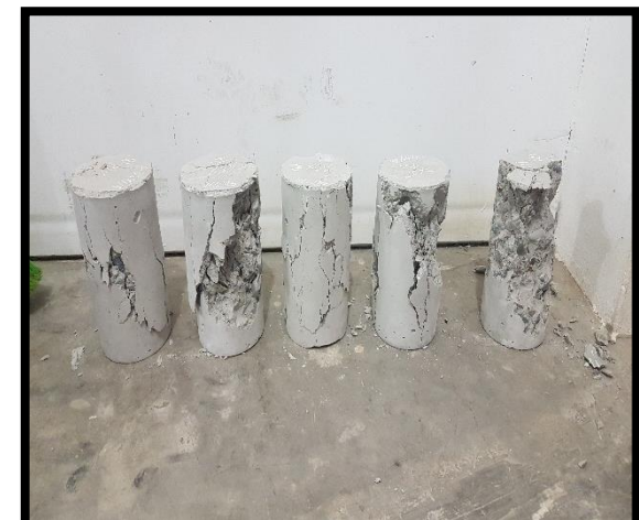
TIPOS DE FALLAS DE LOS ESPECÍMENES
