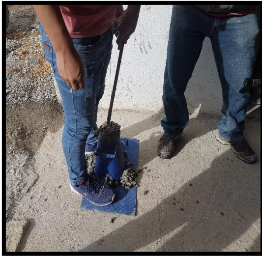
ENSAYO DE ASENTAMIENTO DEL CONCRETO (SLUMP)
