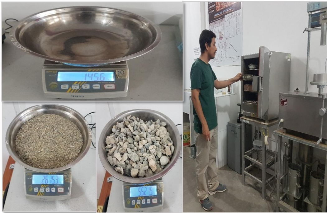
Figura 22. Muestras de agregados para determinar el contenido de humedad.
