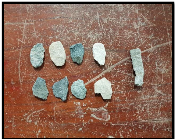
PARTÍCULAS CHATAS Y ALARGADAS DEL AGREGADO GRUESO
