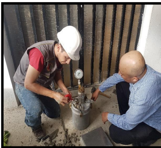
ENSAYO DE CONTENIDO DE AIRE DEL CONCRETO
