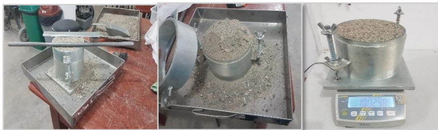
Figura 37. Peso unitario compactado del agregado fino
