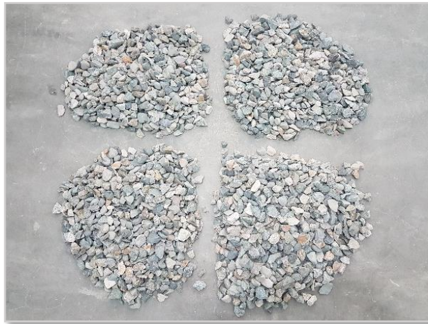
Figura 11. Cuarteo del agregado grueso
