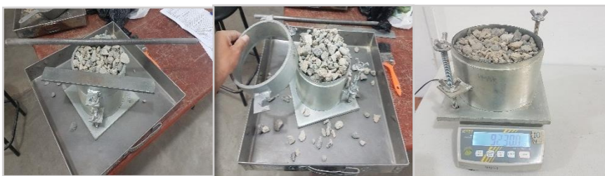
Figura 38. Peso unitario compactado del agregado grueso
