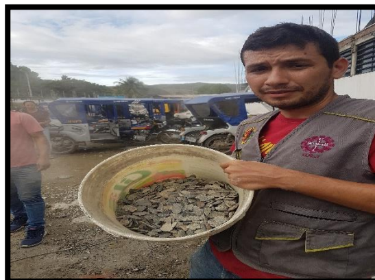
AGREGADO GRUESO Y PARTÍCULAS CHATAS Y ALARGADAS
