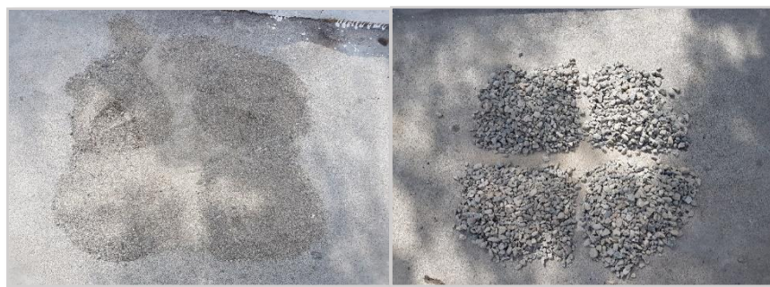
Figura 20. Cuarteo del agregado fino y del agregado grueso.
