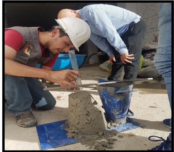
ENSAYO DE ASENTAMIENTO DEL CONCRETO (SLUMP)
