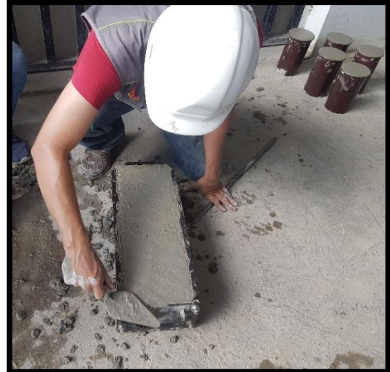
ELABORACIÓN DE ESPECÍMENES PRISMÁTICOS (VIGAS)
