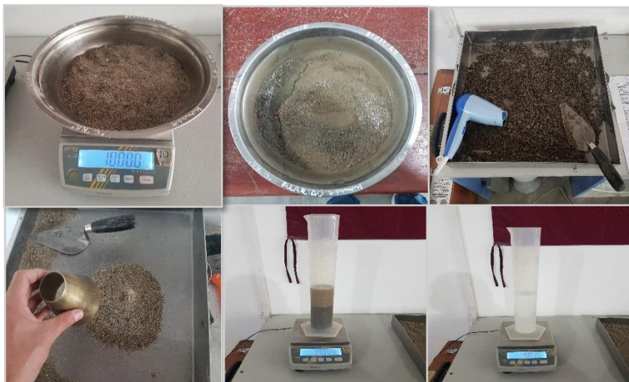
Figura 30. Peso específico y absorción del agregado fino.
