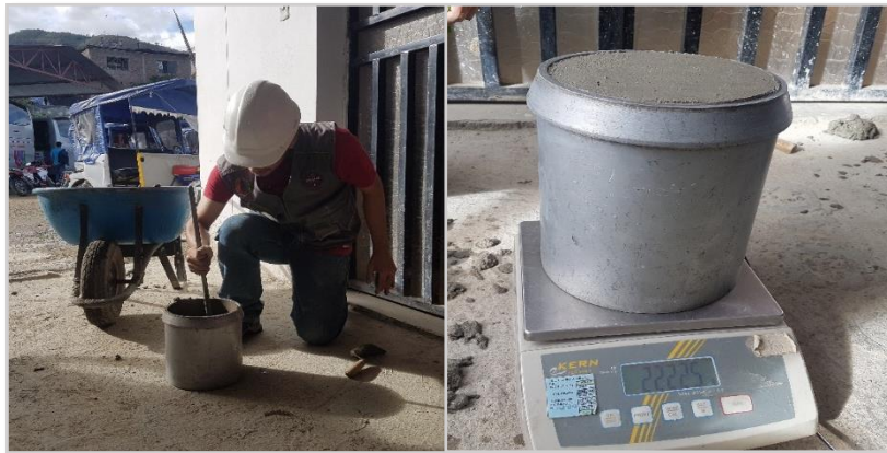
Figura 44. Peso unitario y rendimiento del concreto.
