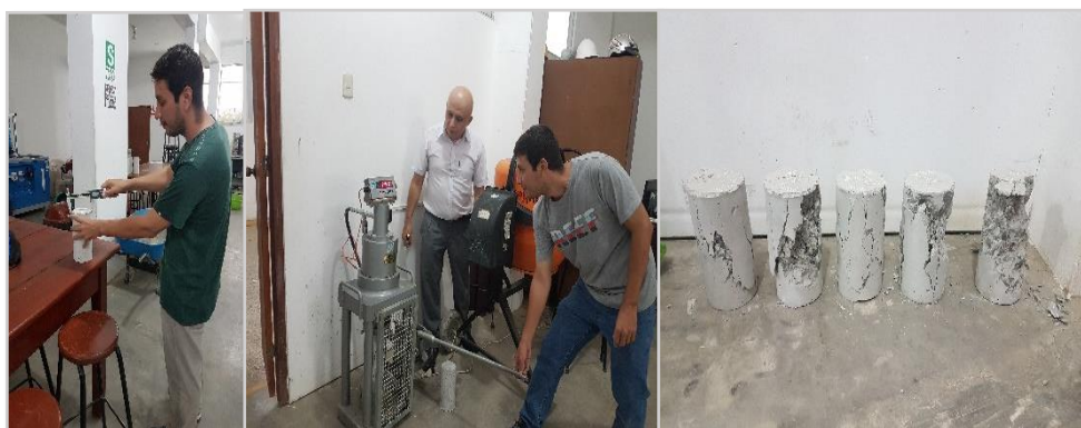
Figura 50. Resistencia a la compresión del concreto.
