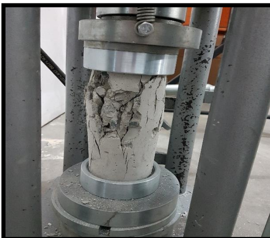
TIPOS DE FALLAS DE LOS ESPECÍMENES
