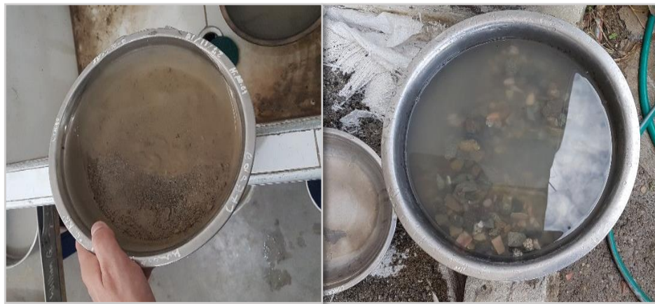
Figura 24. Lavado del agregado fino y grueso por la malla N° 200.
