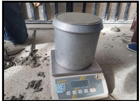
ENSAYO DE PESO UNITARIO DEL CONCRETO FRESCO
