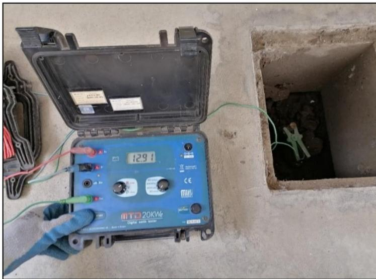
Obteniendo resultados de medición  $12.91\Omega$  estando en buenas condiciones.
