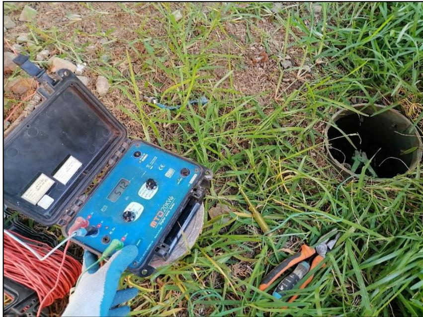
Obteniendo los resultados de medición con un valor de resistencia de  $51.2 \Omega$ , se recomienda bajar la resistividad aún valor menor de  $25 \Omega$  de acuerdo al CNE-utilización SECCIÓN 060-712.
