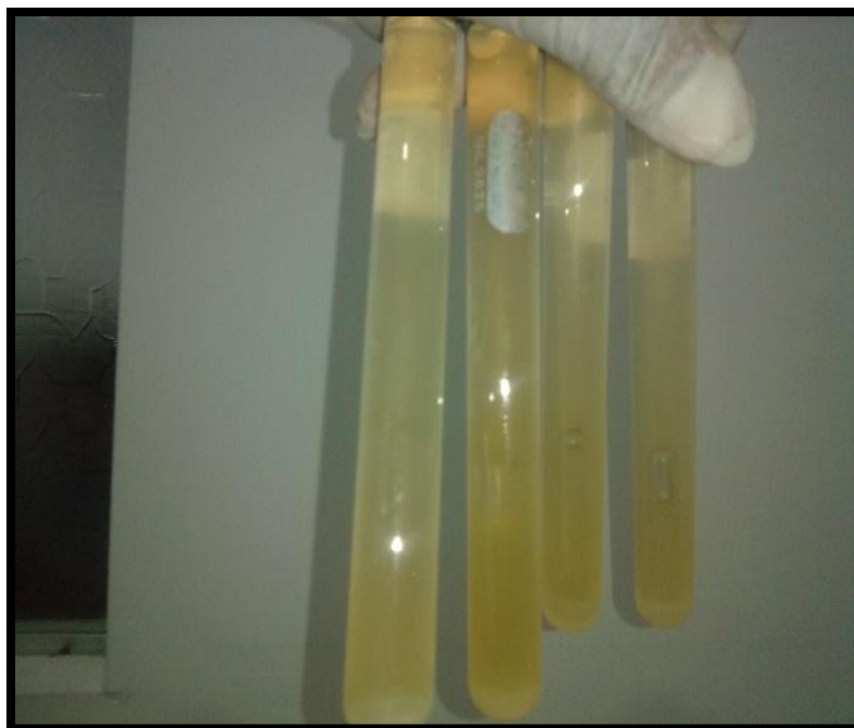
Figura 12. Turbidez y gas en la prueba presuntiva para coliformes totales
