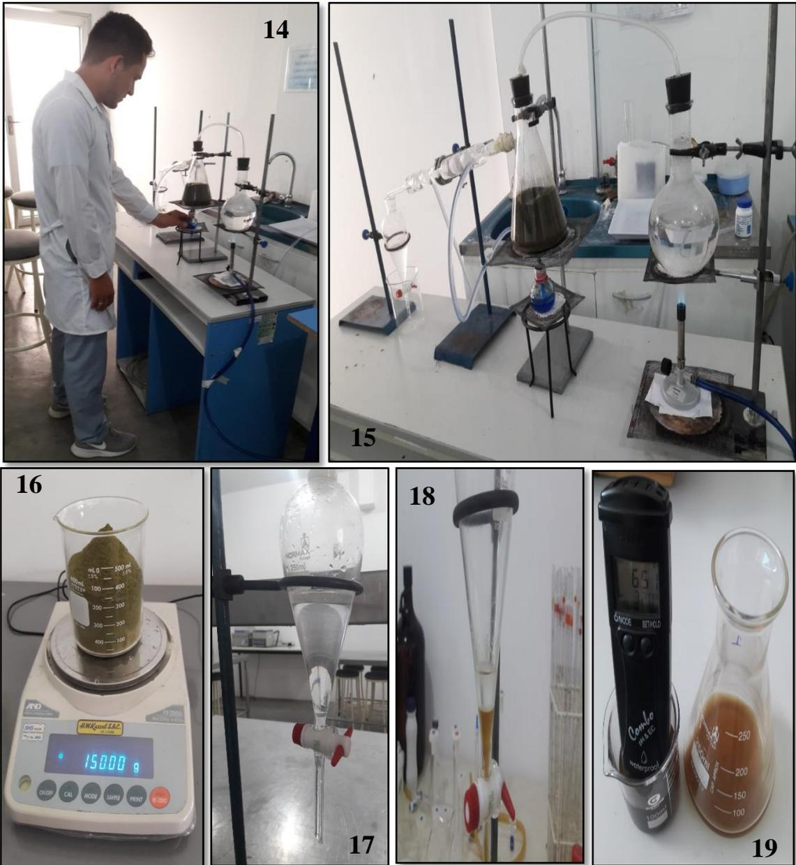
**Fotografía N° 14.** Destilador, **Fotografía N° 15.** Destilación de los aceites esenciales, **Fotografía N° 16.** Pesado de la muestra seca y molidas, **Fotografía N° 17.** Decantación, **Fotografía N° 18.** Fraccionamiento de las fases y **Fotografía N° 19.** Filtrado y medición del pH.
