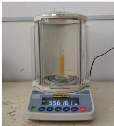
**Figura 20:** *Probeta con la bebida alcohólica para obtener la densidad*
