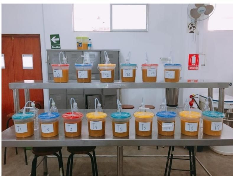
**Figura 16:** Biorreactores para la obtención de alcohol del jugo de carambola
