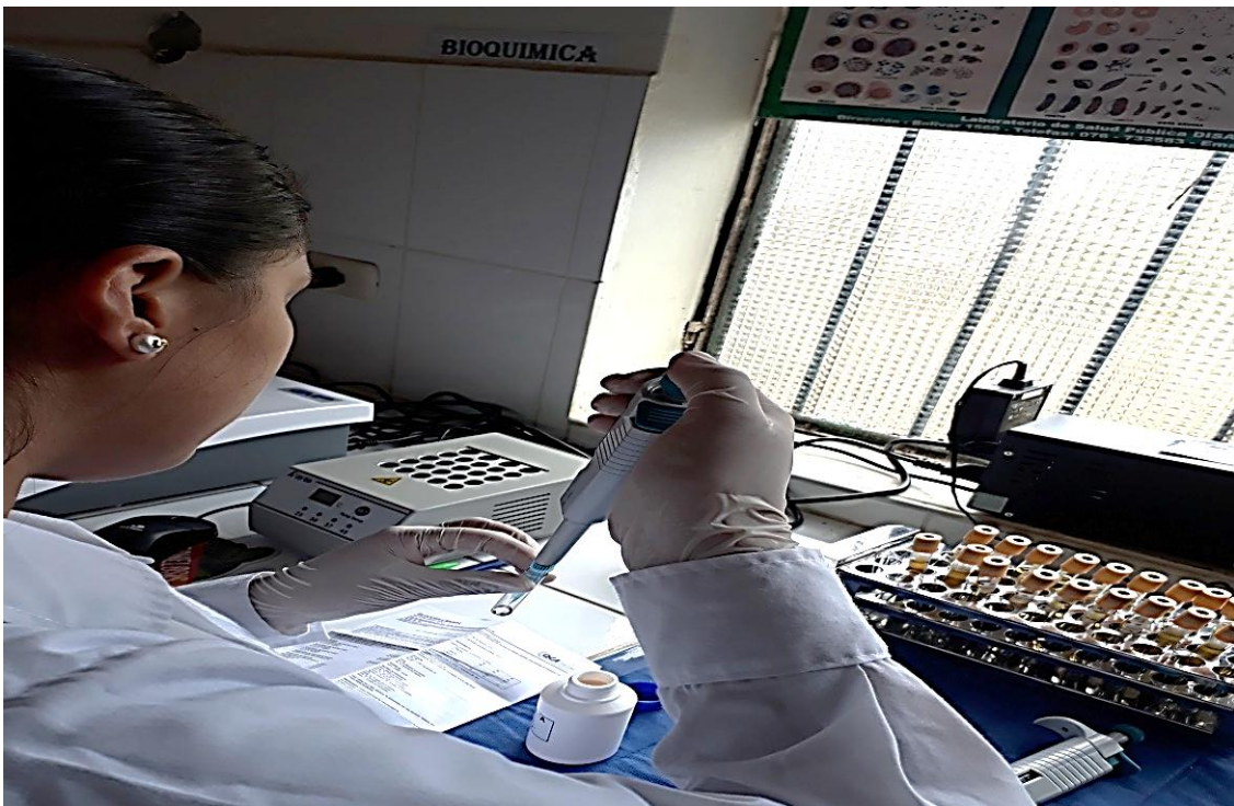
3.- En un tubo se coloca 1000 microlitros de reactivo con la ayuda de una Micropipeta.
