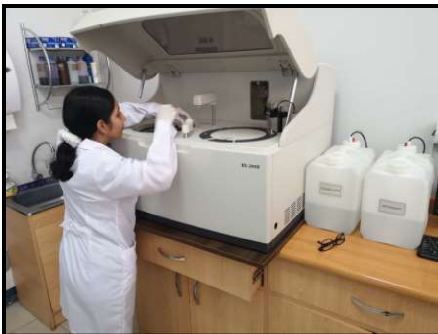
Figura 05. Colocando las muestras en el orden correspondiente en el equipo bioquímico.
