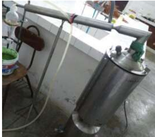
Equipo de extracción de aceites esenciales por arrastre de vapor de agua
