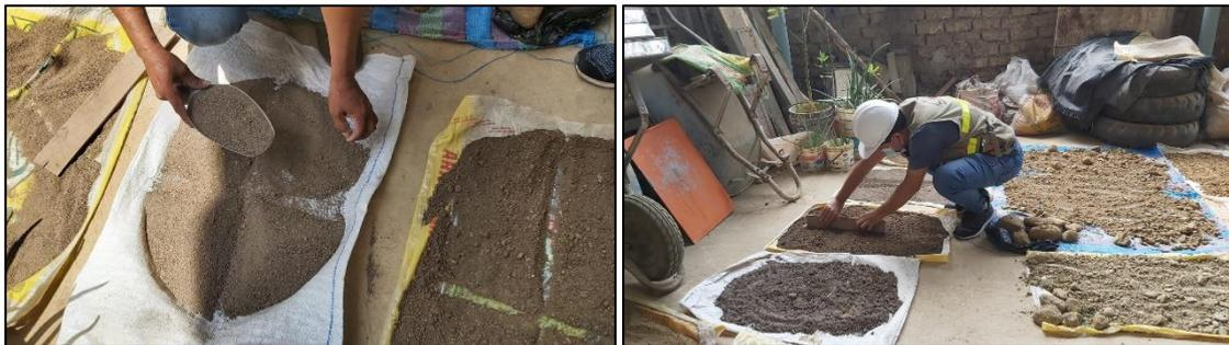
Posteriormente se colocó la muestra en un recipiente y se agregó suficiente cantidad de agua para cubrirla y se dejó remojar por una hora. Luego se colocó la muestra en la malla N° 200 y se empezó a lavar cuidadosamente el material utilizando agua a chorro evitando la pérdida de partículas retenidas en la misma, hasta lograr que el agua del lavado esté completamente clara.
