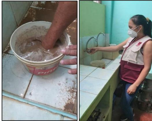
El material retenido en la malla N° 200 se colocó en un recipiente y se secó en una estufa por un periodo de 24 horas. Cuando la muestra estuvo completamente seca se colocó en el tamizador eléctrico pasando por un juego de tamices, para finalmente pesar el material retenido en cada tamiz.
