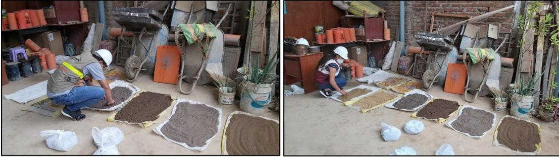
Pasada las 24 horas se mezcló bien hasta formar una pila en forma de cono, repitiendo esta operación cuatro veces. Luego se procedió a dividir diametralmente el material en cuatro partes iguales, de las cuales se separaron dos cuartos diagonalmente opuestos. Los dos cuartos restantes se mezclaron y se repitió la operación hasta obtener la cantidad requerida para el ensayo.
