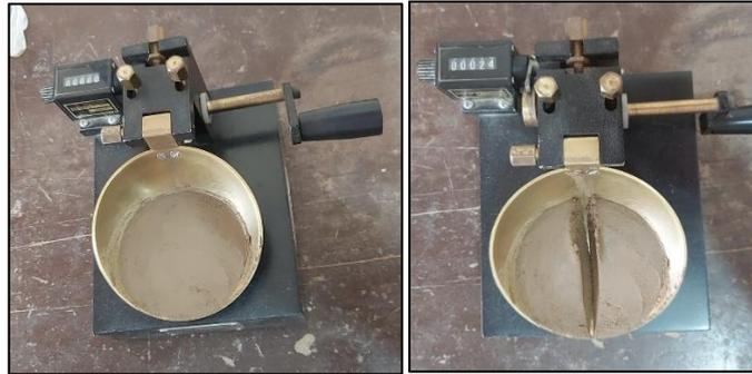
Posteriormente se empezó a girar el manubrio a una velocidad de 2 golpes por segundo hasta lograr que las dos mitades de la pasta se junten en una longitud de 13 mm y se registró el número de golpes para cerrar la ranura.
