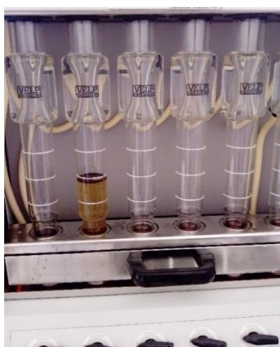
Figura 20: Análisis para determinar fibra con el equipo digestor de fibra
