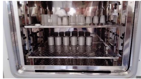
Figura 22: Análisis para determinar la humedad con el equipo estufa
