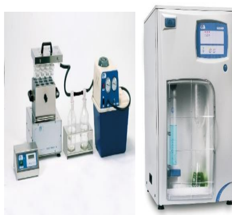
Figura 19: Análisis de proteínas con la unidad de digestión y destilador Kjeldahl
