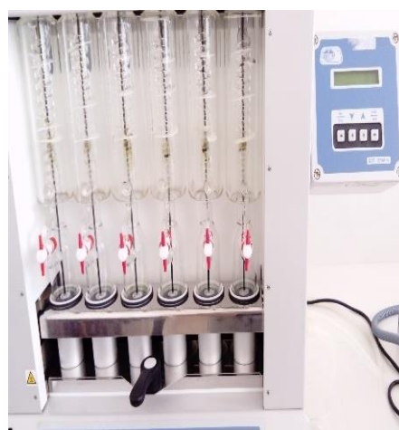
Figura 19: Análisis de proteínas con la unidad de digestión y destilador Kjeldahl
