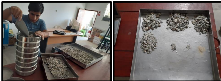
Figura 6: Ensayo granulometría del agregado grueso, cantera "Josecito".
