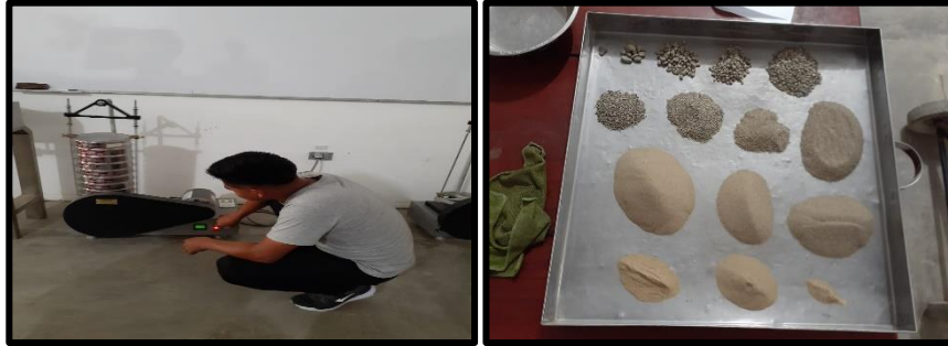
Figura 1: Ensayo granulometría del agregado fino, cantera “Josecito”.
