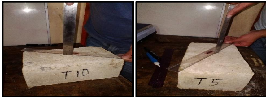
Figura 13: Ensayo de alabeo de los bloques
