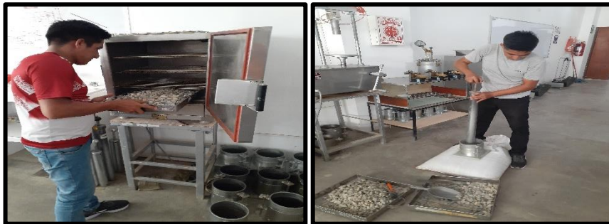
Figura 10: Ensayo peso compactado agregado grueso.
