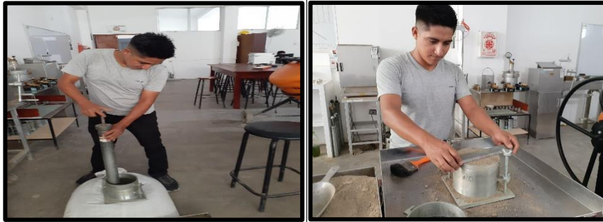
Figura 5: Ensayo peso compactado agregado fino.
