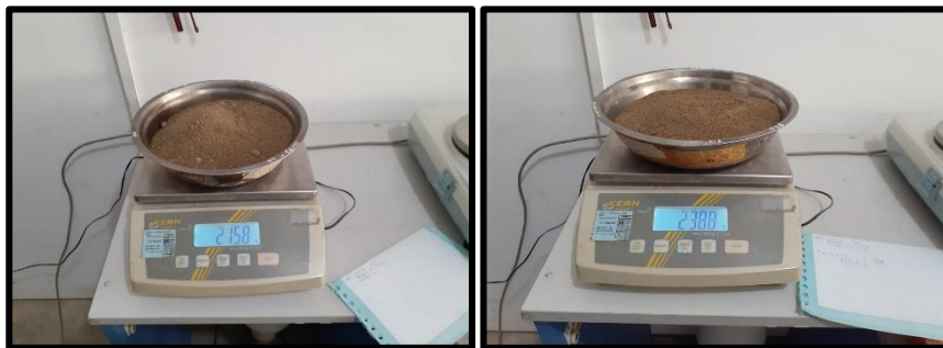
Figura 2: Ensayo contenido de humedad del agregado fino.
