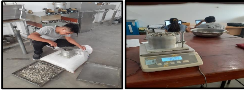
Figura 9: Ensayo peso unitario suelto.
