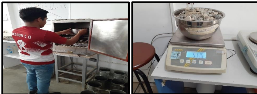
Figura 7: Ensayo contenido de humedad del agregado grueso.
