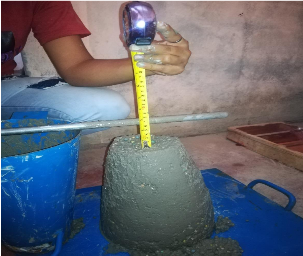
Foto 7. Prueba de asentamiento del concreto
