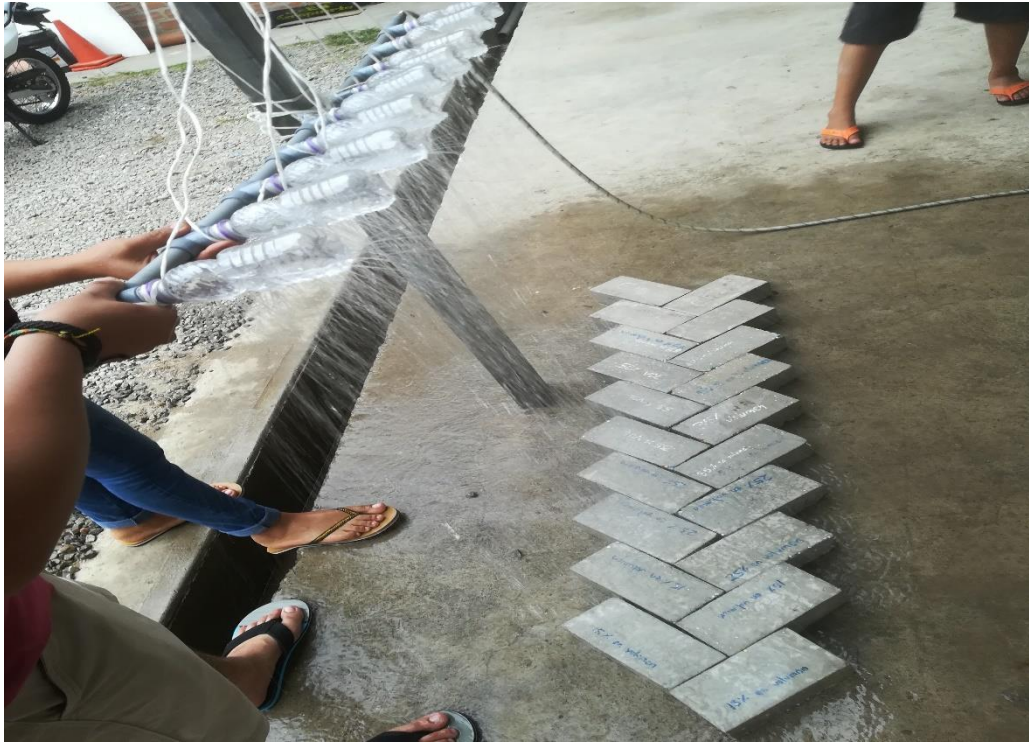
Foto 13. Ensayo de desgaste de concreto
