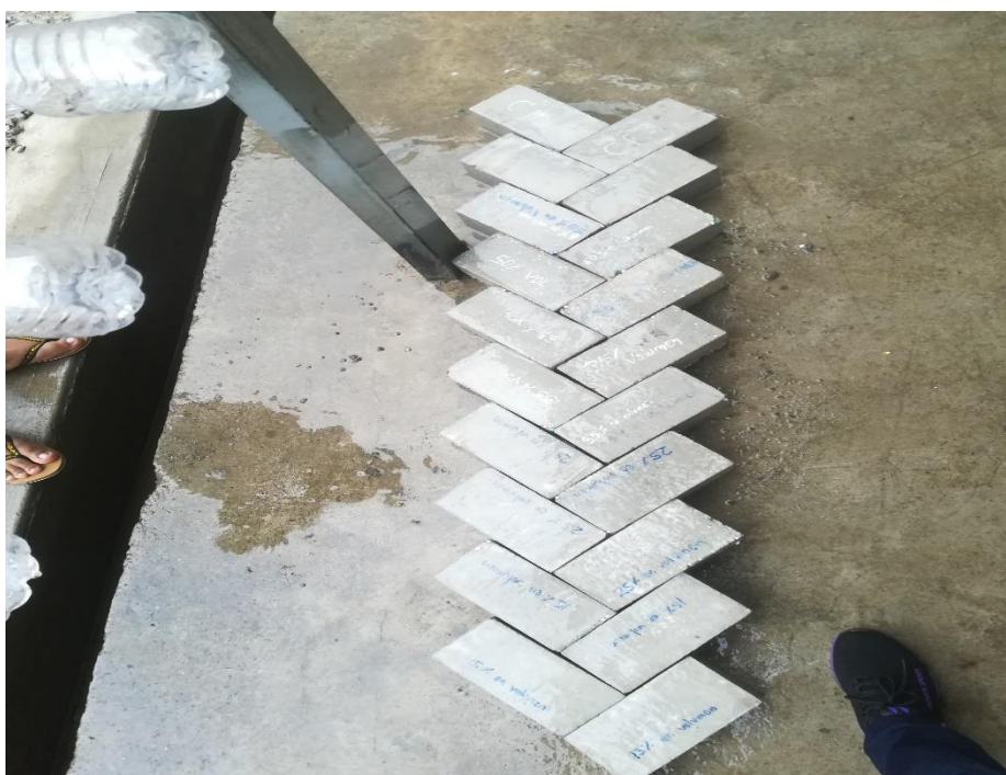
Foto 12. Apilado de adoquines de concreto para ensayo de desgaste
