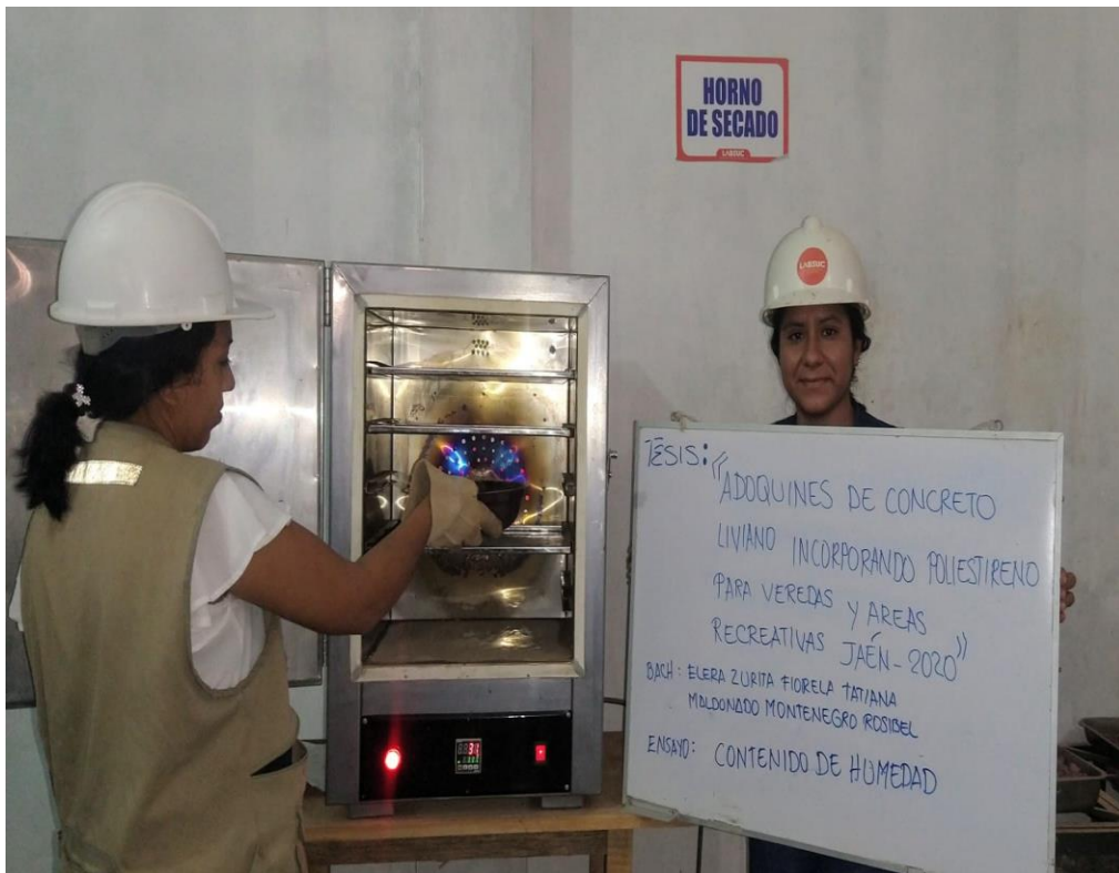
Foto 4. Secado de agregado fino
