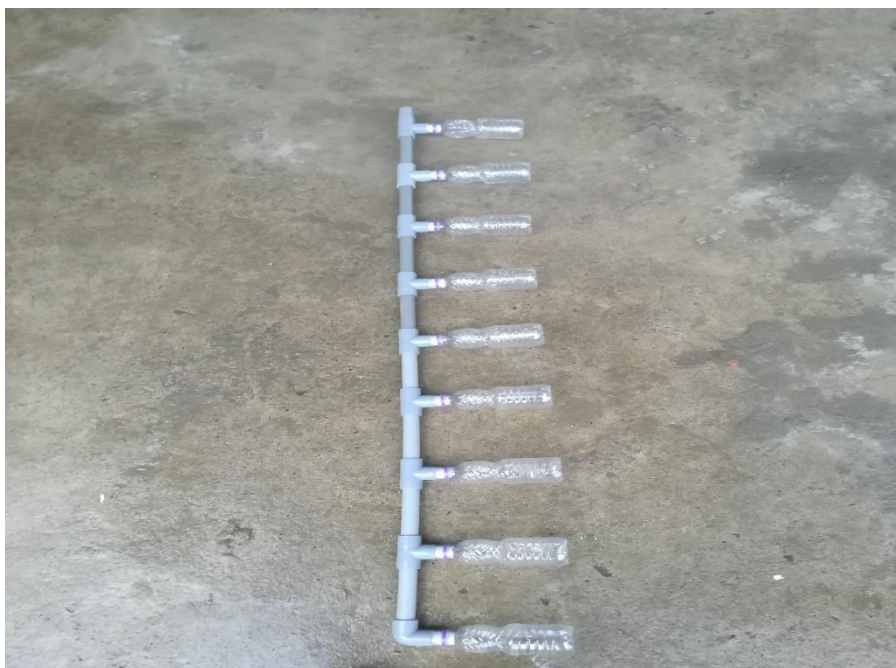
Foto 11. Equipo elaborado para el ensayo de desgaste
