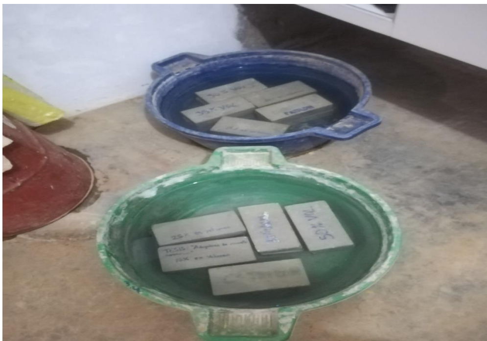
Foto 16. Adoquines de concreto sumergidos en agua
