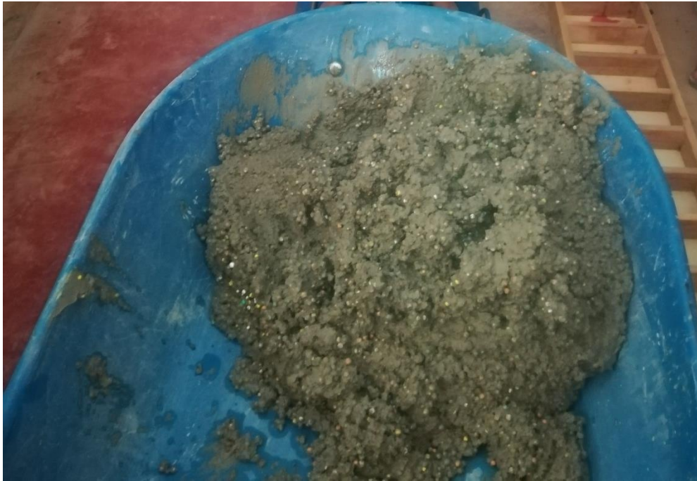
Foto 9. Concreto con adición de poliestireno
