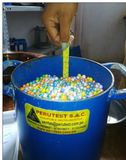
Figura 10. Medición de la cantidad de poliestireno
