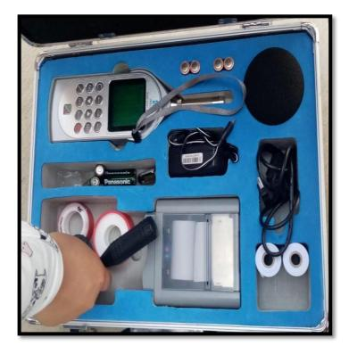
Fotografía 7. Maleta portátil del equipo sonómetro
