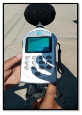
Fotografía 4. Instalación de sonómetro
