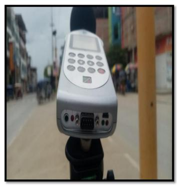
**Fotografía 8.** Instalación y orientación del equipo sonómetro en el punto de monitoreo
