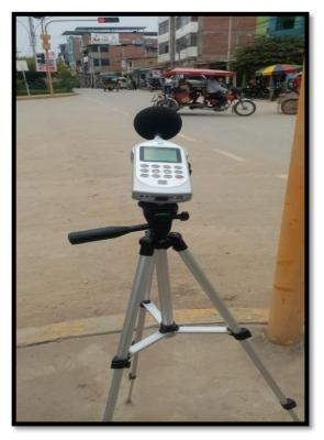
**Fotografía 3.** Sonómetro instalado en los puntos de monitoreo
