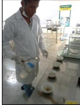
Nuevamente, las cápsulas de secado con el volumen de agua se sometieron a evaporación dentro de la estufa a 105 °C durante 45 minutos. Al cabo de ese tiempo, se dejó enfriar las cápsulas por 3 minutos dentro de un deshumecedor de vidrio y se procedió a pesar cada una de ellas, dentro de una balanza analítica determinándose el peso  $W_B$ .
