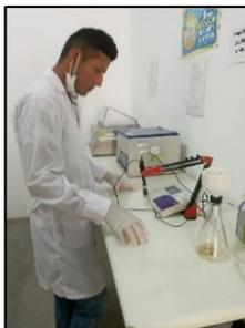
Y, por diferencia de pesos se logró determinar la concentración de los sólidos suspendidos.
