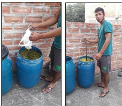
El proceso generó focos de calor y para distribuir mejor el contenido de energía al interior de ambos cilindros, se adaptó un agitador con tubería PVC.
