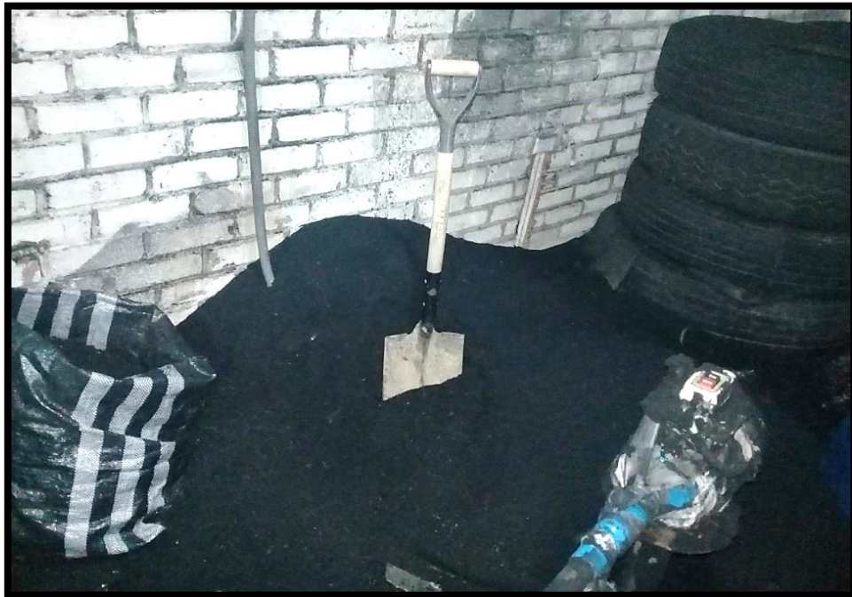
Recolección de fibra granular producto del esmerilado de neumáticos reencauchados
