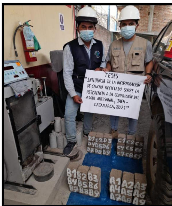
Rotulado de Probetas para ser ensayadas en laboratorio
