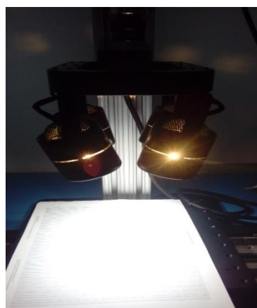
Figura 14. Medición de la reflectancia utilizando material de referencia.
