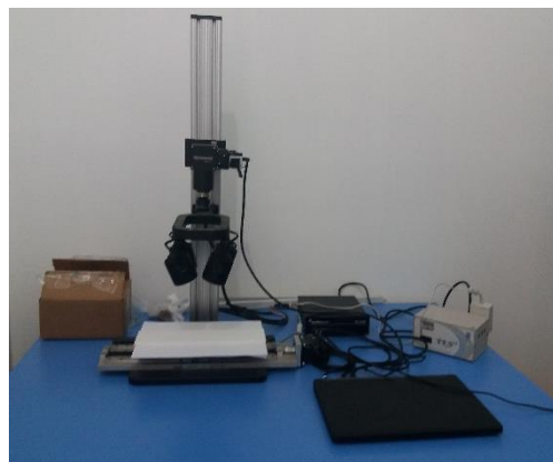
Figura 13. Imagen de la izquierda Hyperspectral imaging system. Manuel Resonon I. (2016) e imagen de la derecha equipo Resonon Pika L del Taller de laboratorio de la Facultad de Ingeniería de Industrias Alimentarias de la Universidad Nacional de Jaén.
