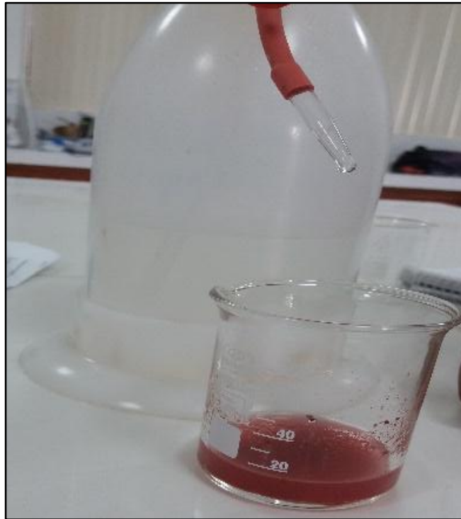
Figura. 33. Titulación para determinar la acidez de la zarzamora pintona
