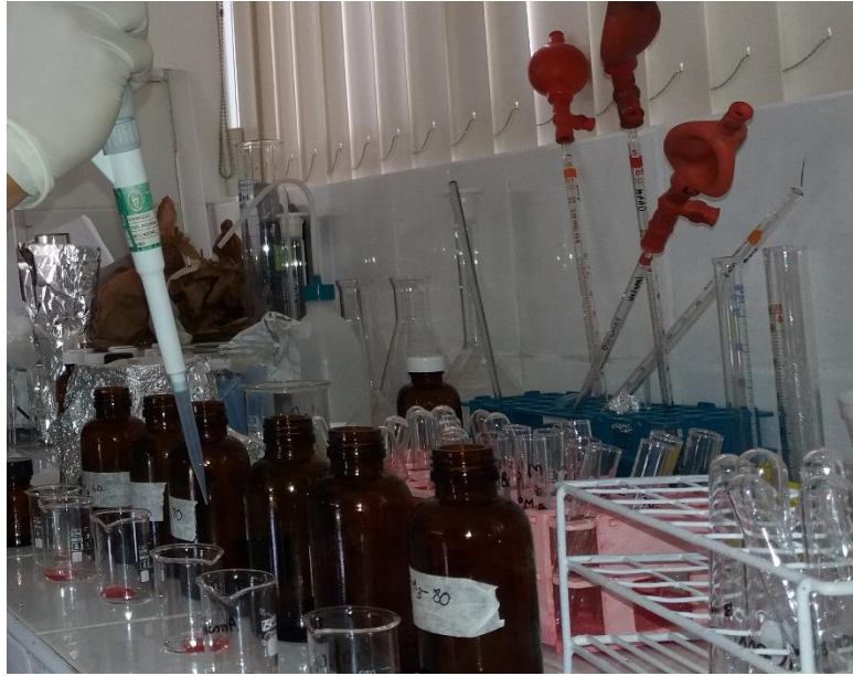
Figura. 30. Adición de 2ml de metanol en la muestra de 0.6 ml de mora para hacer nuestra solución A para la determinación del DPPH.
