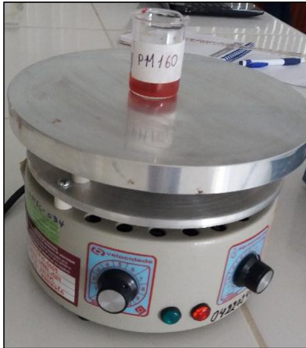
Figura. 19. Primera muestra de pulpa madura extrayendo fenoles a 60°C en un agitador magnético con temperatura
