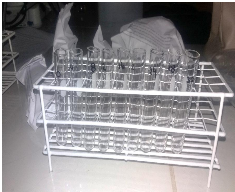
Figura. 23. Enumeración de tubos para el patrón de la curva del ácido gálico.
