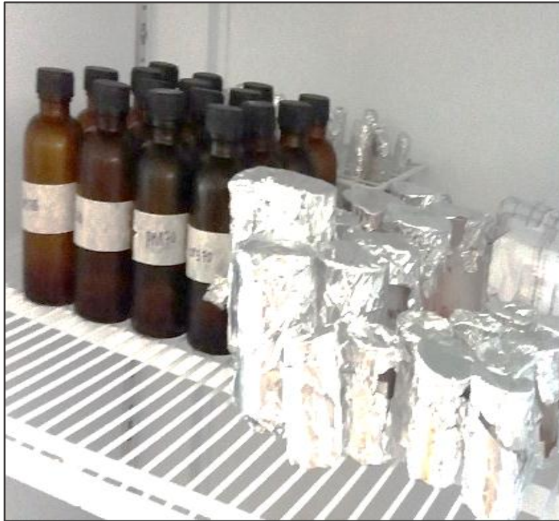
Figura. 22. Todas las muestras deben estar protegidas con papel aluminio y en frascos ámbar a una T de 4°C.
