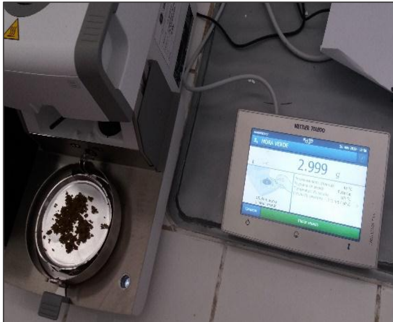
Figura. 35. Evaluando la muestra de la zarzamora verde en el analizador de humedad.
