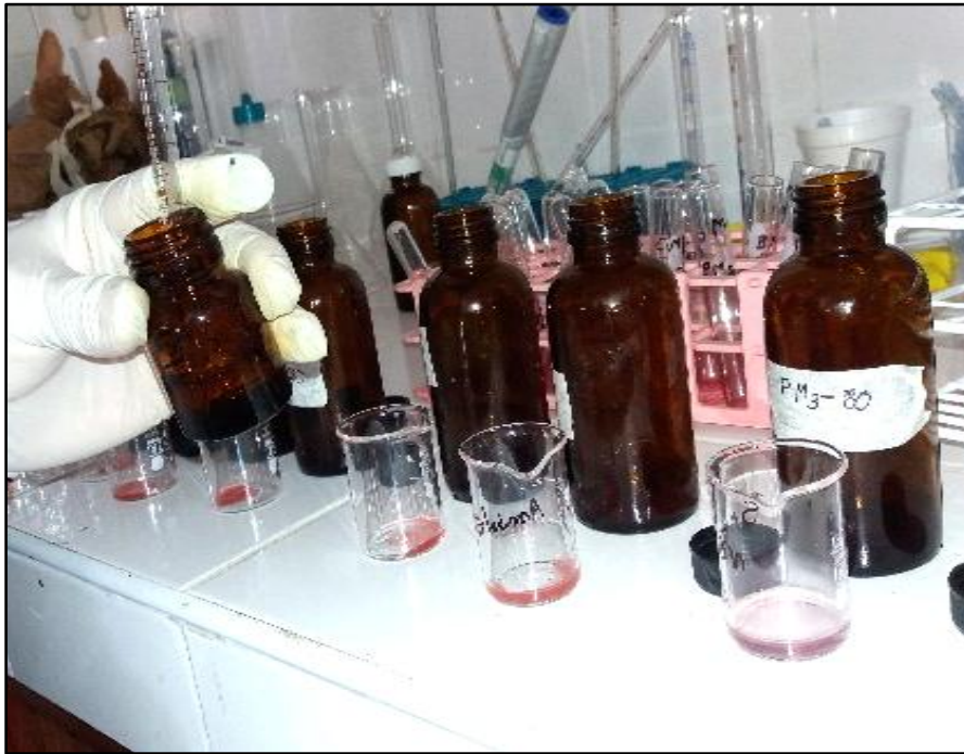
Figura. 28. Primera muestra de pulpa madura extrayendo fenoles a 80°C
