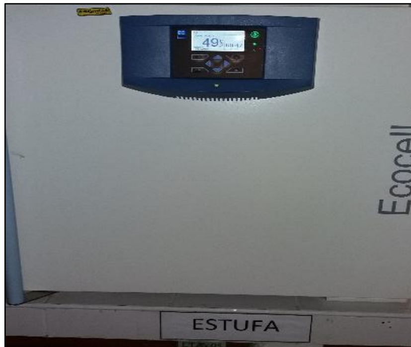
Figura. 25. Colocando la muestras a la estufa a 50°C por 5 min.
