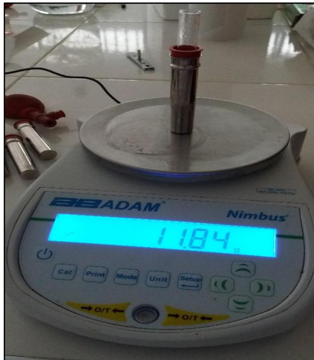
Figura. 18. Pesado de los tubitos para poner en la centrifuga
