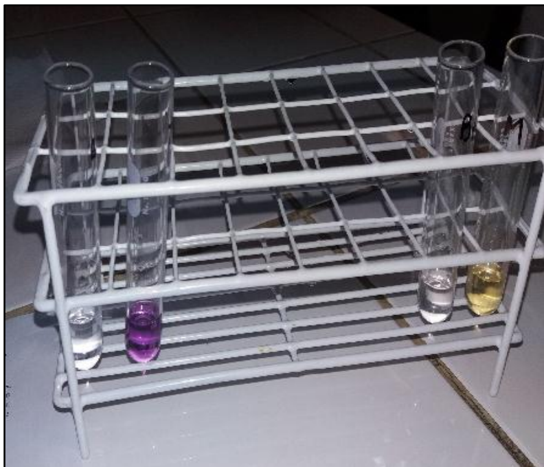
Figura. 31. Tubos de referencia de Blanco, Blanco de muestra, Muestra y el Testigo para medir el DPPH
