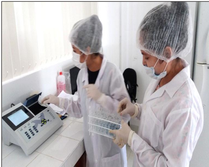
Figura. 27. Colocando la muestra las 4 muestras en el espectrofotómetro
