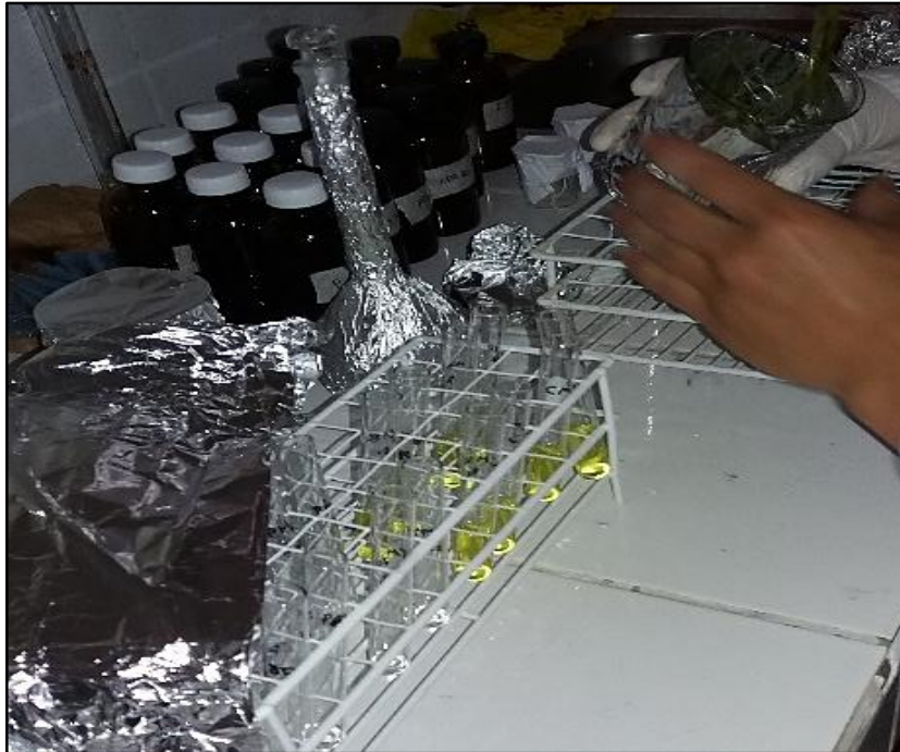
Figura. 24. Agregando el folin diluido para poder determinar nuestros fenoles
