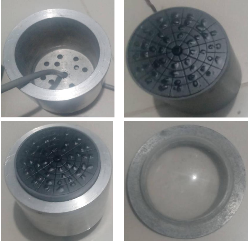
Figura 7. Diseño de la cubierta del prototipo de piranómetro
