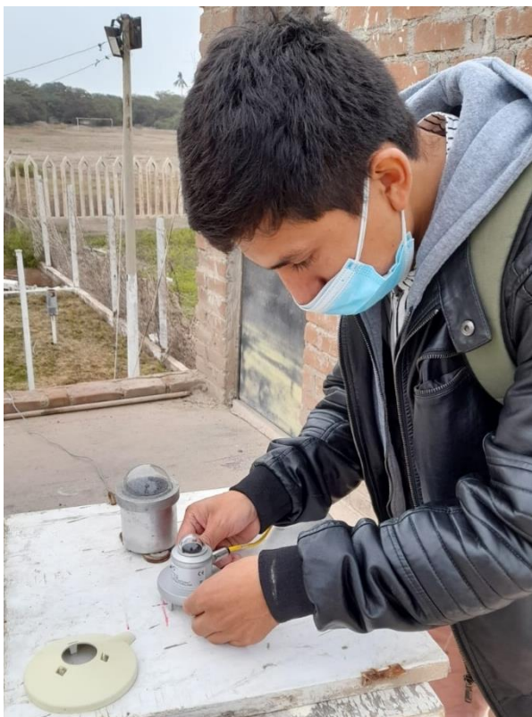
Anexo E: Instalando el piranómetro Modelo CMP3
