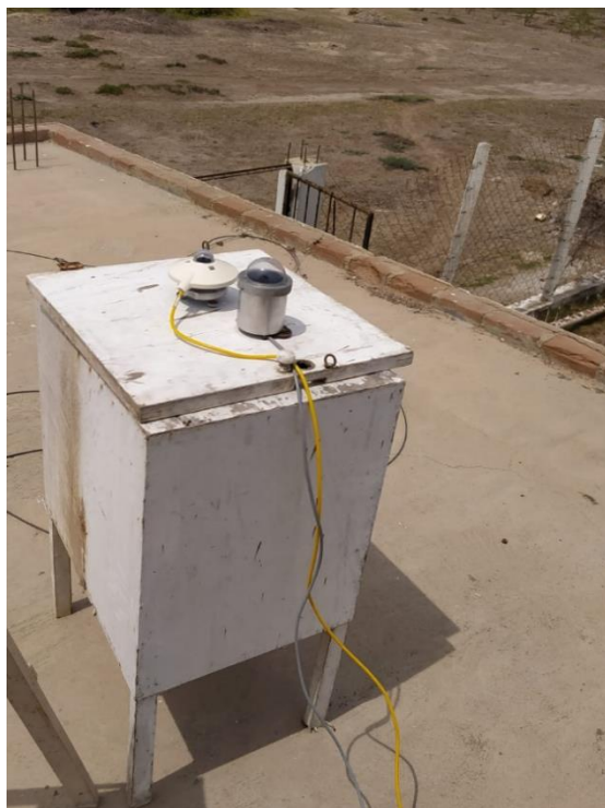
Figura 4. Instalación del prototipo y piranómetro Modelo CMP3
