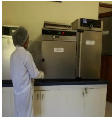
Figura 32. Estufa, para secado de granos frescos
