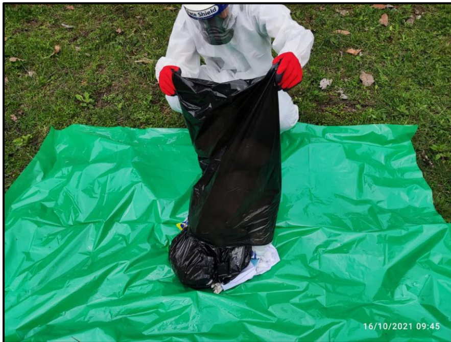
Panel Fotográfico 26. Vertido de los residuos para su caracterización.
