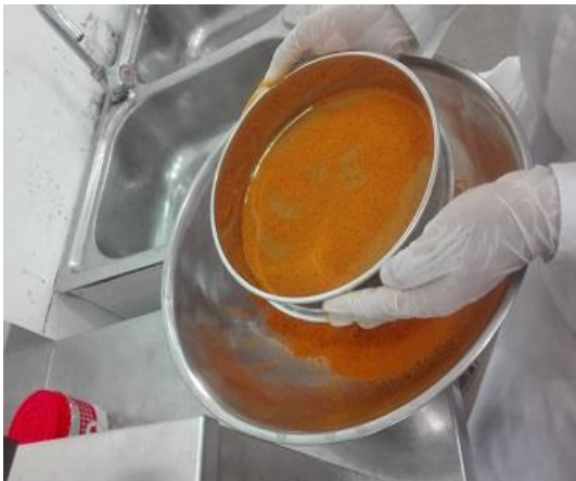
Fotografía 15. Tamizado de la cúrcuma molida para la obtención de harina.
