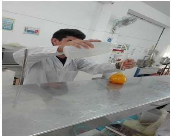
Fotografía 33. Enrase de una fiola con agua destilada.
