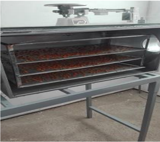
Fotografía 7. Vista frontal de la cámara de secado junto con la balanza de triple brazo.
