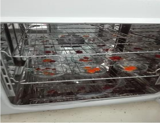
Fotografía 30. Determinación de la humedad por el método de la estufa.
