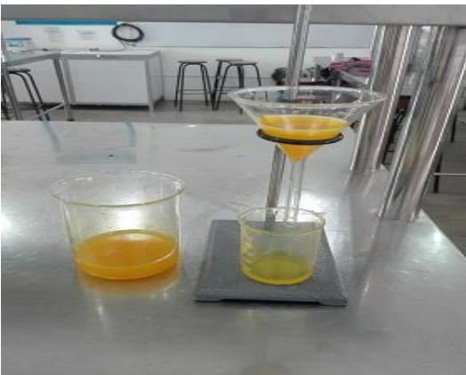
Fotografía 32. Filtrado de la muestra del rizoma de cúrcuma para determinación de acidez titulable.
