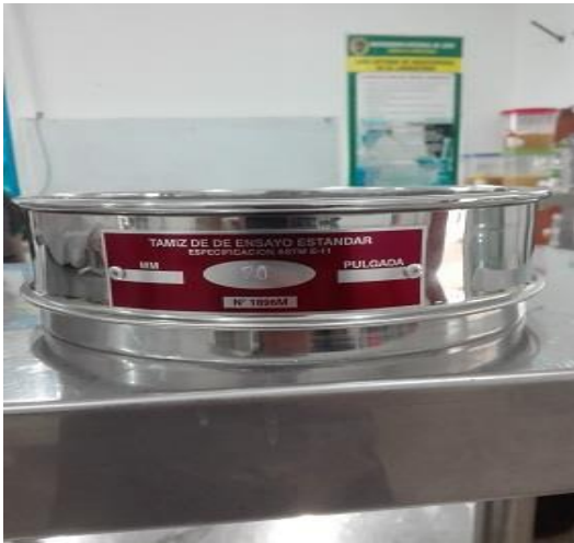
Fotografía 13. Tamiz, malla de malla n° 70 y 220 micrones.
