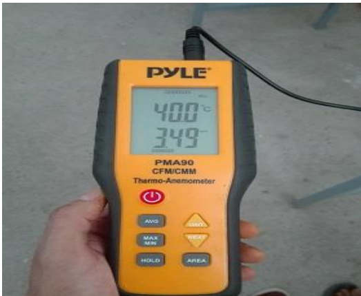
Fotografía 23. Anemómetro regulador de la velocidad de aire de secado.
