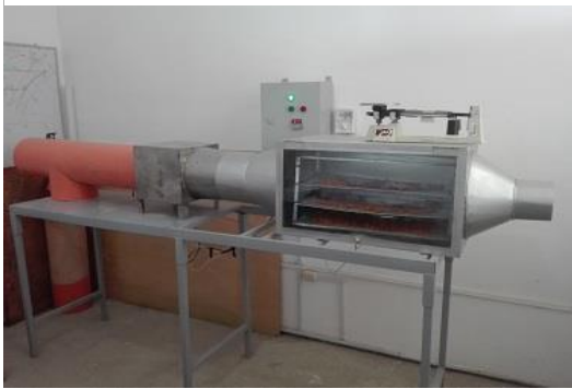
Fotografía 21. Secador de bandejas en el laboratorio de Deshidratación.
