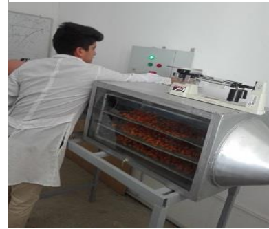
Fotografía 22. Control de peso de rodajas de cúrcuma.
