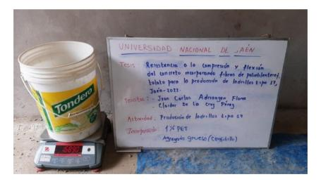
**Figura 46**Peso del cemento para la realización de la mezcla
