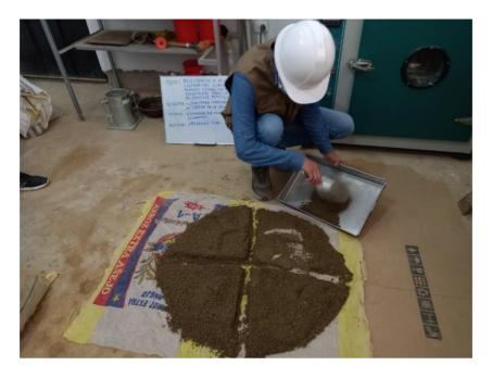
**Figura 37**Selección del agregado grueso después del cuarteo
