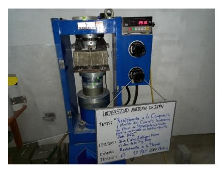
**Figura 73**Resistencia a la flexión L3 al incorporar 1.5 % PET
