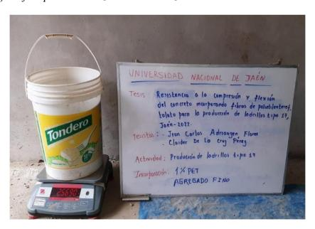
**Figura 44**Peso del cemento para la realización de la mezcla
