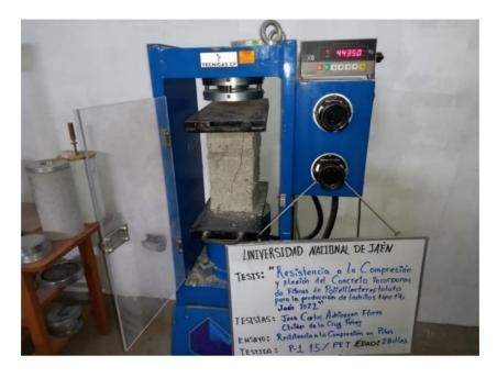
**Figura 69**Resistencia a la compresión en pilas P4 al incorporar 2 % PET
