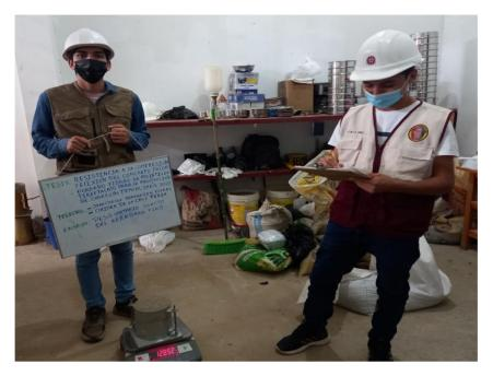
3.7.4.2.4. Peso unitario compactado del agregado fino (NTP 400.017, 2011)
