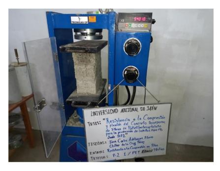
**Figura 67**Resistencia a la compresión en pilas
