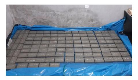
**Figura 56** *Elaboración de pilas con ladrillos tipo 17*
