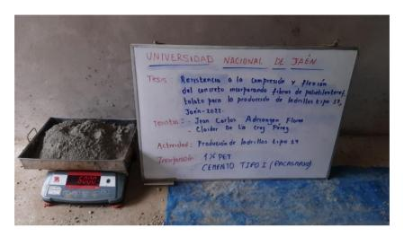
**Figura 45**Peso del agregado grueso para la realización de la mezcla
