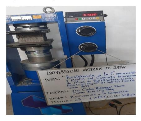
**Figura 61**Resistencia a la compresión de ladrillos tipo 17
