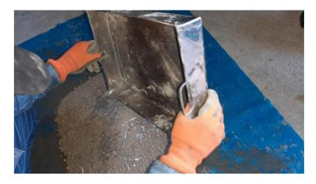
**Figura 49**Mezclado de fibras PET con agregado fino
