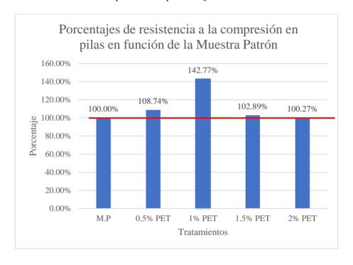
Nota. Se muestra los resultados en porcentajes de la resistencia a la compresión en pilas en función a la muestra patrón luego de 28 días. Fuente: Elaboración propia
