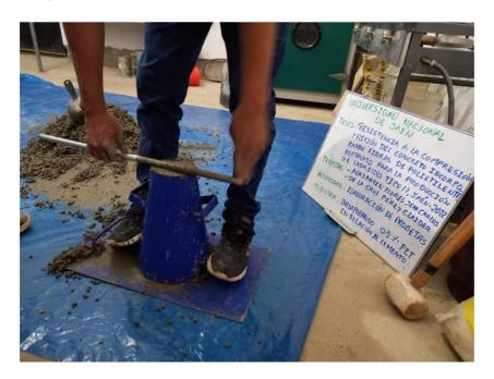
**Figura 52** *Medición del asentamiento del concreto*
