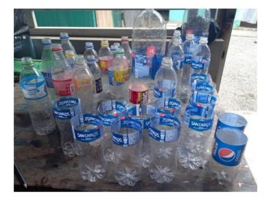
Se realizó el cortado de las botellas de plástico de la parte superior e inferior para facilitar y homogenizar el proceso de obtención de las fibras rectangulares, luego se midió y cortó con una longitud 30 mm y ancho de 4 mm, hasta que se logró la cantidad necesaria.
