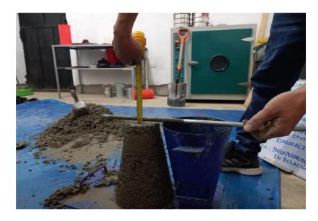
**Figura 53**Nivelación del concreto en el molde para producir ladrillos tipo 17
