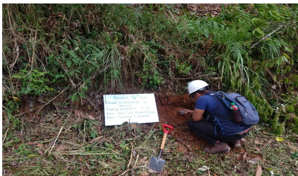
FOTOGRAFIA 02: Se Aprecia La Ejecución Del Ensayo Usando Penetrómetro De Bolsillo Realizado En Trincheras P - 8
