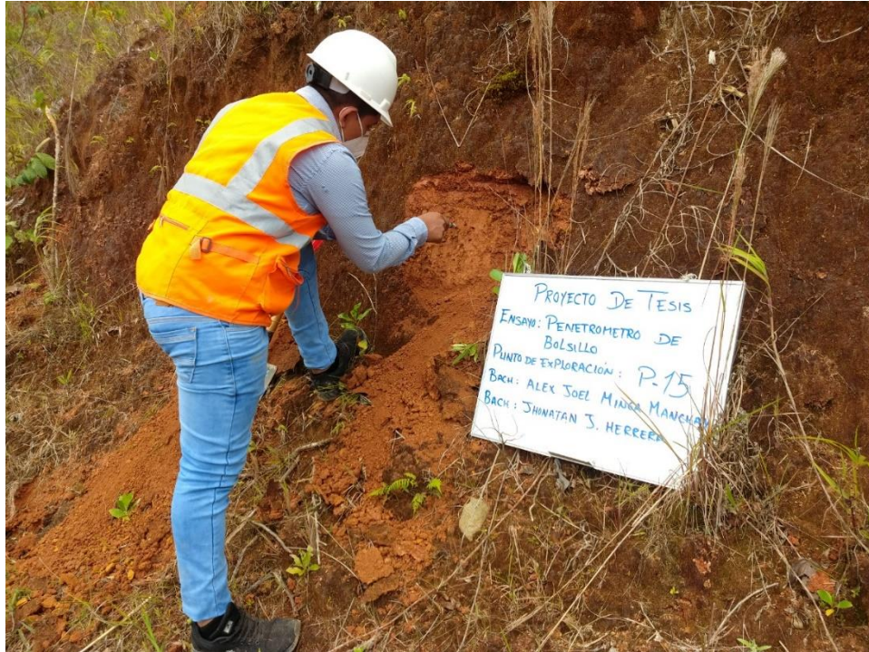
FOTOGRAFIA 03: Se Aprecia La Ejecución Del Ensayo Usando Penetrómetro De Bolsillo Realizado En Trinchera P – 15
