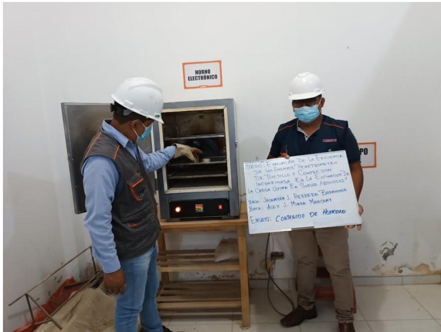
FOTOGRAFIA 09: Se Aprecia La Ejecución Del Ensayo Contenido de Humedad según la Norma NTP. 339.127.
