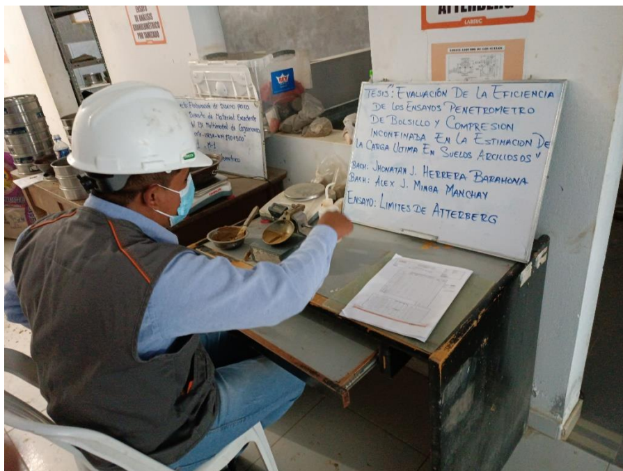
FOTOGRAFIA 08: Se Aprecia La Ejecución Del Ensayo Límites de Atterberg según la Norma NTP. 339.129.
