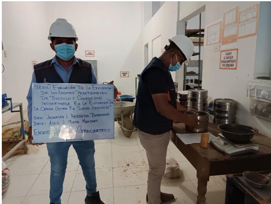
FOTOGRAFIA 07: Se Aprecia La Ejecución Del Ensayo Análisis Granulométrico según la Norma NTP. 339.128.
