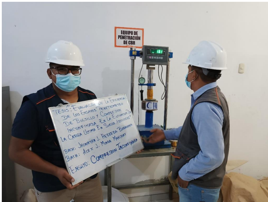
FOTOGRAFIA 12: Se Aprecia La Ejecución Del Ensayo Compresión Inconfinada, en Tipo de suelos CH, según la Norma NTP. 339.167.
