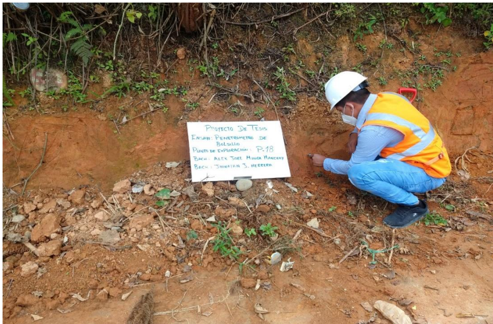
FOTOGRAFIA 04: Se Aprecia La Ejecución Del Ensayo Usando Penetrómetro De Bolsillo Realizado En Trinchera P - 18
