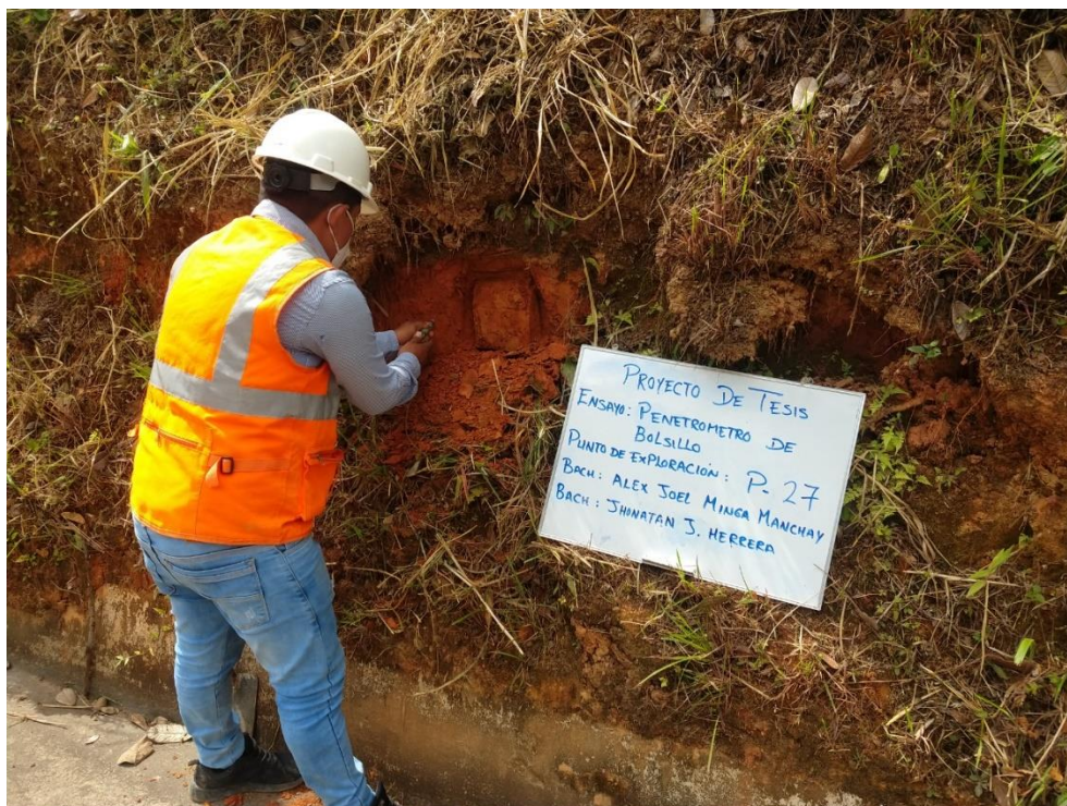
FOTOGRAFIA 05: Se Aprecia La Ejecución Del Ensayo Usando Penetrómetro De Bolsillo Realizado En Trinchera P – 27
