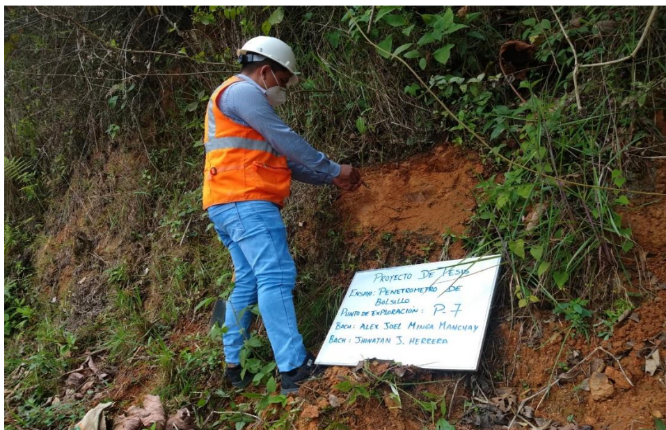
FOTOGRAFIA 01: Se Aprecia La Ejecución Del Ensayo Usando Penetrómetro De Bolsillo Realizado En Trincheras P – 7
