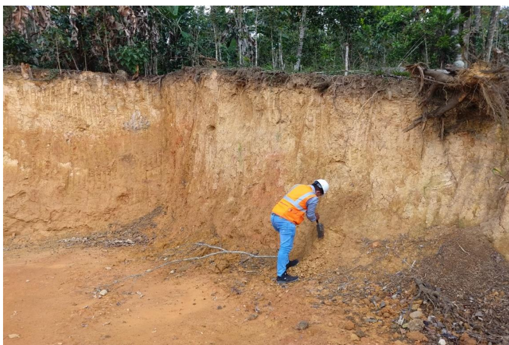
FOTOGRAFIA 06: Se Aprecia La Toma De Muestras Para Ser Llevadas A Laboratorio Para Su Clasificación De Suelos Respectiva
