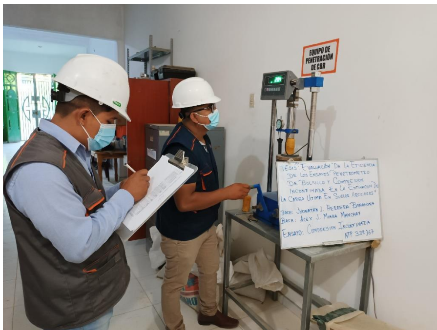
FOTOGRAFIA 10: Se Aprecia La Ejecución Del Ensayo Compresión Inconfinada según la Norma NTP. 339.167.
