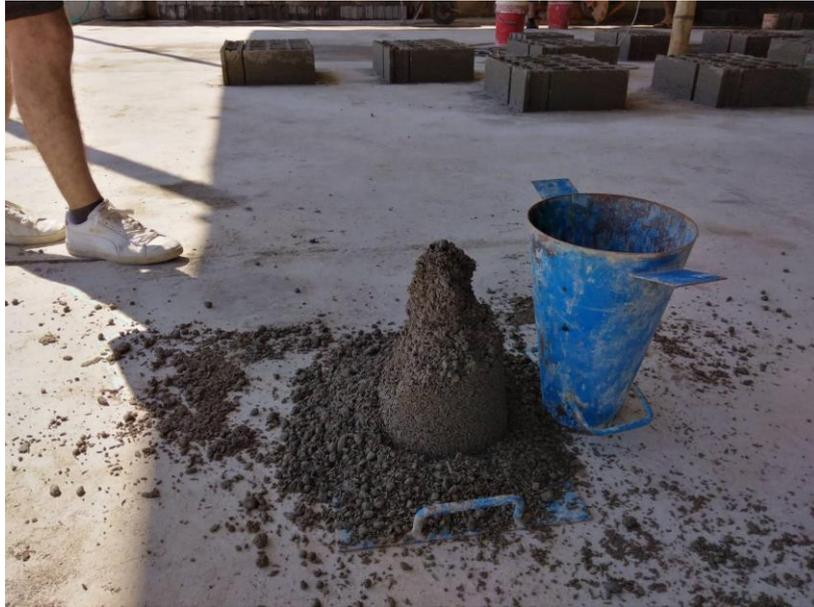
Imagen N°03. Ensayo de Slump a la mezcla de concreto.
