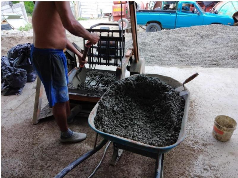
Imagen N°04. Colocación de la mezcla a la máquina bloquera.
