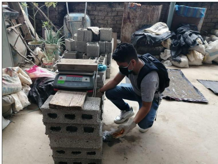
Figura 21. *Determinación del peso del bloque sumergido en agua.*
