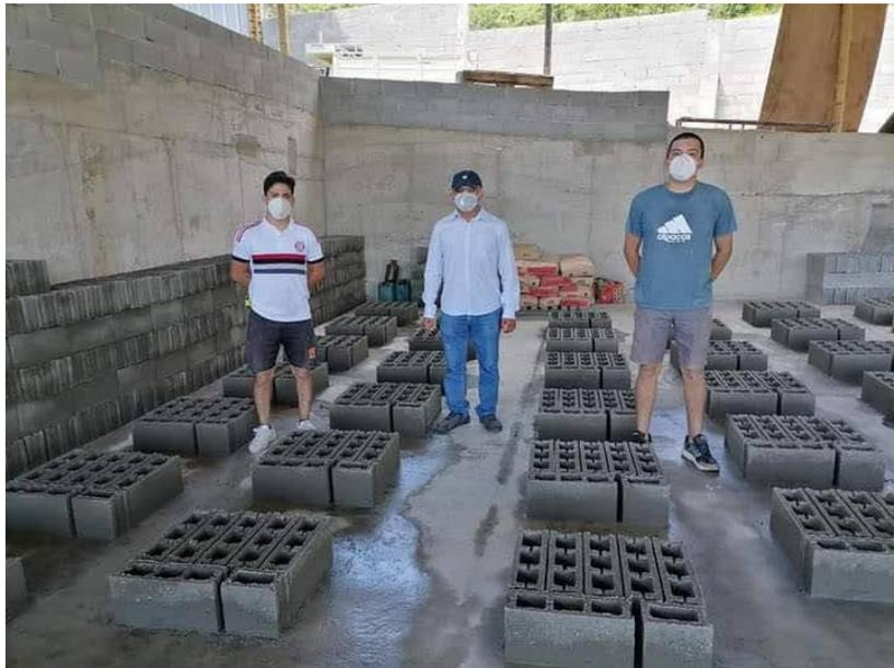
Imagen N°06. Vista general de los bloques de concreto elaborados.
