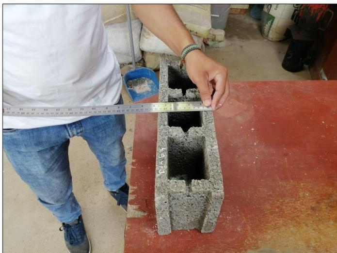
Figura 15. *Midiendo la variación del bloque de concreto.*
