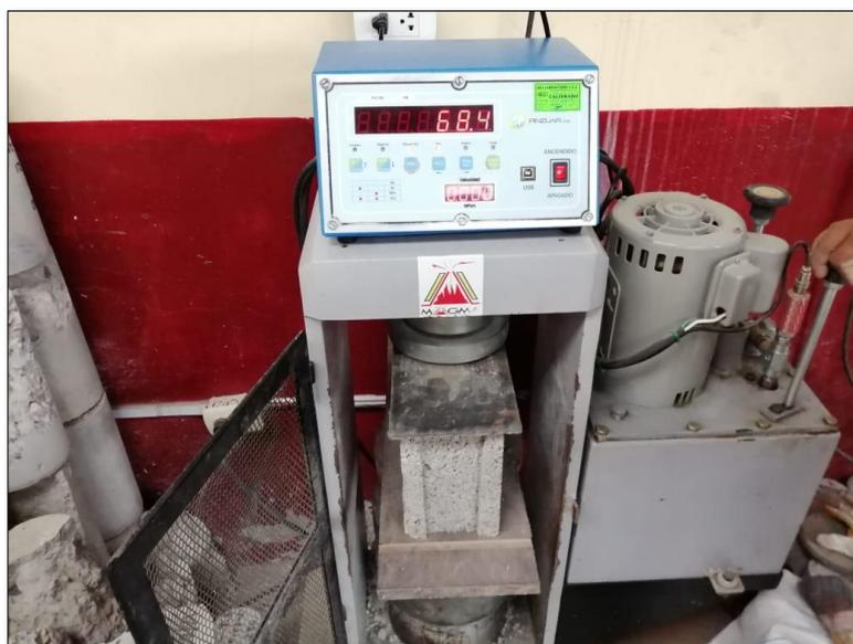
Figura 19. Bloque de concreto siendo sometido al ensayo de compresión.
