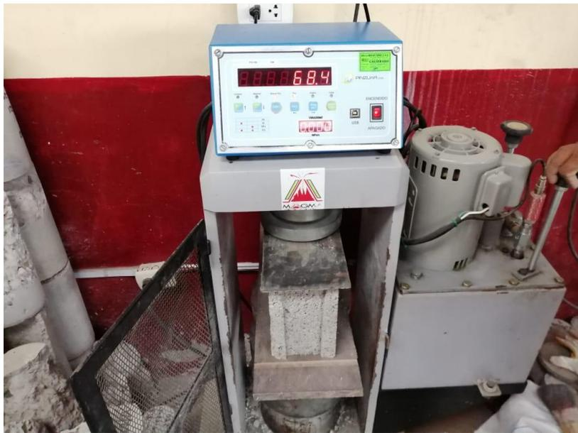
Imagen N°10. Ensayo de resistencia a compresión.
