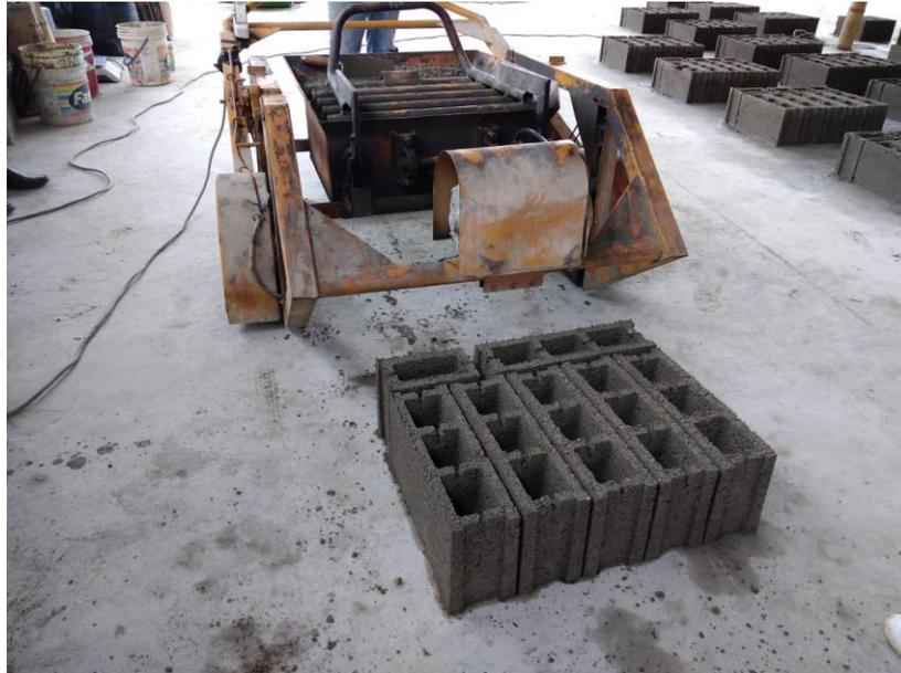
Imagen N°05. Bloques de concreto retirados de la máquina bloquera.
