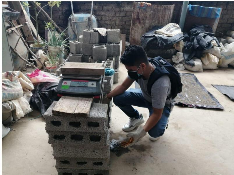
Imagen N°12. Ensayo de densidad.
