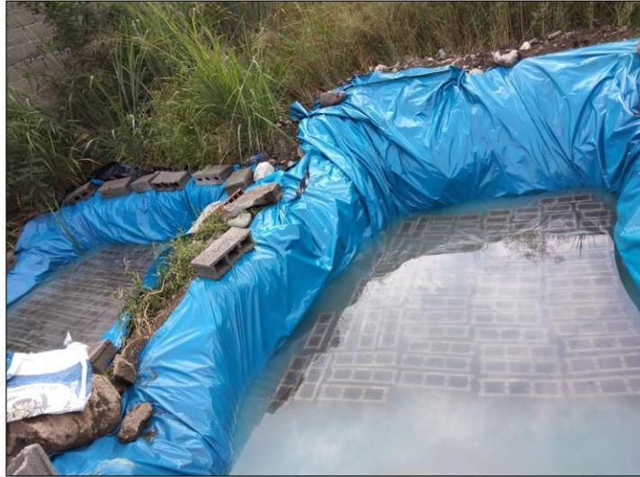
Figura 11. Pozas de curado donde se colocaron los bloques de concreto
