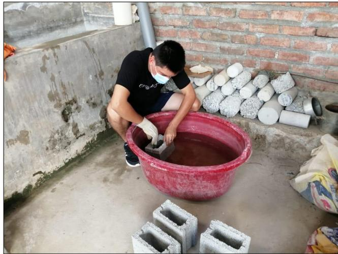
Figura 17. Colocación de los bloques de concreto en agua por 24 horas.
