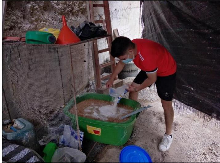
Figura 4. *Añadiendo cal a la mezcla de agua con cascarilla de arroz.*
