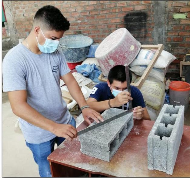
Figura 13. *Medición del alabeo de los bloques de concreto.*
