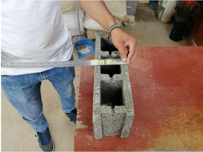
Imagen N°09. Ensayo de variación dimensional.
