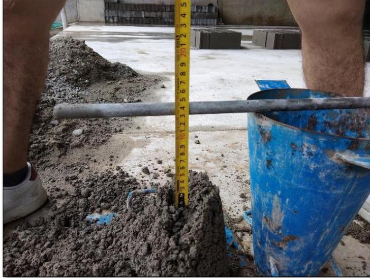
Figura 8. *Medición del asentamiento en la mezcla de concreto.*
