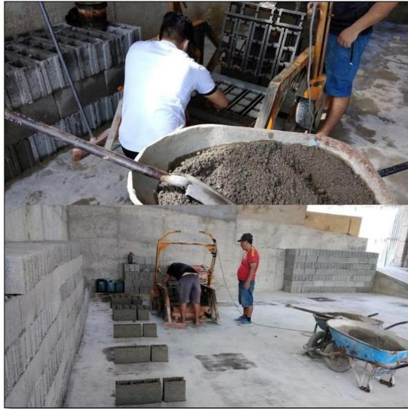
Figura 10. *Colocación de la mezcla de concreto en la máquina bloquera.*
