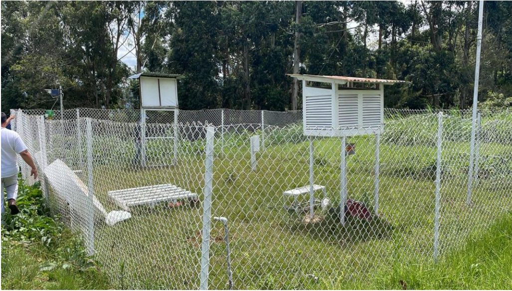
Estación meteorológica instalada por Senamhi
