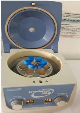
Imagen N° 4 y 5: Centrifugado del Mucílago
