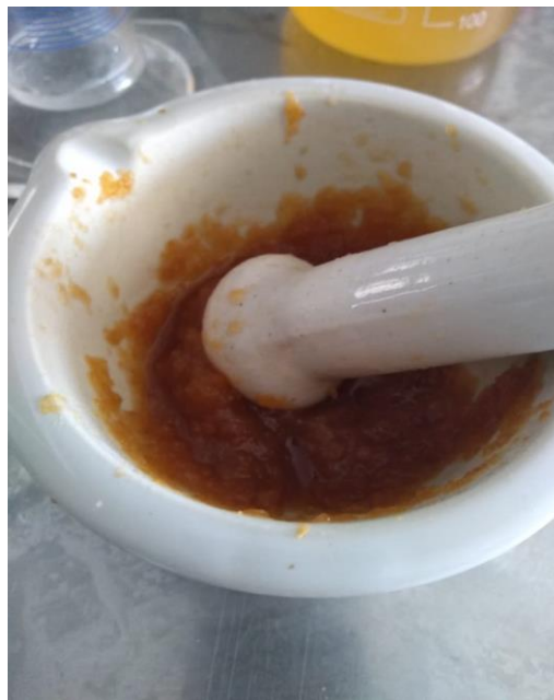
Imagen N° 18: Triturado de las manzanas con diferentes RC para la evaluación de °Brix y pH.
