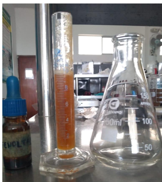
Imagen N° 20 Fenolftaleína, muestra de manzana para la titulación.
