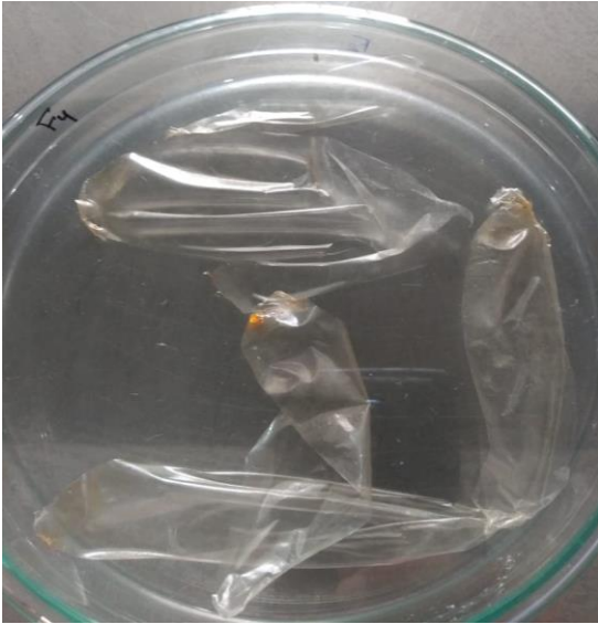
Imagen N° 14: Recubrimiento Comestible de Mucilago de café
