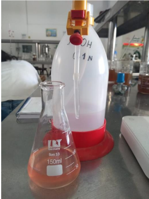
Imagen N° 21: Titulación para determinar % Acidez
