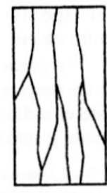
Tipo 3 Fisuras verticales encolumnadas a través de ambos extremos, conos no bien formados
