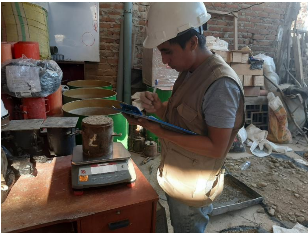
Foto 36: Toma de peso de las muestras compactadas con PET al 1.55, 3.0% y 6.0%.
