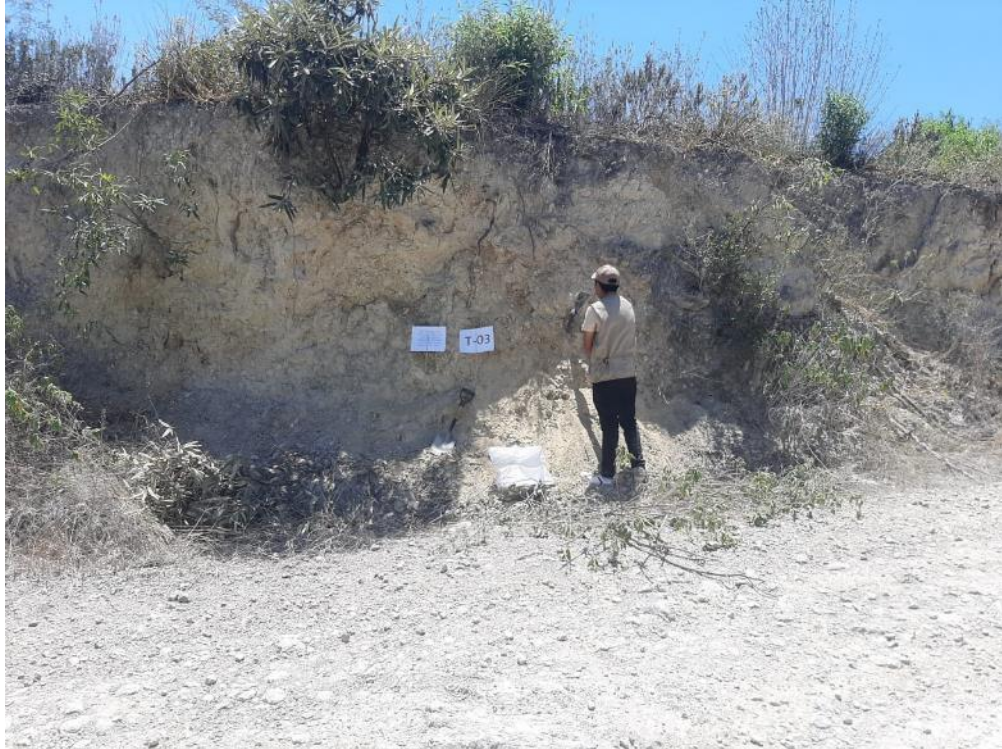
Foto 03: Trabajos para la toma de muestras de Trinchera 03 de la Carretera Mochenta – San Nicolas, progresivo km 3+000, margen izquierdo.
