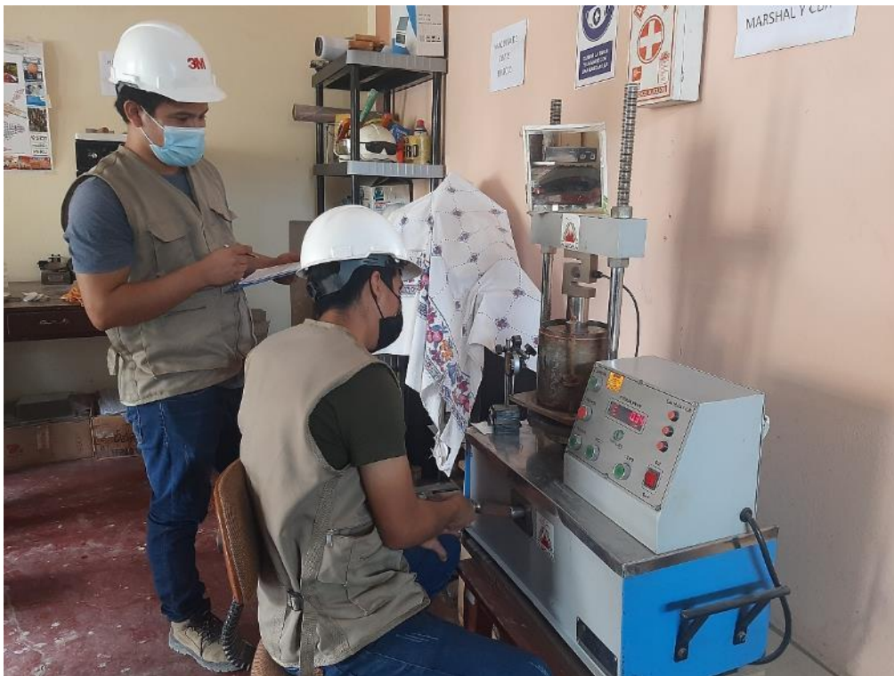
Foto 40: Determinación del valor relativo de soporte - CBR de las muestras con distintos porcentajes 1.5%, 3.0% y 6.0 de PET.
