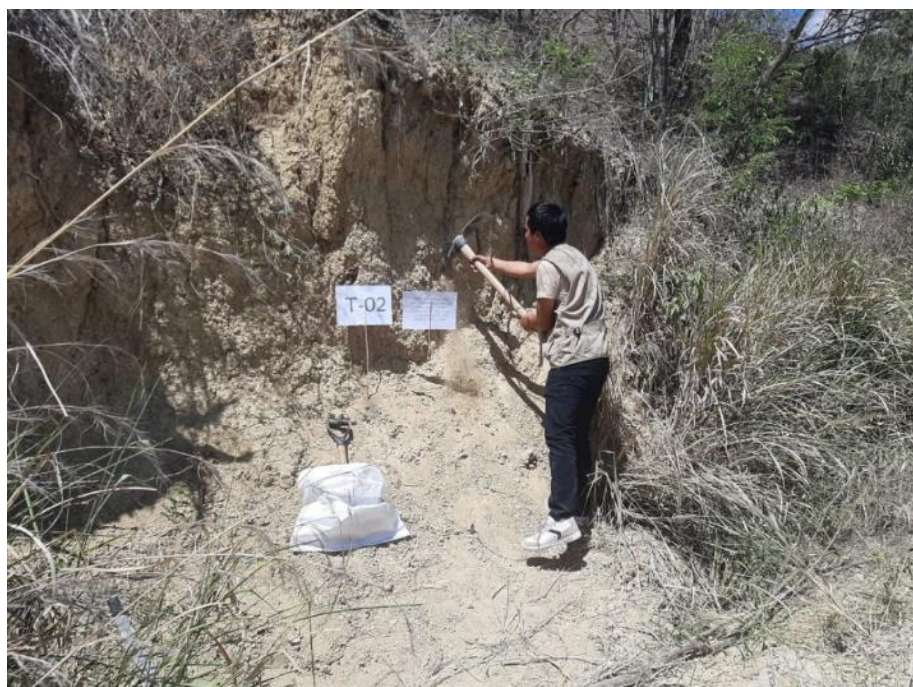
Foto 02: Trabajos para la toma de muestras de Trinchera 02 de la Carretera Mochenta – San Nicolas, progresivo km 2+084, margen izquierdo.
