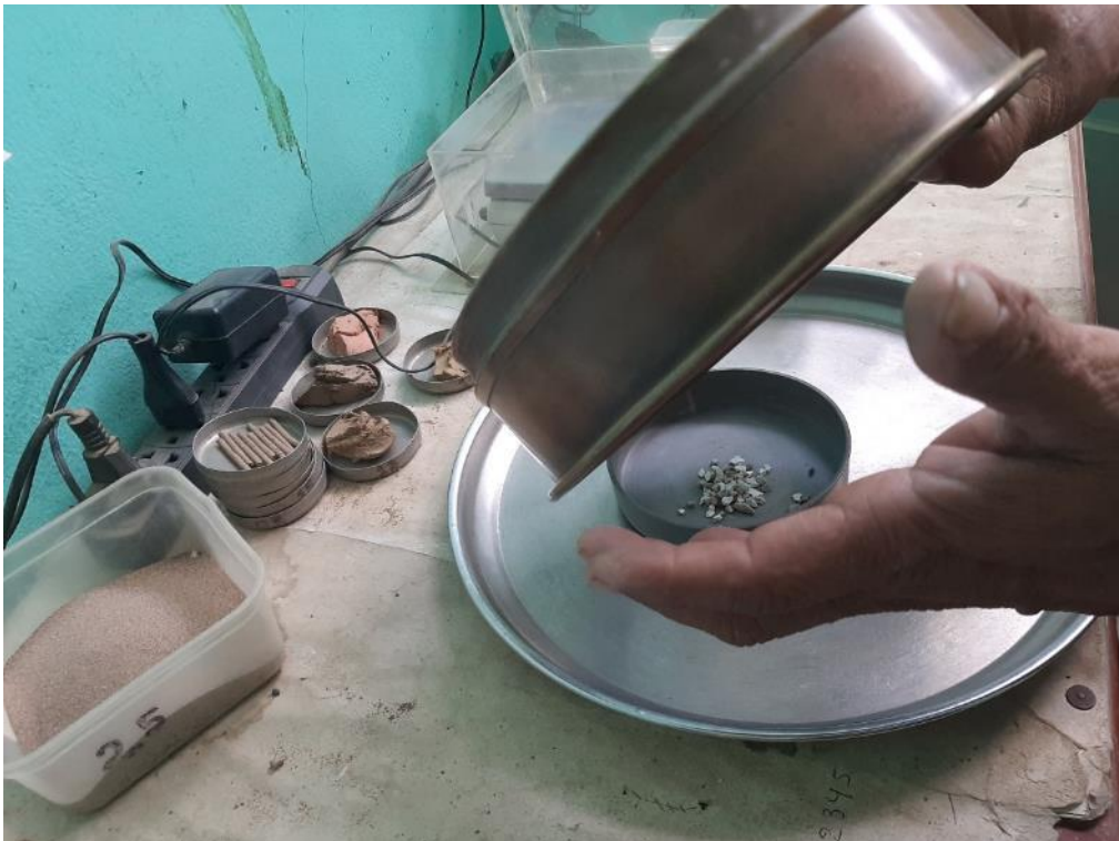
Foto 08: Pesos de suelo retenido en diferentes tamices del ensayo de Granulometría.
