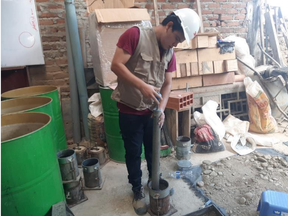
Foto 33: Compactación del suelo más PET 1.5%, CBR - Tercera repetición.
