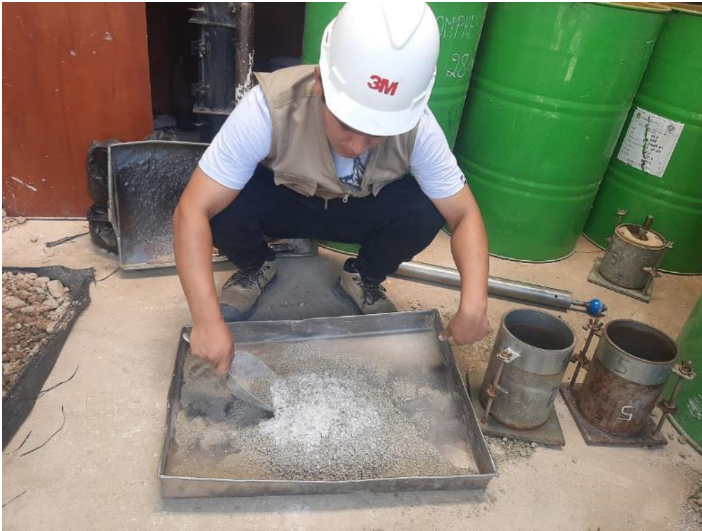
Foto 23: Mezcla del Suelo Tipo A-6 con el PET al 6.0% en relación al peso del suelo natural.
