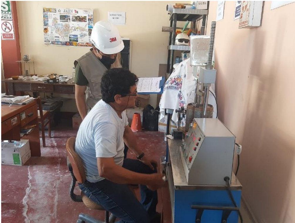
Foto 39: Determinación del valor relativo de soporte - CBR de las muestras con distintos porcentajes 1.5%, 3.0% y 6.0 de PET.
