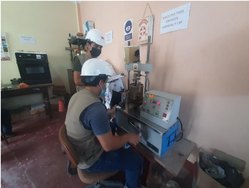
Foto 41: Determinación del CBR de las muestras con distintos porcentajes 1.5%, 3.0% y 6.0 de PET.
