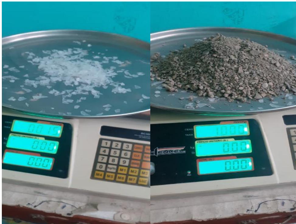
Foto 44: Peso y mezcla del suelo para realizar Granulometría con distintos porcentajes de PET (1.5%, 3.0% y 6.0%).
