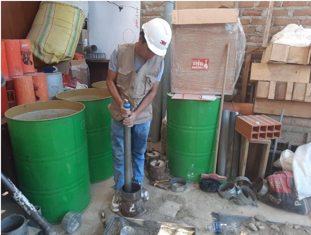
Foto 35: Compactación del suelo más PET 6.0%, CBR - Tercera repetición.
