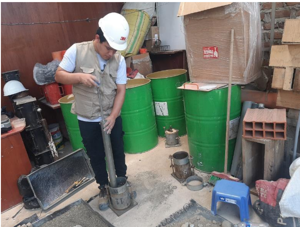
Foto 24: Compactación del suelo más PET 6.0%, CBR-Primera repetición.
