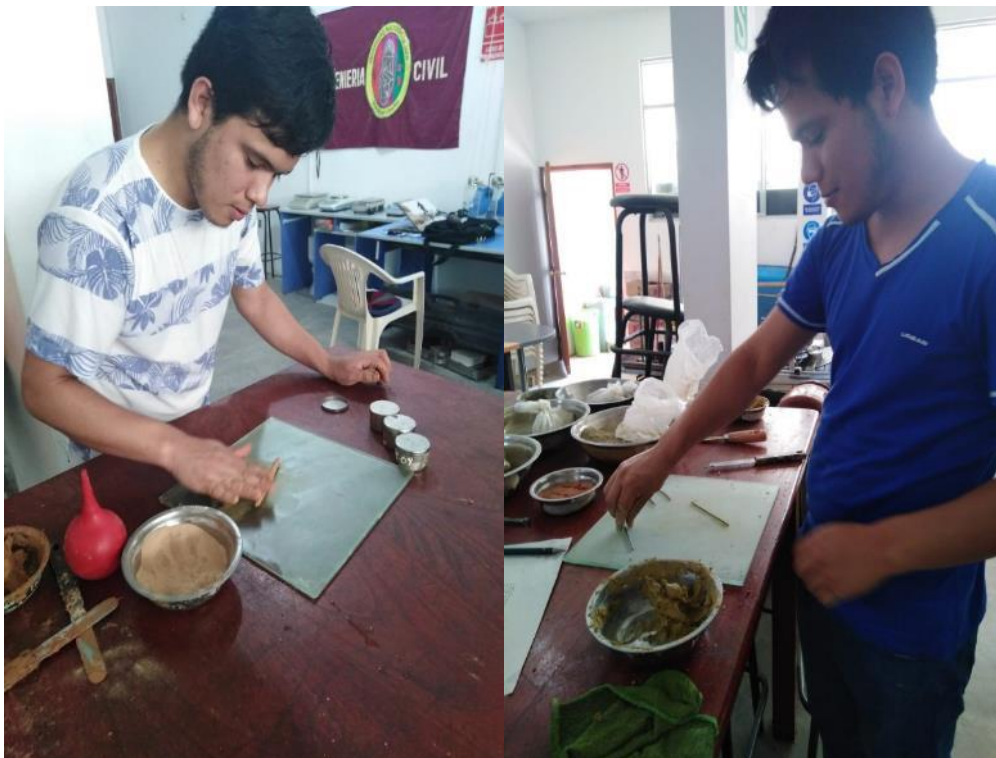
Foto 12: Formación de cilindros delgados para la determinación del límite plástico.
