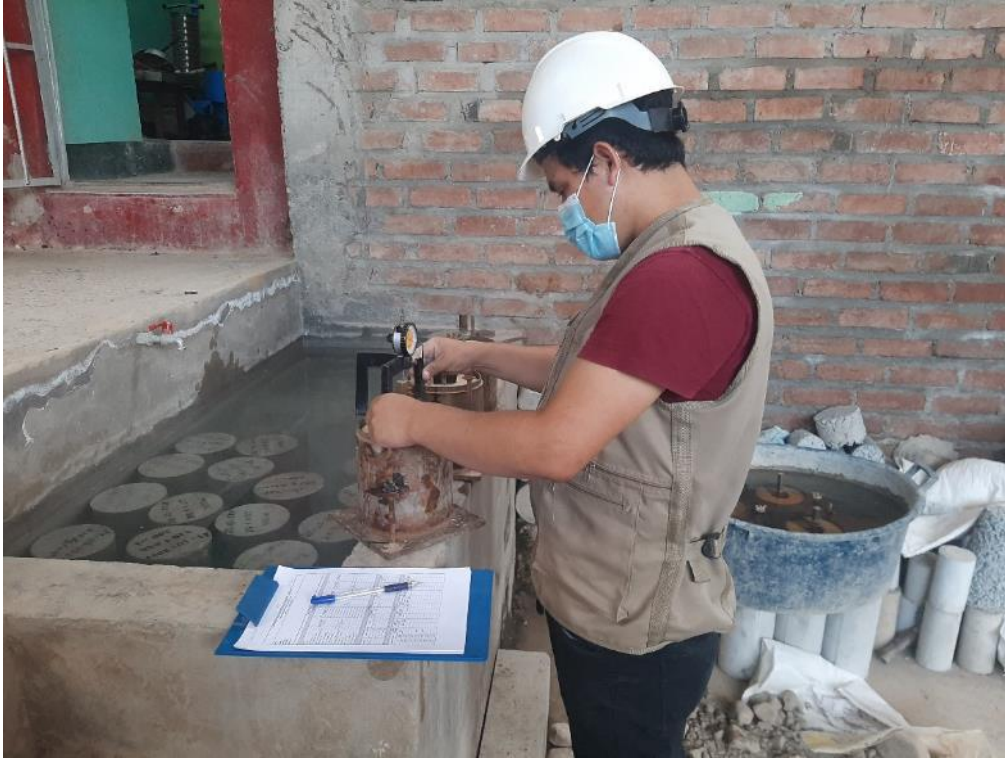
Foto 37: Toma de lectura del dial y colocación al agua de las muestras compactadas con PET al 1.55, 3.0% y 6.0%.
