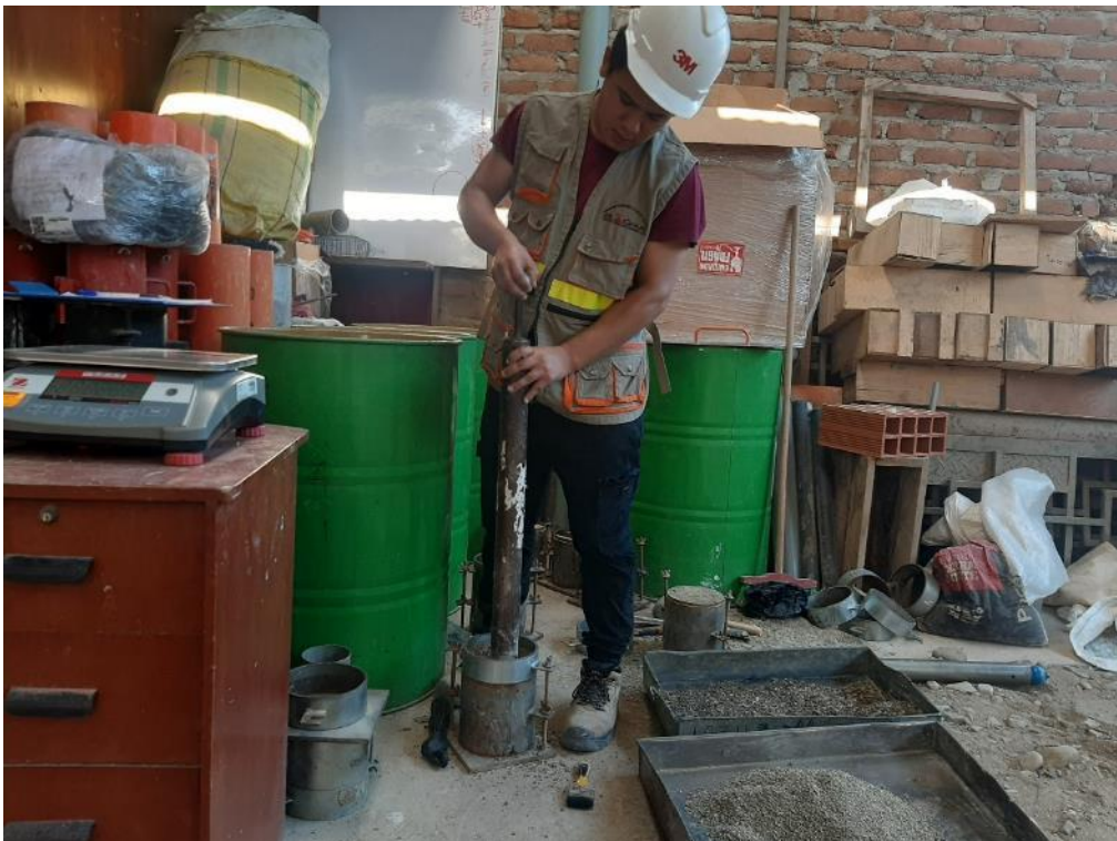
Foto 34: Compactación del suelo más PET 3.0%, CBR - Tercera repetición.
