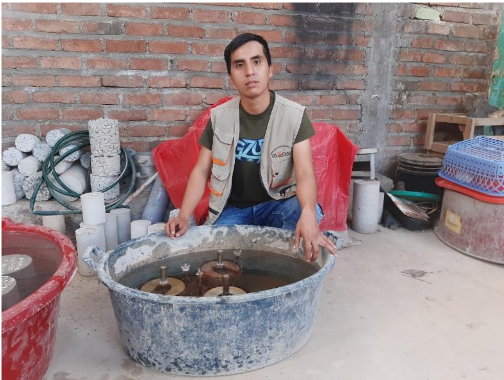
Foto 16: Sumergimiento de las muestras del CBR en agua, a fin de medir el hinchamiento.
