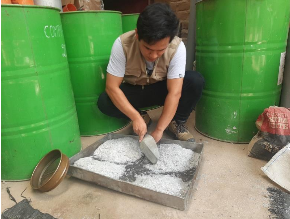
Foto 17: Cuarteo del PET, para ser mezclado con el suelo tipo A-6.
