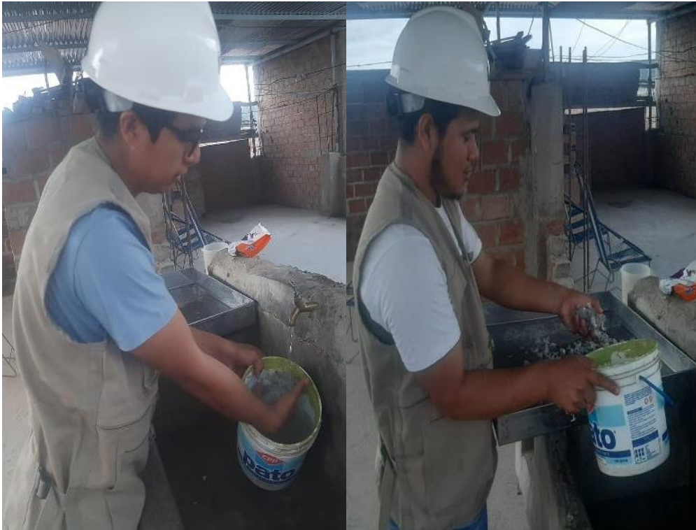
Foto 51: Lavado del Polietileno Tereftalato (PET) y secado a temperatura ambiente en una bandeja de aluminio.
