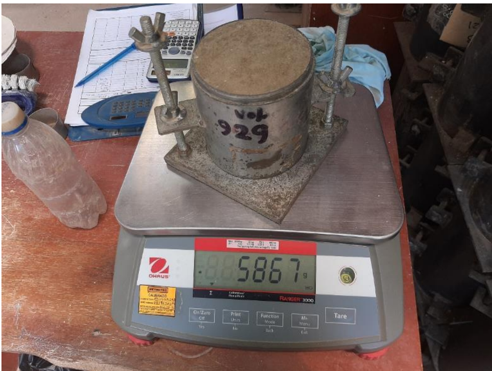
Foto 14: Peso del material compactado en la prueba del Proctor modificado.
