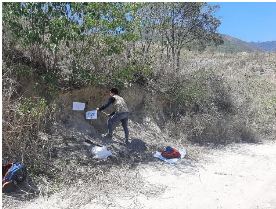
Foto 01: Trabajos para la toma de muestras de Trinchera 01 de la Carretera Mochenta – San Nicolas, progresivo km 2+068, margen izquierdo.
