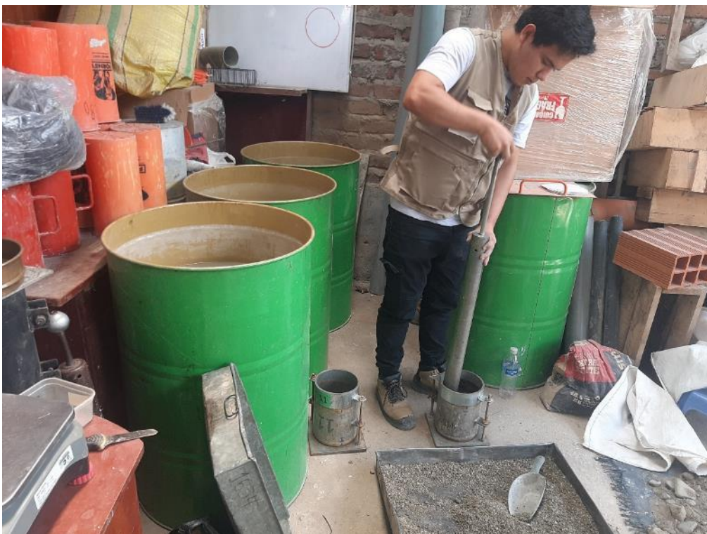
Foto 20: Compactación del suelo más adición del PET al 1.5%, CBR-Primera repetición.
