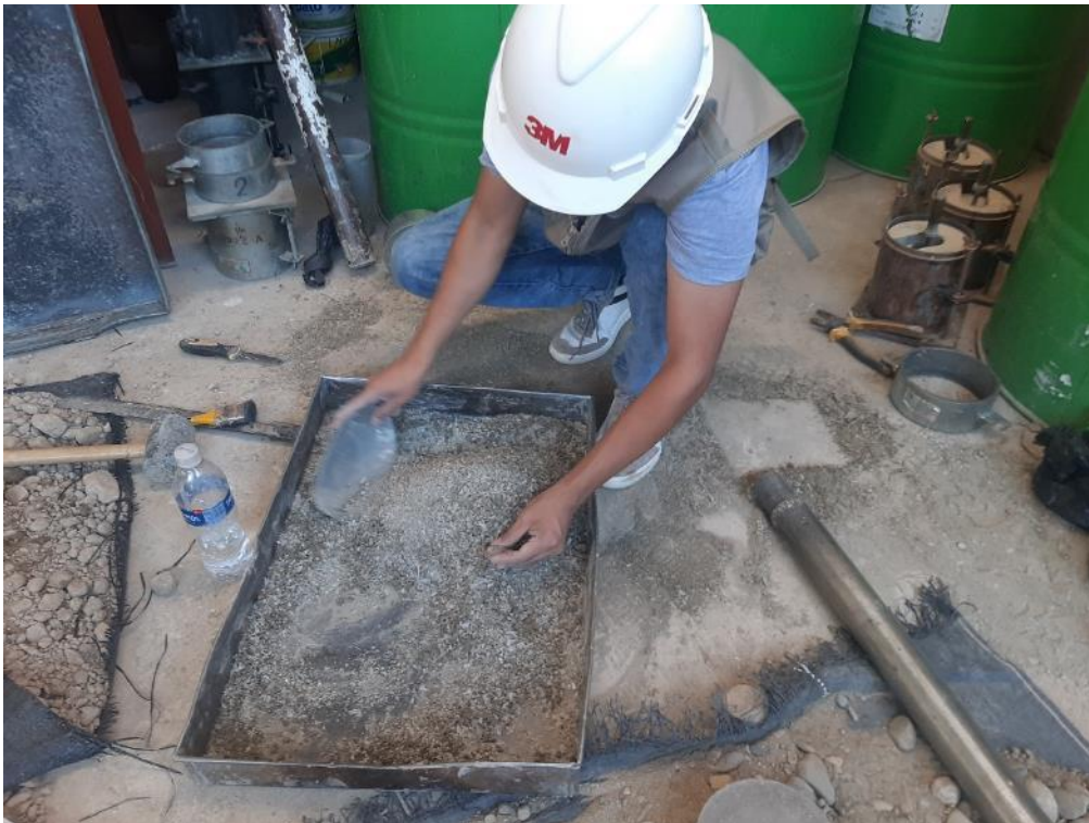
Foto 42: Humectación del suelo a fin de realizar la prueba del Proctor modificado con distintos porcentajes de PET (1.5%, 3.0% y 6.0%).
