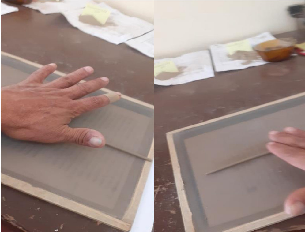
Foto 49: Ejecución del ensayo de límite plástico con distintos porcentajes de PET (1.5%, 3.0% y 6.0%).
