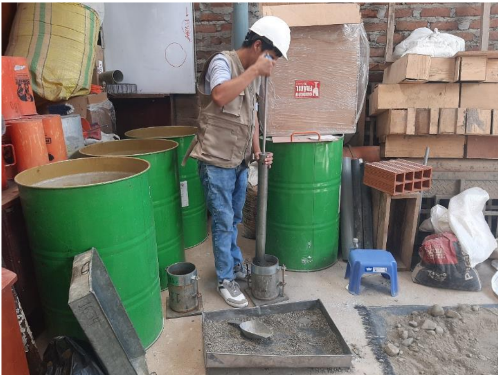
Foto 22: Compactación del suelo más PET 3.0%, CBR-Primera repetición.
