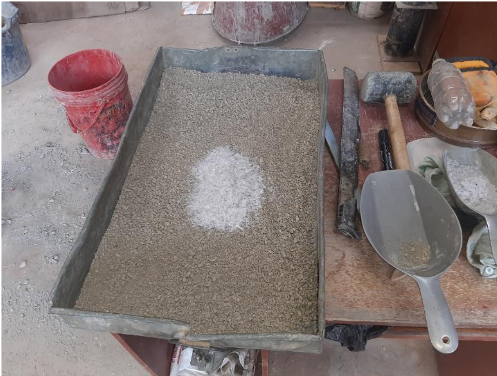
Foto 19: Mezcla del Suelo Tipo A-6 con el PET al 1.5% en relación al peso del suelo natural.
