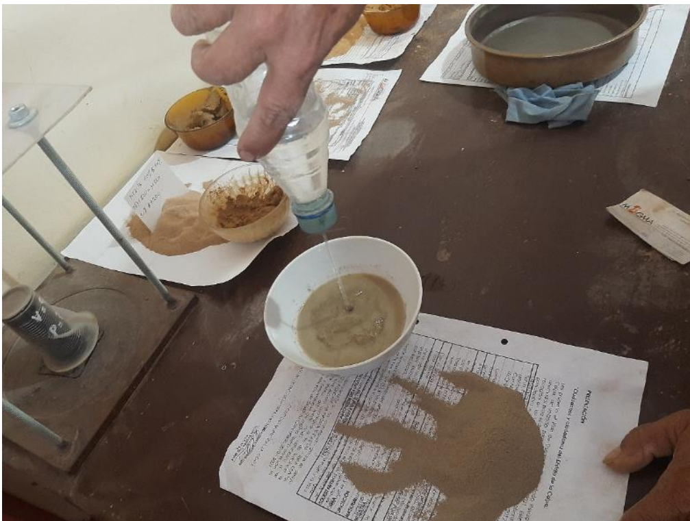
Foto 10: Preparación de muestra con el propósito de realizar la prueba de Límites de Atterberg.
