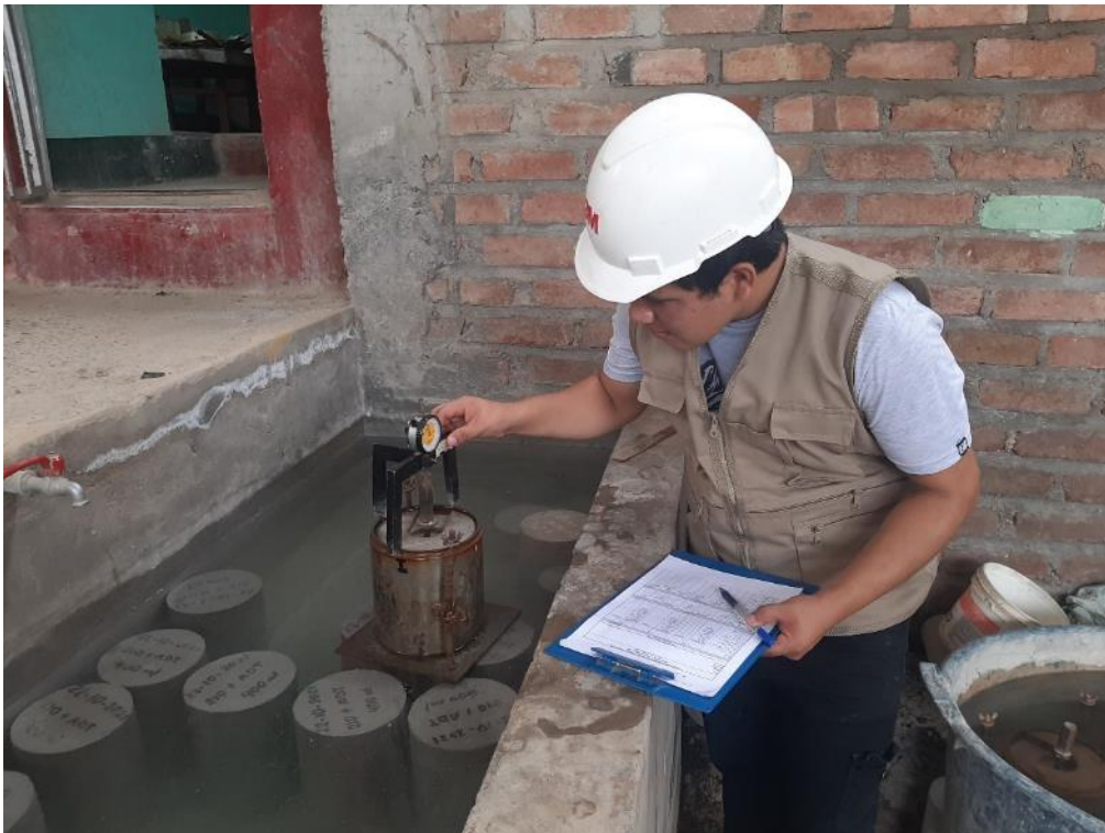
Foto 30: Lectura del dial de las muestras al 1.5%, 3.0% y 6.0%, antes de entrar a sumergirse en agua, CBR – Segunda repetición.
