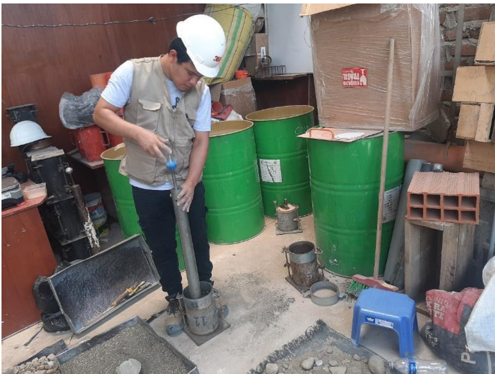
Foto 28: Compactación del suelo más PET 3.0%, CBR-Segunda repetición.
