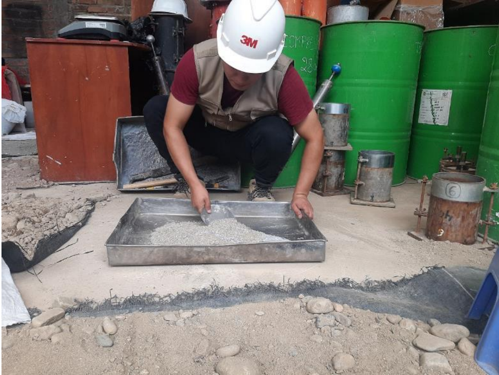
Foto 31: Mezcla del Suelo Tipo A-6 con el PET al 1.5% en relación al peso del suelo natural.
