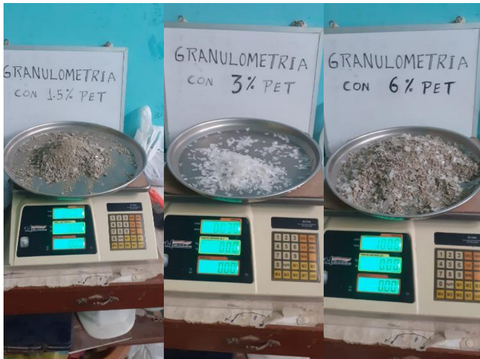
Foto 45: Peso y mezcla del suelo para realizar Granulometría con distintos porcentajes de PET (1.5%, 3.0% y 6.0%).
