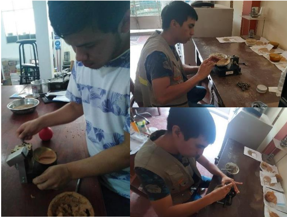
Foto 11: Utilización de la copa Casagrande a fin de efectuar la determinación del LL.
