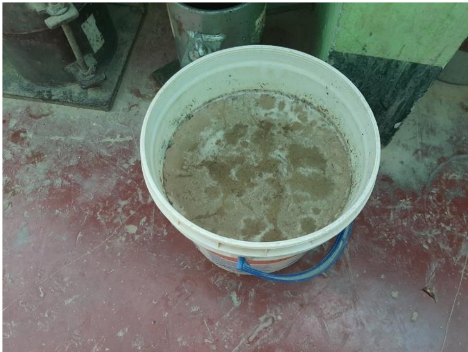
Foto 06: Muestras puesta a remojar para realizar el ensayo Granulométrico de acuerdo al manual del MTC para ensayos de materiales.
