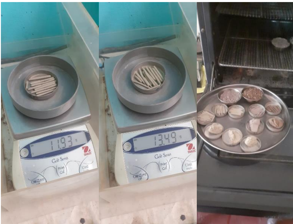
Foto 50: Ejecución del ensayo de límite plástico con distintos porcentajes de PET (1.5%, 3.0% y 6.0%).
