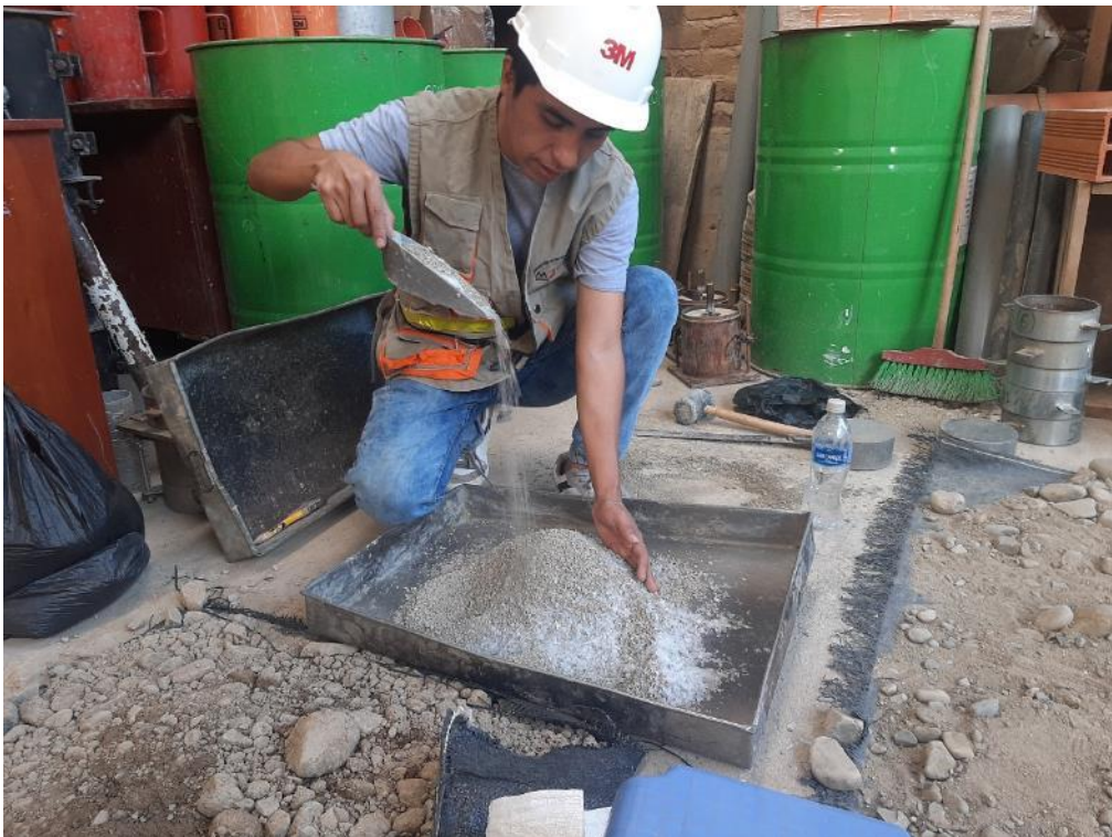
Foto 32: Humectación del suelo más PET al 1.5%, CBR - Tercera repetición.
