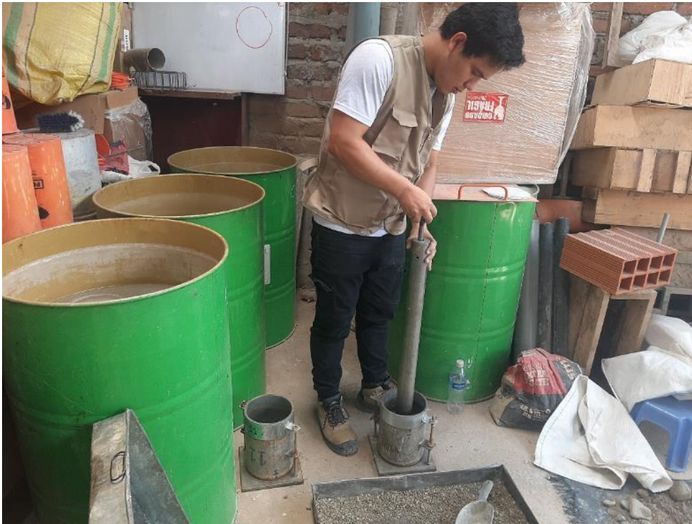
Foto 13: Compactación del espécimen en la prueba del Proctor modificado.
