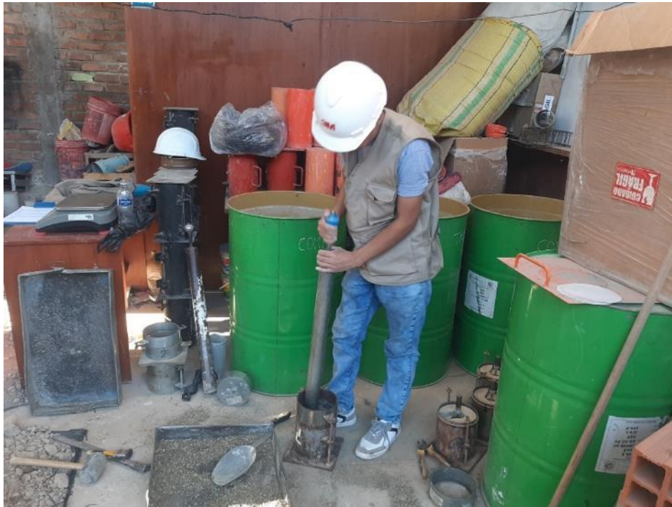
Foto 43: Ejecución de la prueba de Proctor modificado empleando distintos porcentajes de PET (1.5%, 3.0% y 6.0%).
