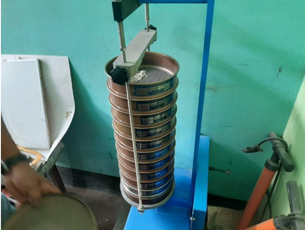
Foto 07: Muestras puesto a tamizar según el ensayo MTC E 107.
