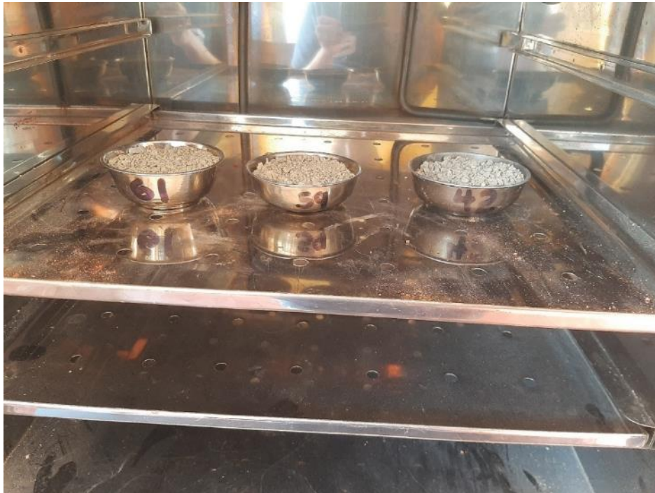
Foto 05: Muestras llevadas al horno para realizar el ensayo de humedad de acuerdo al manual del MTC para ensayos de materiales.
