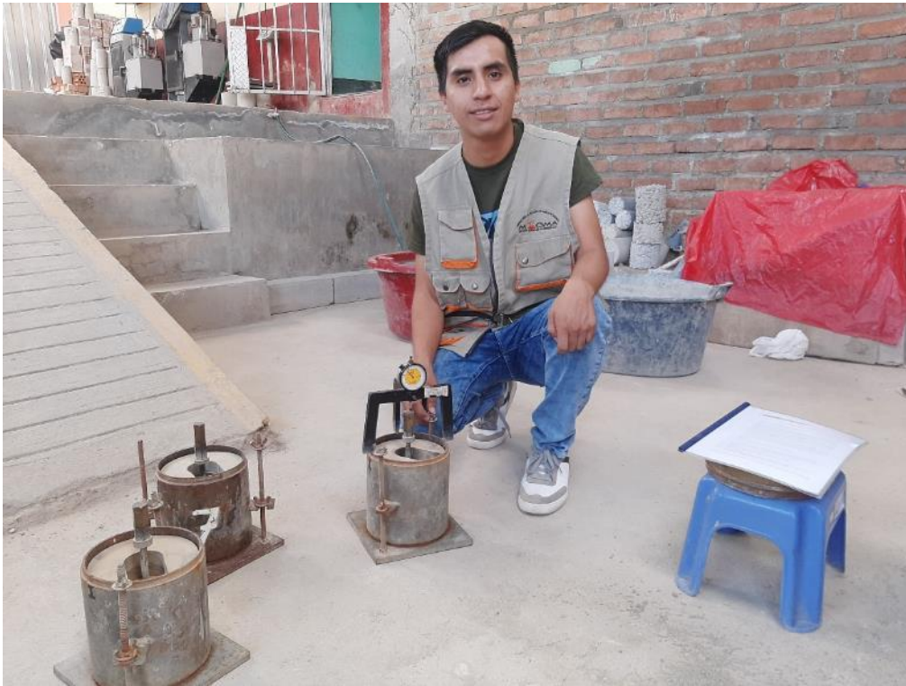
Foto 15: Lectura del dial en las muestras del CBR con suelo natural.
