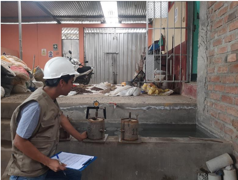
Foto 26: Lectura del dial de las muestras al 1.5%, 3.0% y 6.0%, antes de entrar a sumergirse en agua, CBR – Primera repetición.
