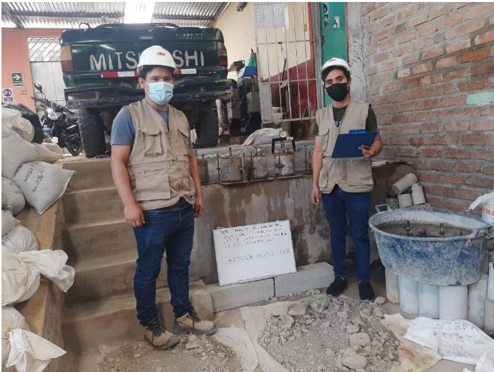
Foto 38: Control diario de toma de lectura del dial, de las muestras sumergidas, con 1.5%, 3.0% y 6.0% de PET.
