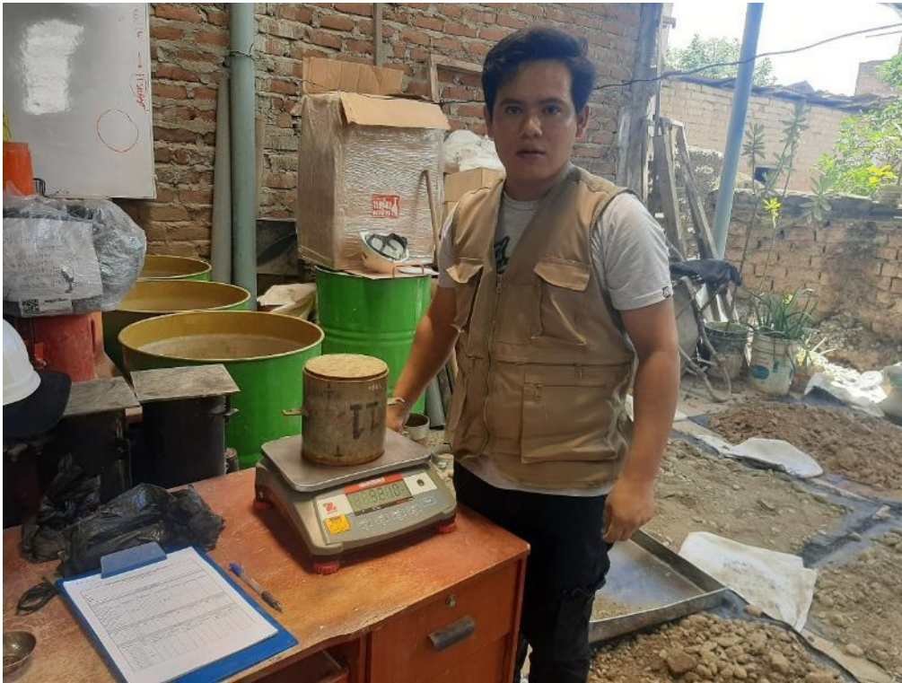
Foto 25: Peso de las muestras compactadas, para la determinación del CBR – Primera repetición.
