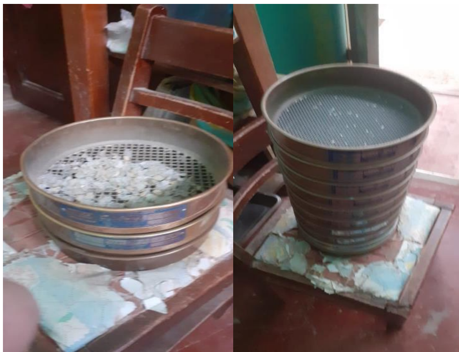
Foto 46: Ejecución del ensayo de granulometría con distintos porcentajes de PET (1.5%, 3.0% y 6.0%).
