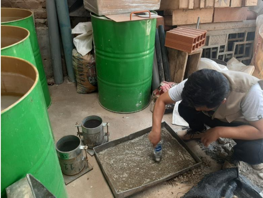
Foto 21: Humectación del suelo más PET al 3.0%, CBR-Primera repetición.
