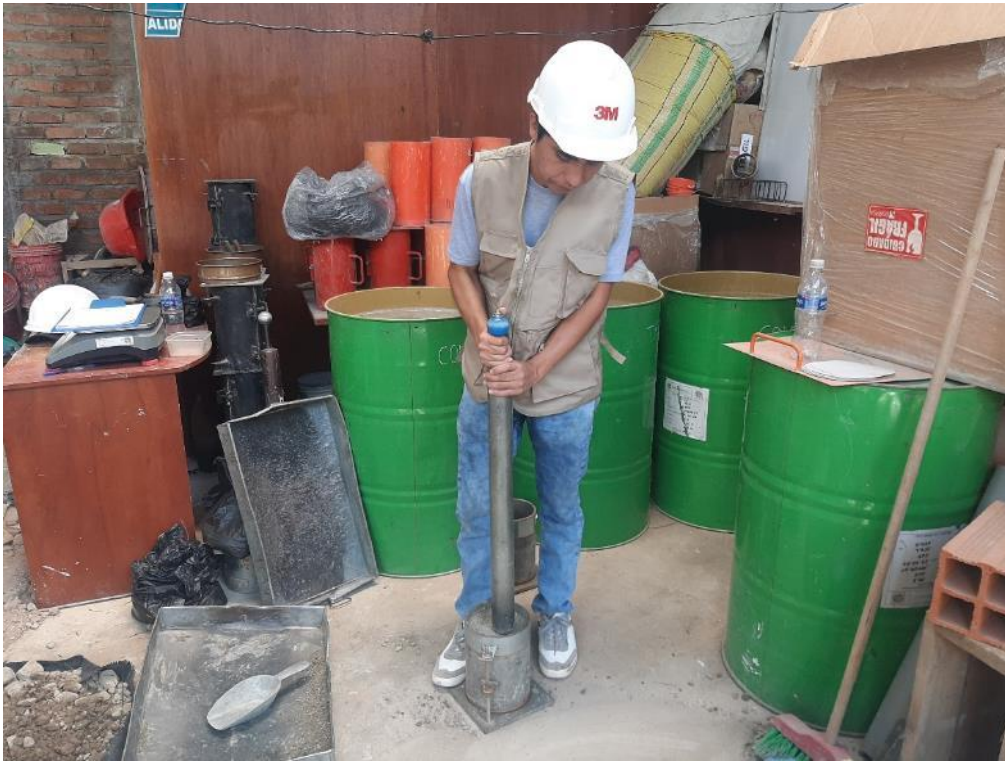
Foto 27: Compactación del suelo más PET 1.5%, CBR-Segunda repetición.
