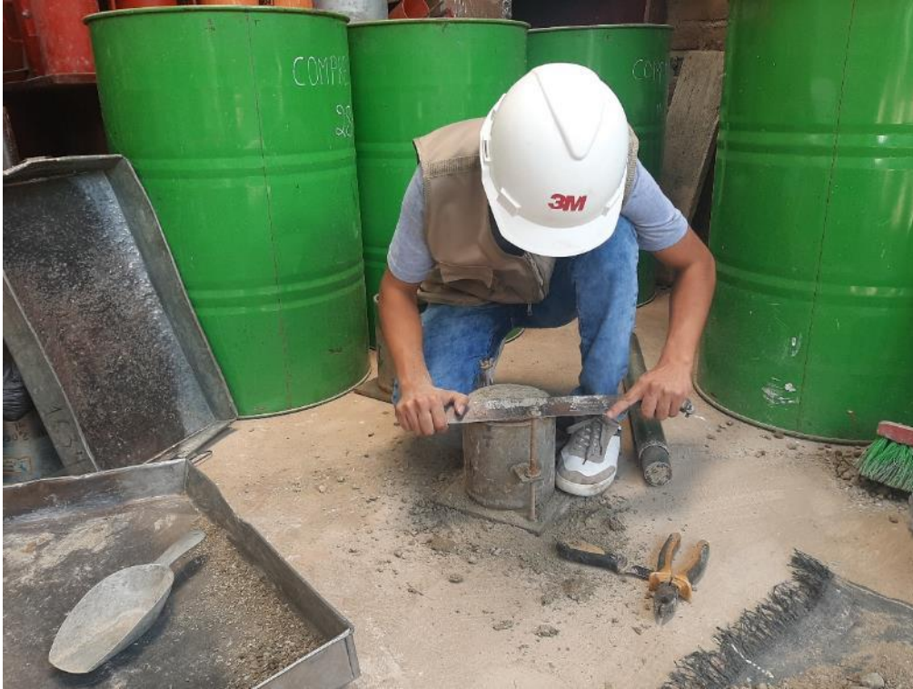
Foto 29: Enrasamiento de la muestra del suelo A-6 más PET 6.0%, CBR-Segunda repetición.
