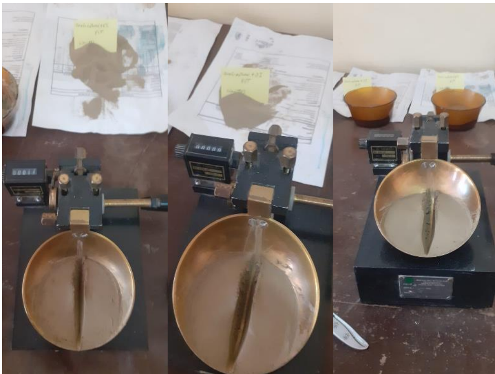
Foto 48: Ejecución del ensayo de LL con distintos porcentajes de PET (1.5%, 3.0% y 6.0%).
