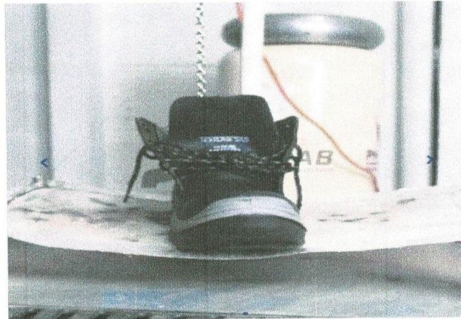
*Nota.* La figura muestra el ensayo dieléctrico que se realiza a los zapatos. Tomado de *Ensayo de bota con suela aislada - Calzado de seguridad eléctrica*, Testlab, 2023.
