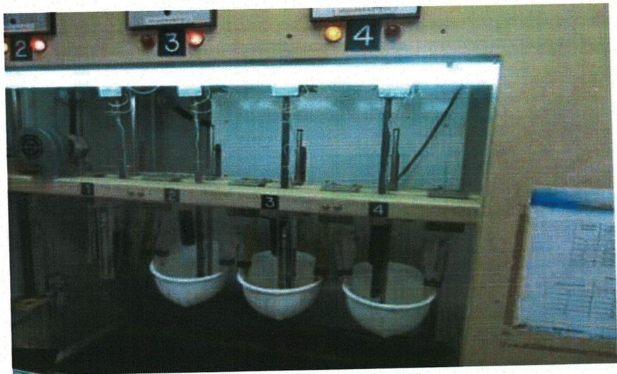
*Nota.* En la figura representa el ensayo dieléctrico que se realizan a los cascos de protección personal. Tomado de *Diseño de laboratorio para pruebas de aislamiento eléctrico a equipos de protección personal para garantizar los trabajos según norma ISO/ IEC 17025:2006 Chiclayo*, por Purizaca, J.,2019, Repositorio Universidad César Vallejo.
