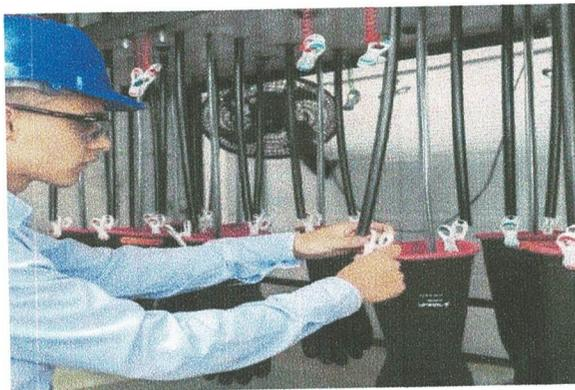
Nota. La figura muestra cómo se realiza una de las pruebas dieléctricas en los guantes. Tomado de *Ensayo dieléctrico guante dieléctrico CL 00 2*, SSP Industrial, 2023.
