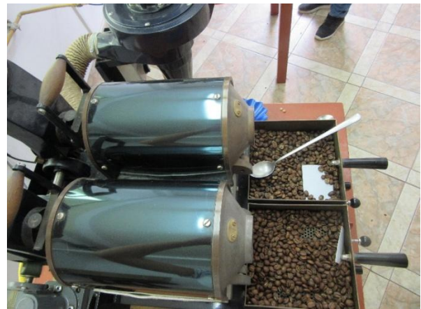
Figura 24. Proceso de enfriado
