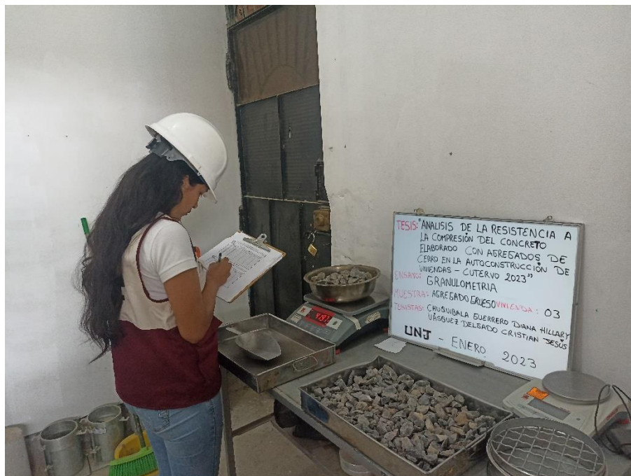
Fotografía 5 Ensayo del análisis granulométrico del agregado grueso.
