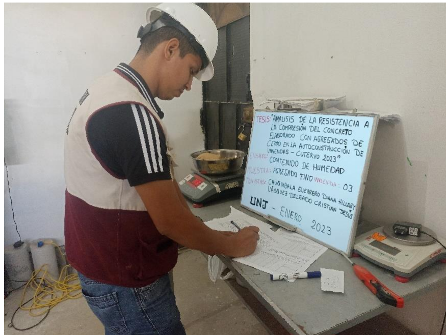
Fotografía 9 Ensayo del contenido de humedad del agregado fino.
