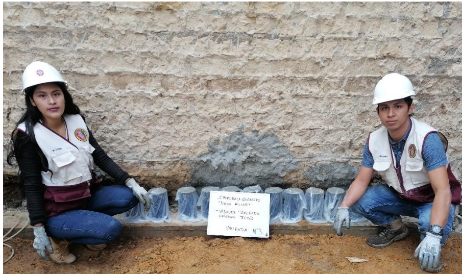
Fotografía 15 Elaboración de probetas cilíndricas de concreto en cada vivienda.
