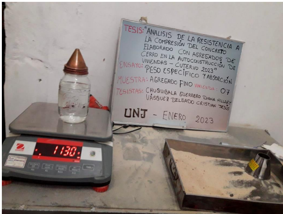
Fotografía 11 Ensayo del peso específico y absorción para el agregado fino.
