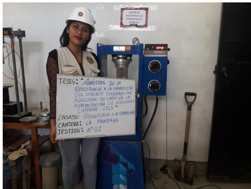
Fotografía 18 Rotura de concreto del diseño de mezcla a los 28 y 42 días de curado
