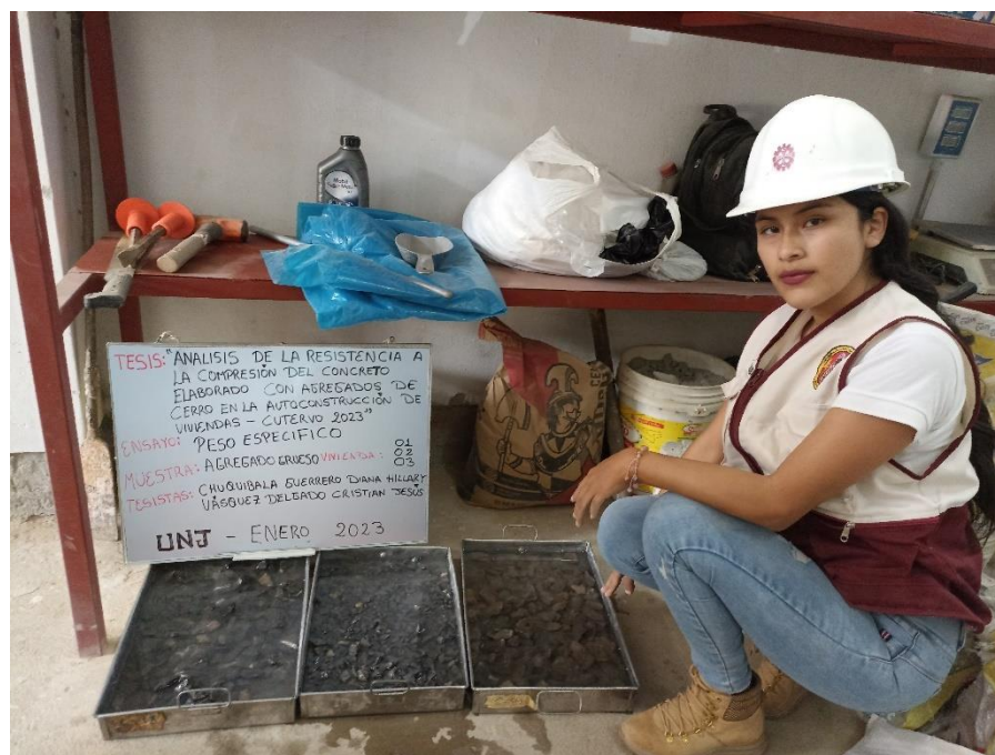
Fotografía 10 Ensayo del peso específico y absorción para el agregado grueso.
