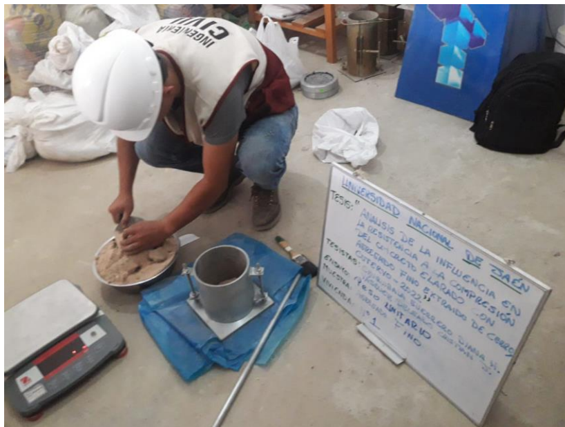
Fotografía 7 Ensayo del peso unitario suelto para el agregado fino y grueso.
