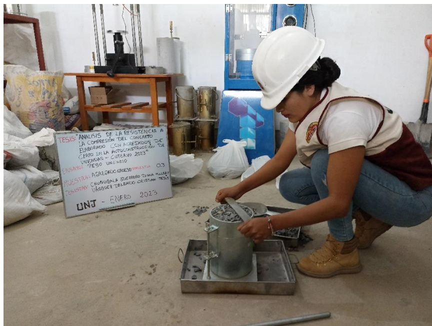
Fotografía 8 Ensayo del peso unitario compactado para el agregado fino y grueso.
