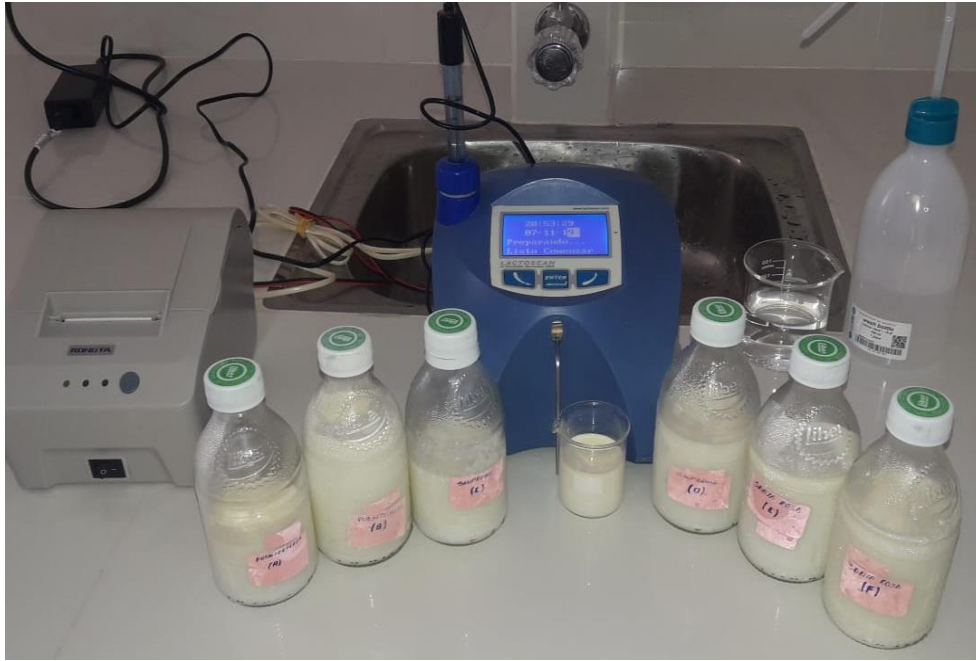
Figura 22 Muestras de leche de vaca del distrito de Santa Rosa para ser analizadas en el equipo Lctoscan (analizador de leches)
