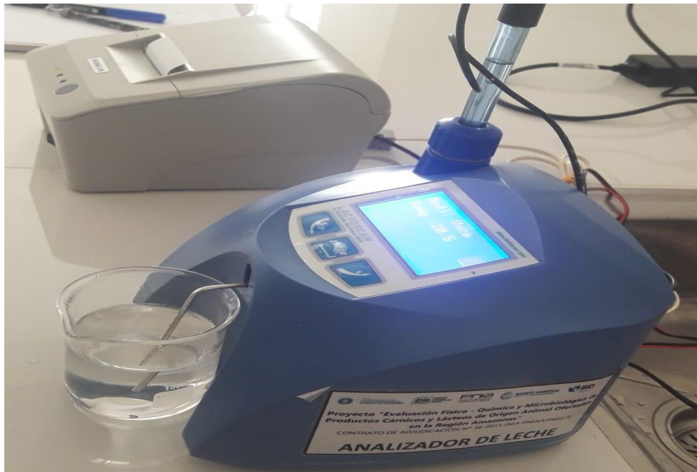
Figura 20 Encendido y calibración del equipo Lactoscan SL 60
