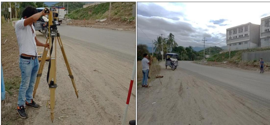
*Nota.* En la figura 38, se muestra la medición de la altura del instrumento, el cual es un paso que se realiza antes de empezar a visar los puntos que se quiere obtener sus coordenadas y altura; además, se presenta la visación de un punto a la altura del campus universitario de la UNJ.
