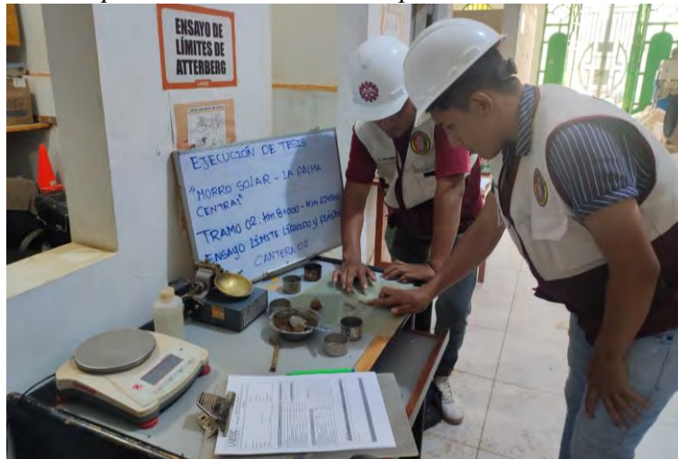
Ensayo de laboratorio para determinar el límite plástico
