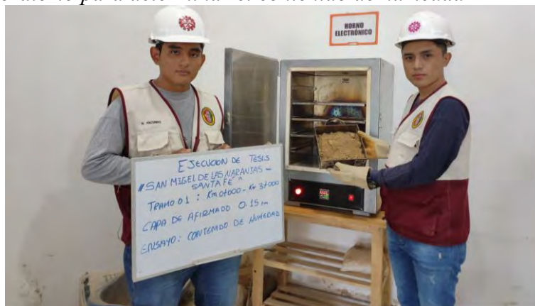
Ensayo de laboratorio para determinar el contenido de humedad
