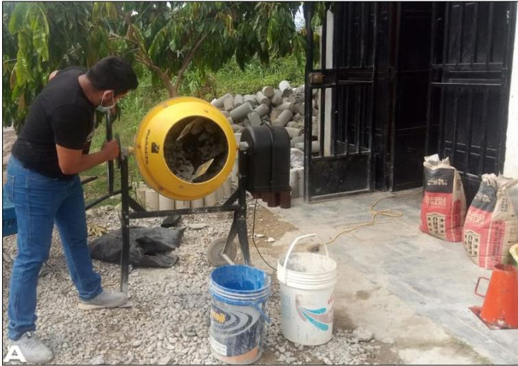
*Nota:* En la figura 5, se observa el mezclado de los materiales dentro de la mezcladora de laboratorio, para la realización de este ensayo se utilizó los equipos e instrumentos, además de seguir los procedimientos establecidos por la NTP 339.033.
