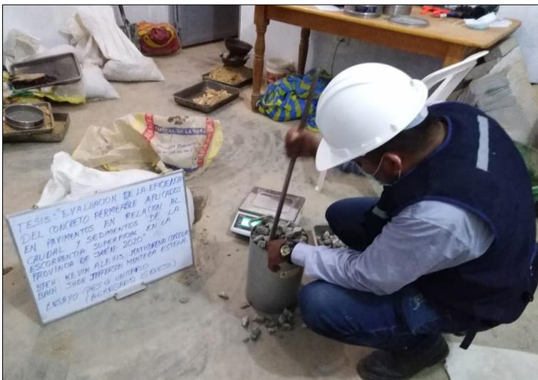
*Nota:* En la figura 3, se observa la compactación del agregado grueso, para dicho ensayo se utilizó los equipos e instrumentos, además de seguir los pasos establecidos por la NTP 400.017.
