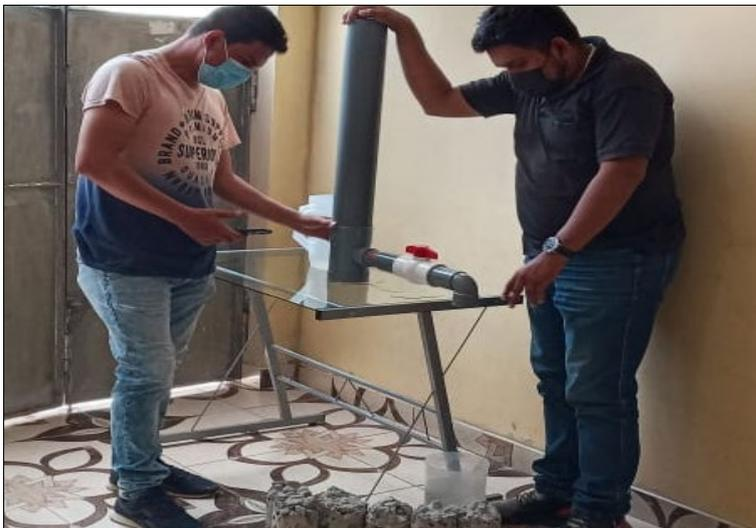
*Nota:* En la figura 9, se muestra el proceso de medición del agua que pasa en un tiempo determinado, este proceso se realizó para determinar la permeabilidad del concreto, el procedimiento consistió en colocar el testigo de concreto el permeámetro elaborado con tubo de 4 pulgadas, para luego añadir agua, abrir la válvula para medir la cantidad de agua que cae en un recipiente milimetrado en un determinado tiempo.
