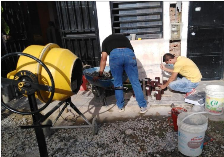
*Nota:* En la figura 8, se observa el procedimiento para elaborar los de testigos de dimensiones de 10cm de diámetro y 20cm de altura, estos testigos se han elaborado con la finalidad de poder medir la permeabilidad de los diferentes tipos de concreto elaborados.
