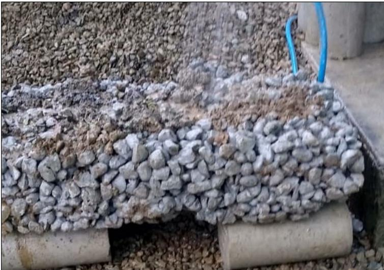
*Nota:* En la figura 13, se presenta el proceso de simulación de las precipitaciones pluviales para medir la permeabilidad de los modelos elaborados, se observan los sedimentos sobre el concreto permeable, el cual se encuentra brevemente inclinado para simular la pendiente de la calle a cuál corresponde.
