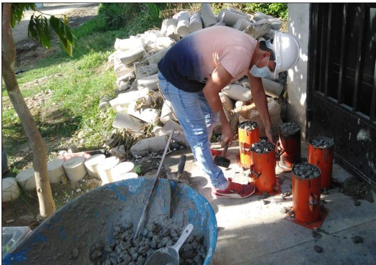
*Nota:* En la figura 6, se observa el proceso golpeado con el martillo de goma de los moldes con concreto, el procedimiento consistió en llenar de concreto los moldes en tres capas iguales y por cada capa realizar un total de 12 golpes en cuatro lados del molde y siguiendo con las demás indicaciones de la NTP 339.033.
