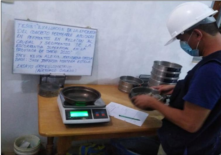
*Nota:* En la figura 2, se observa el tamizado del agregado grueso, como parte del ensayo de análisis granulométrico para dicho ensayo se utilizó los equipos e instrumentos, además de seguir los pasos establecidos por la NTP 400.012.
