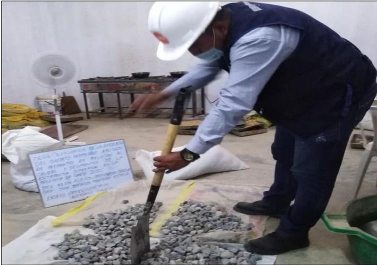
*Nota:* En la figura 2, se observa el proceso de cuarteo de agregado grueso para reducir la muestra a tamaño de ensayo en laboratorio, para ello se han utilizado los equipos y herramientas, además de seguir los pasos de la NTP 400.010.
