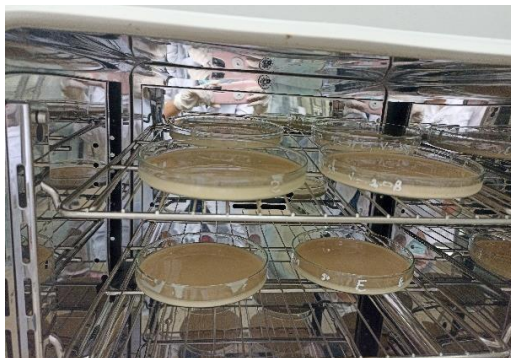
Figura 18: Almidón en la estufa a 60 °C por 20 h.
