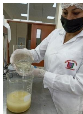
Figura 27: Blanqueamiento de fibra de celulosa con agitación magnética por 20 min.
