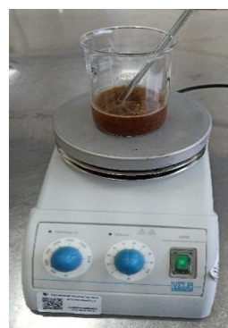
Figura 25: Extracción de celulosa de cascarilla a 60 °C por 4 h.
