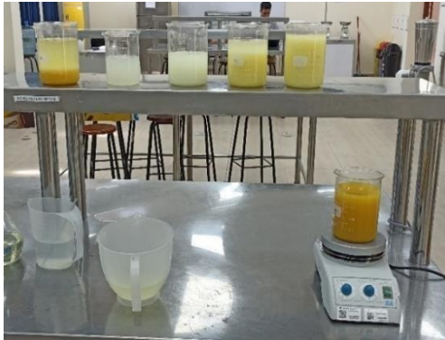
Figura 28: Adición de hipoclorito de sodio para blanqueamiento de la fibra de celulosa.
