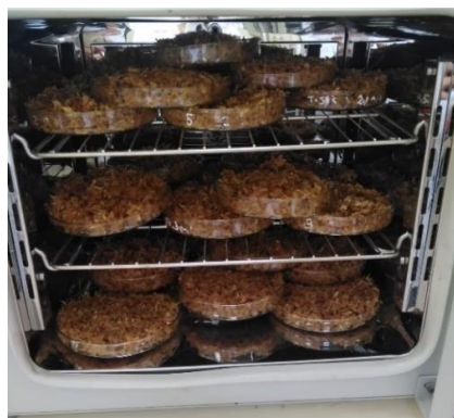
Figura 24: Secado de la cascarilla en la estufa a 65 °C por 24 h.
