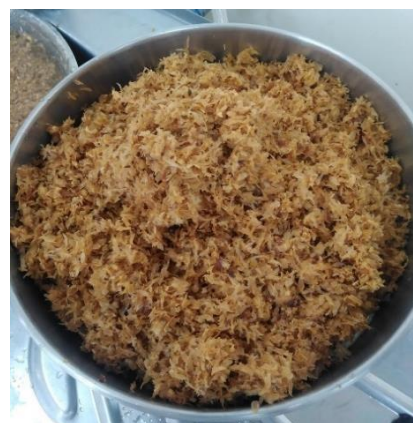
Figura 25: Extracción de celulosa de cascarilla a 60 °C por 4 h.
